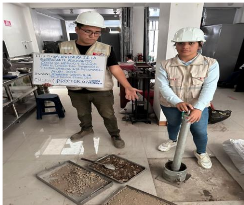
Foto 15: Ensayo proctor modificado
