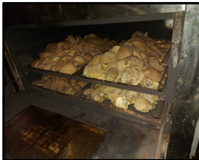
Figura 10. Incineración del scallop por combustión
