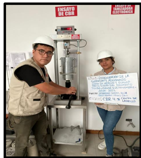
Figura 39. Ensayo CBR 4% CL
