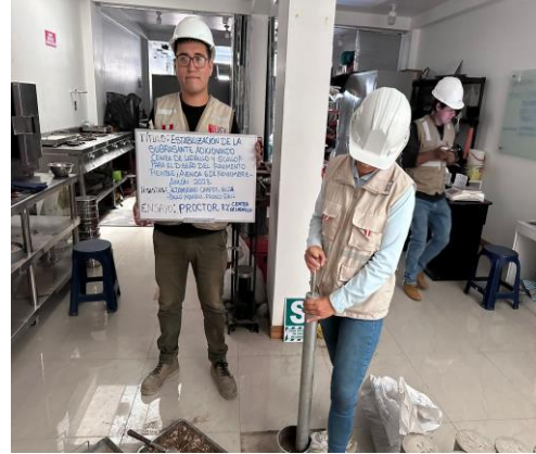
Foto 14: Ensayo proctor modificado
