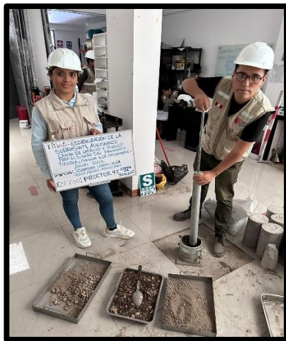
Figura 32. Ensayo Proctor 4% CS
