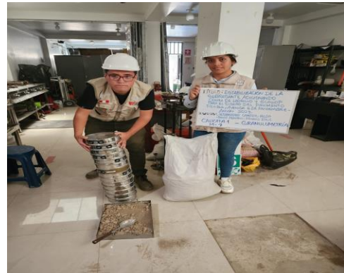
Foto 8: Ensayo granulométrico C01-M01
