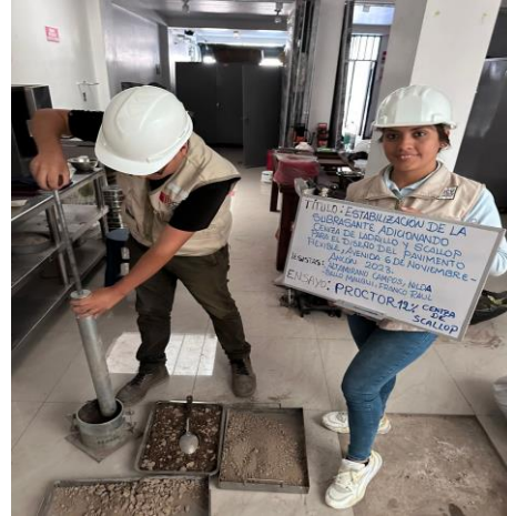
Foto 17: Ensayo proctor modificado 12% de ceniza de scallop
