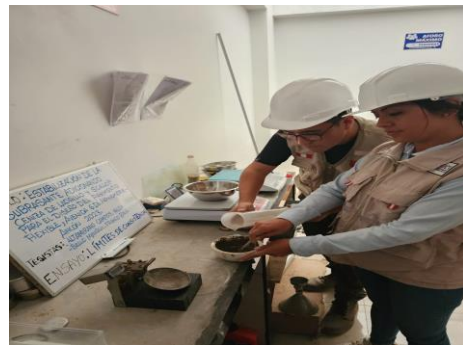
Foto 12: Ensayo de límites consistencia
