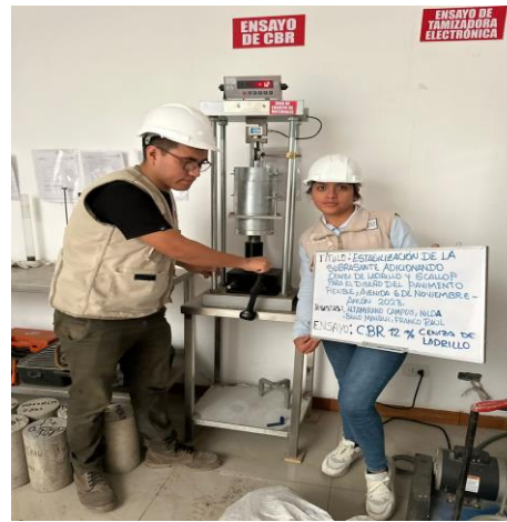
Foto 19: CBR 12% de ceniza de ladrillo
