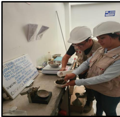
Figura 23. Ensayo de Límite líquido Figura 24. División de masa con acanalador
