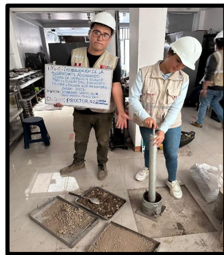
Figura 33. Ensayo Proctor 12% CL
