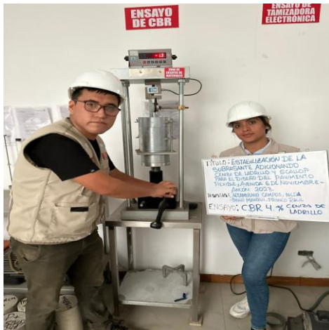
Foto 18: CBR 4% de ceniza de ladrillo
