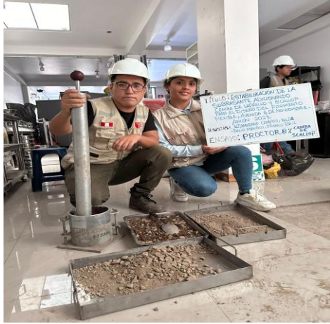
Foto 16: Ensayo proctor modificado 8% de ceniza de scallop
