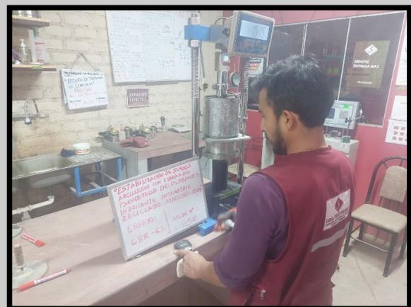
**Imagen 5.6: Ensayo de CBR, penetración (C-2)**
