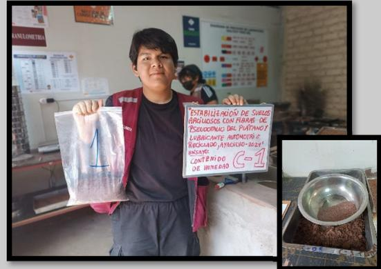
**Imagen 4.4: Ensayo para la determinación del CH (C-1)**
