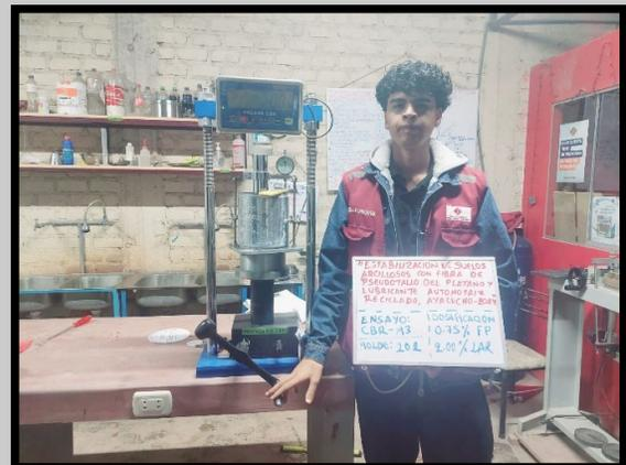
**Imagen 9.6: : Ensayo de CBR, penetración (M3)**
