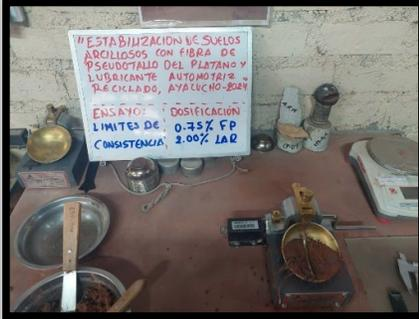
**Imagen 9.1: Ensayos de los limites de consistencia (M3)**
