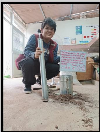
**Imagen 4.5: Ensayo de CBR, preparación de la muestra (C-1)**
