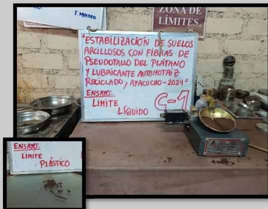
**Imagen 4.3: Ensayos de los límites de consistencia (C-1)**
