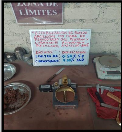
**Imagen 8.1: Ensayos de los límites de consistencia (M2)**
