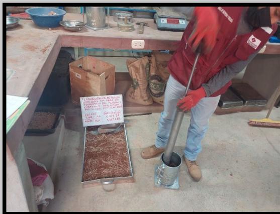
**Imagen 8.5: Ensayo de CBR, preparación de la muestra (M2)**
