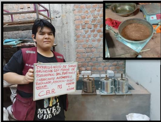
**Imagen 7.5: Ensayo de CBR, preparación de la muestra (M1)**
