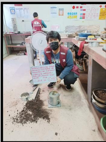
**Imagen 5.5: Ensayo de CBR, preparación de la muestra (C-2)**
