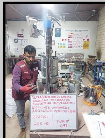
**Imagen 4.6: : Ensayo de CBR, penetración (C-1)**
