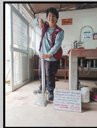
**Imagen 5.4: Proctor Modificado de la muestra (C-2)**
