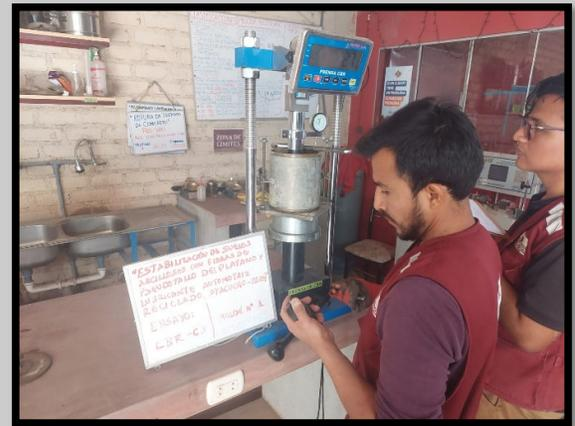
**Imagen 8.6: Ensayo de CBR, penetración (M2)**
