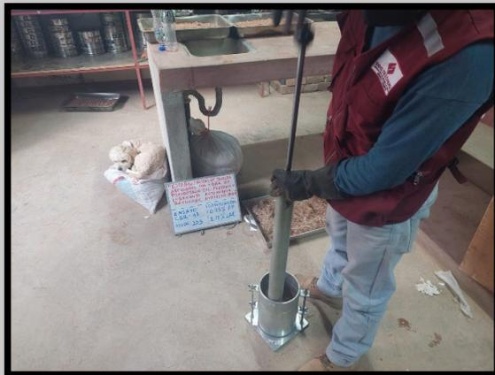
**Imagen 9.5: Ensayo de CBR, preparación de la muestra (M3)**
