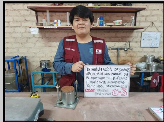
**Imagen 7.4: Proctor Modificado de la muestra (C-3)**
