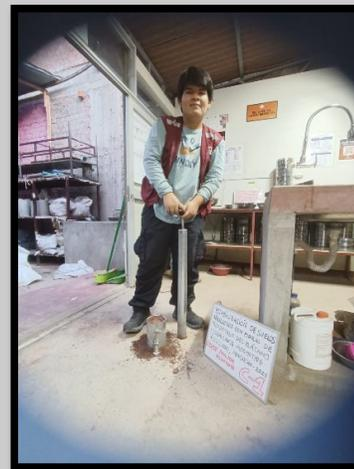
**Imagen 4.4: Proctor Modificado de la muestra (C-1)**
