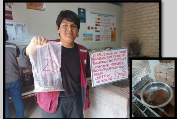
**Imagen 4.5: Ensayo para la determinación del CH (C-2)**
