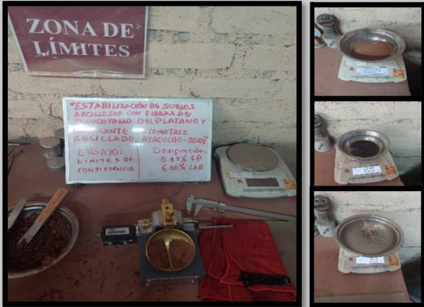
**Imagen 7.1: Ensayos de los límites de consistencia (M1)**
