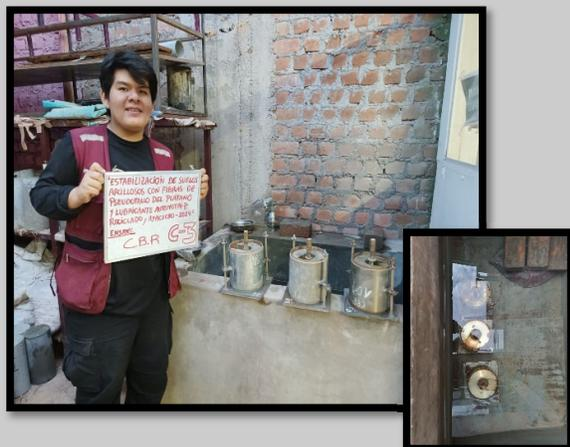
**Imagen 7.5: Ensayo de CBR, preparación de la muestra (C-3)**
