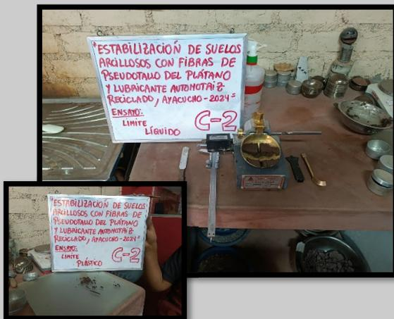
**Imagen 5.3: Ensayos de los limites de consistencia (C-2)**
