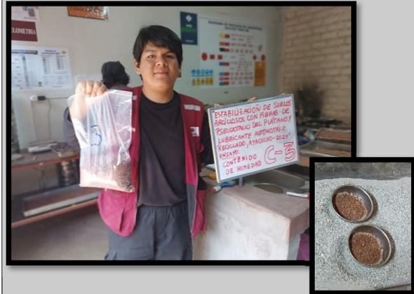
**Imagen 7.6: Ensayo para la determinación del CH (C-3)**
