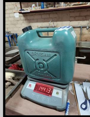
**Imagen 2.2: Control del peso de la muestra extraída de LAR.**
