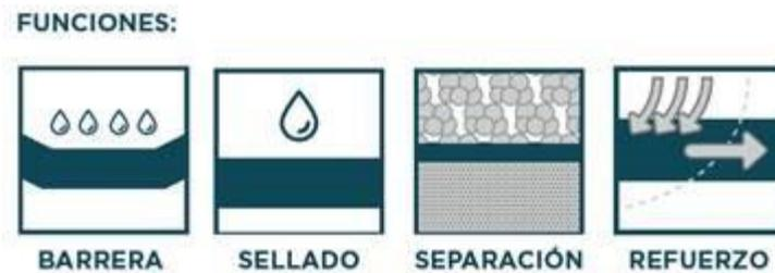
*Figura 11.* Funciones del geotextil.
