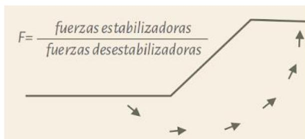
Figura 1. Factor de seguridad
