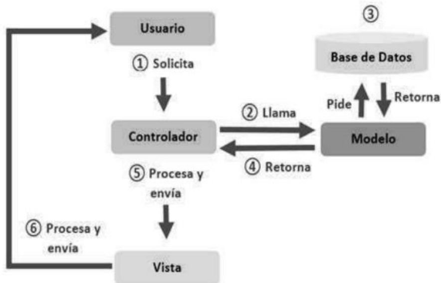
Figura 6 Funcionamiento de modelo vista controlador
