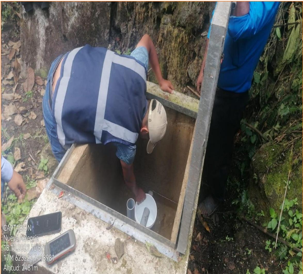
*Figura 12: Medición del caudal de captación.*
