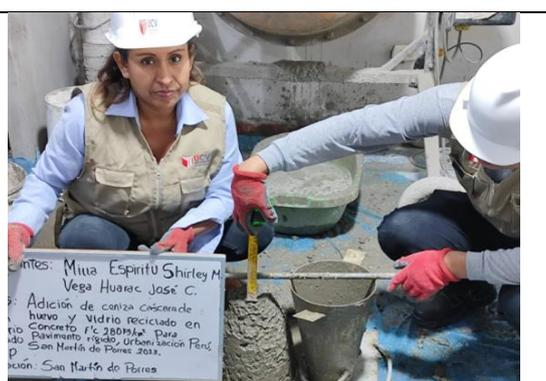
**Figura 29.** Ensayo de Slump con la adición de VR
