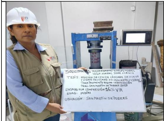
Figura 55: Ensayo de resistencia a la compresión con la adición 16% VR a los 14 días
