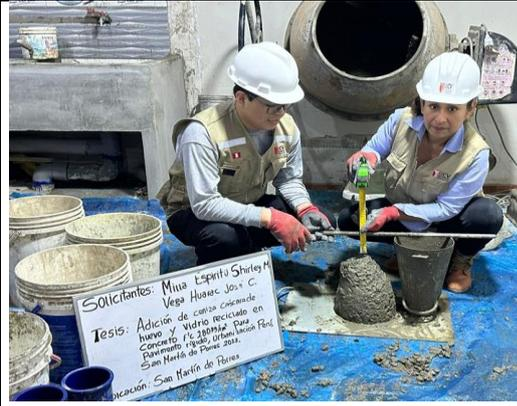
Foto 19: Ensayo de slump diseño patrón
