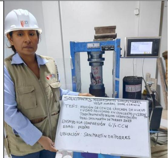
Figura 50: Ensayo de resistencia a la compresión con la adición 6% CCH a los 14 días
