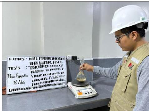
Foto 18: Ensayo de peso específico
