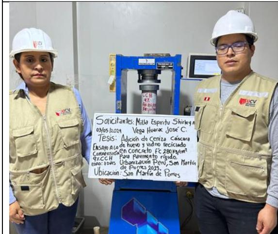
Figura 33: Ensayo de resistencia a la compresión con la adición 9% CCH a los 7 días
