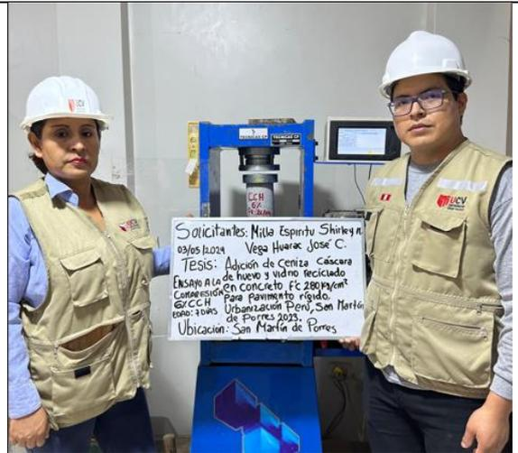
Figura 32: Ensayo de resistencia a la compresión con la adición 6% CCH a los 7 días
