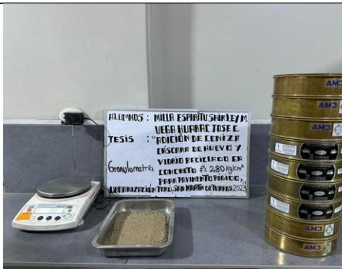
Foto 11: Agregado para ensayo de granulometría
