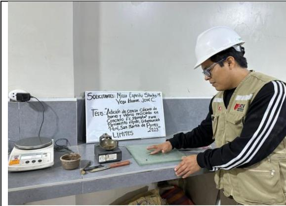
Figura 63: Ensayo de límites
