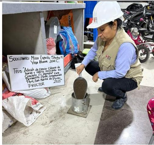
Figura 65: Ensayo de Proctor estándar
