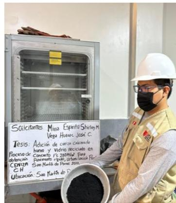
**Figura 12.** Obtención de carboncillo de las cáscaras de huevo hasta 500°C
