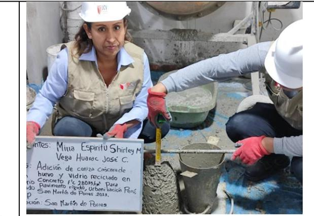
Figura 24: Ensayo de slump adición de 11% VR
