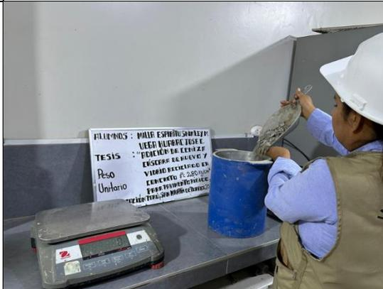
Foto 10: Ensayo de peso unitario de agregado grueso
