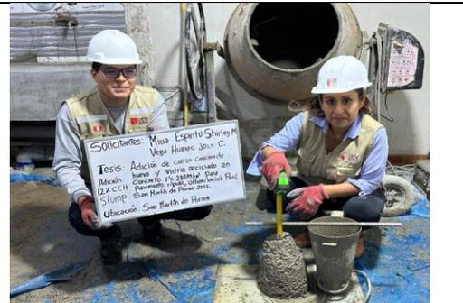
Foto 22: Ensayo de slump adición de 12% CCH
