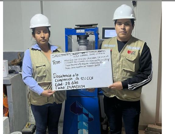
Figura 70: Ensayo de resistencia a la compresión con la adición 12% CCH a los 28 días
