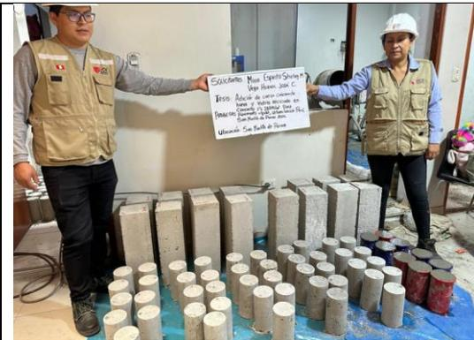
Foto 27: Cantidad de probetas cilíndricas
