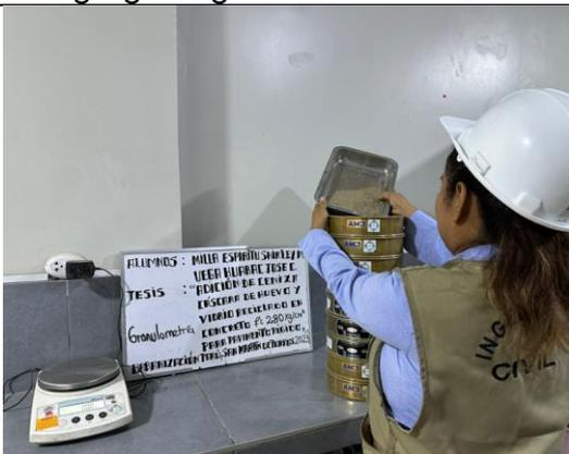
Foto 12: Ensayo de granulometría de agregado fino
