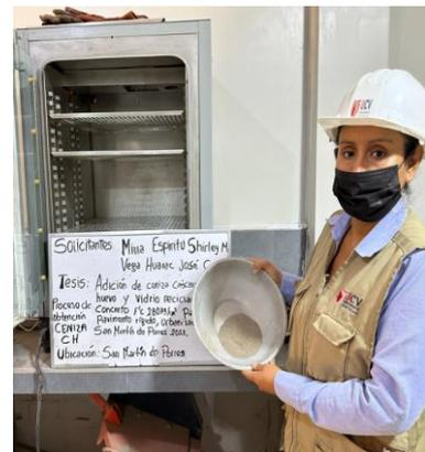
**Figura 13.** Pulverización de las cáscaras de huevo hasta 800°C (CCH)
