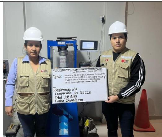
Figura 68: Ensayo de resistencia a la compresión con la adición 6% CCH a los 28 días
