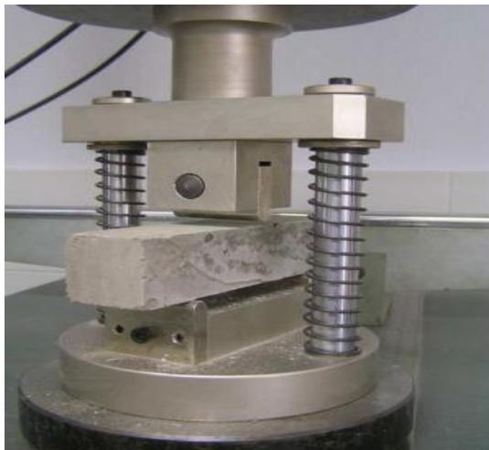
*Figura 7.* Dispositivo de ensayo a flexión
