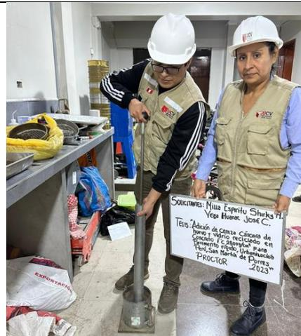
Figura 66: Ensayo de Proctor estándar
