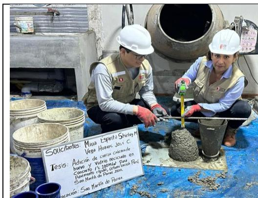
Figura 25. Ensayo de slump diseño patrón
