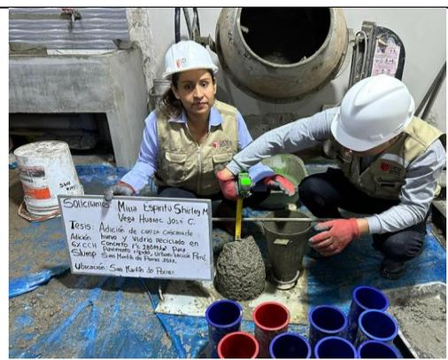
Figura 26. Ensayo de slump con la adición CCH
