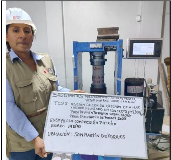
Figura 53: Ensayo de resistencia a la compresión patrón a los a los 14 días
