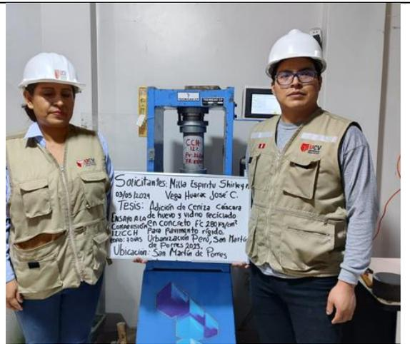
Figura 34: Ensayo de resistencia a la compresión con la adición 12% CCH a los 7 días
