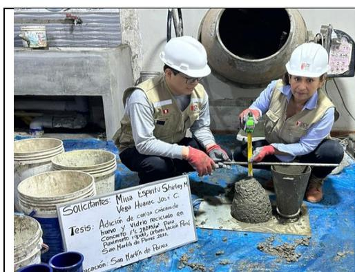
**Figura 28.** Ensayo de Slump diseño patrón
