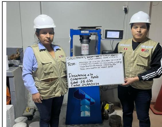
Figura 67: Ensayo de resistencia a la compresión de patrón a los 28 días
