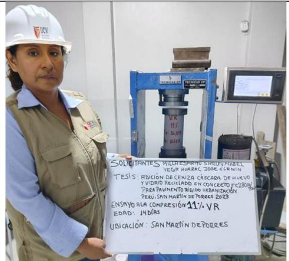
Figura 54: Ensayo de resistencia a la compresión con la adición 11% VR a los 14 días
