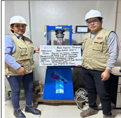
Figura 31: Ensayo de resistencia a la compresión de patrón a los 7 días
