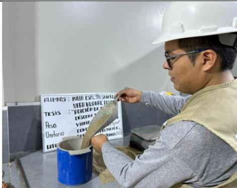
Foto 9: Ensayo de peso unitario de agregado fino
