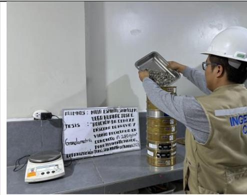
Foto 13: Ensayo de granulometría de agregado grueso de huso 67
