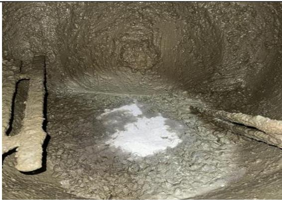
Foto 29. Diseño de mezcla con adición de 6% CCH
