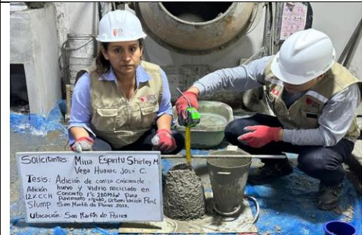
Foto 21: Ensayo de slump adición de 9% CCH
