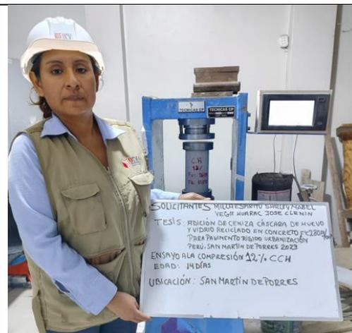
Figura 52: Ensayo de resistencia a la compresión con la adición 12% CCH a los 14 días
