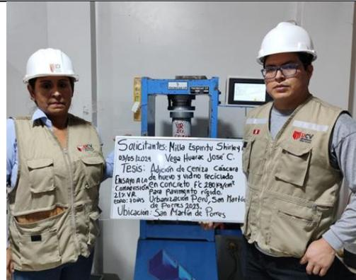
Figura 38: Ensayo de resistencia a la compresión con la adición 21% VR a los 7 días
