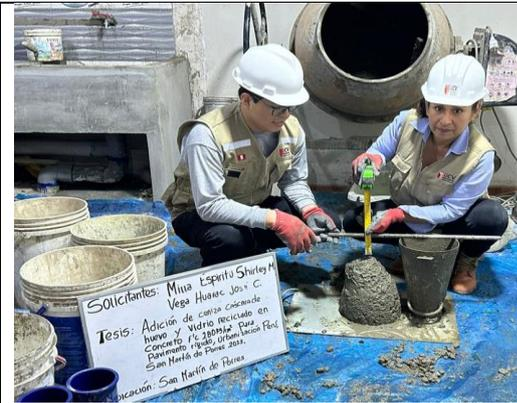
Figura 23: Ensayo de slump mezcla de patrón
