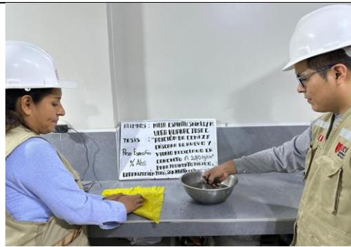
Foto 16: Secado de agregado de grueso
