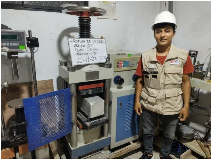
Figura 41: Rotura de viga con el 5% de aditivo-muestra 3
