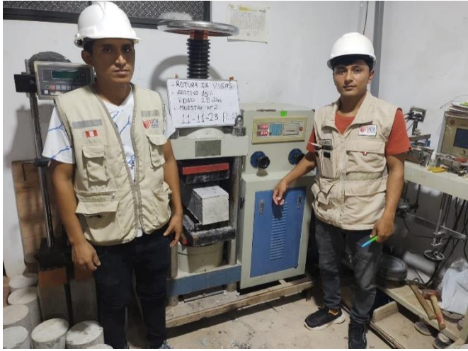
Figura 39: Rotura de viga con el 15% de aditivo
