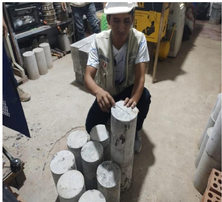
Figura 34: Roturas de probetas con el 15% de aditivo
