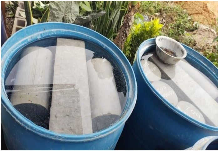
Figura 27: tiempo de curado de vigas y probetas
