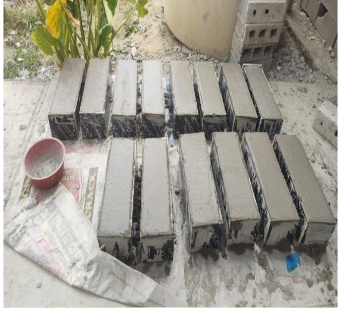
Figura 24: viguetas convencionales y con aditivo
