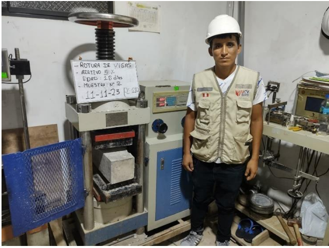
Figura 40: Rotura de viga con el 15% de aditivo
