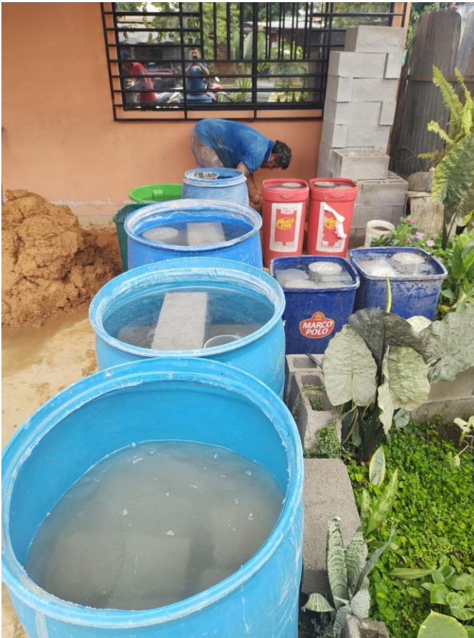
Figura 29: tiempo de curado del concreto a los 28 días
