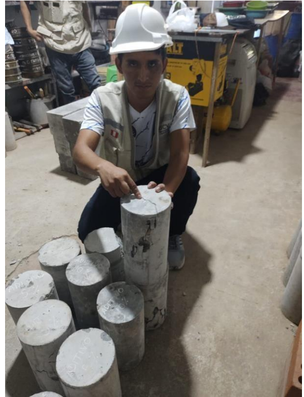
Figura 32: Roturas de probetas con el 5% de aditivo
