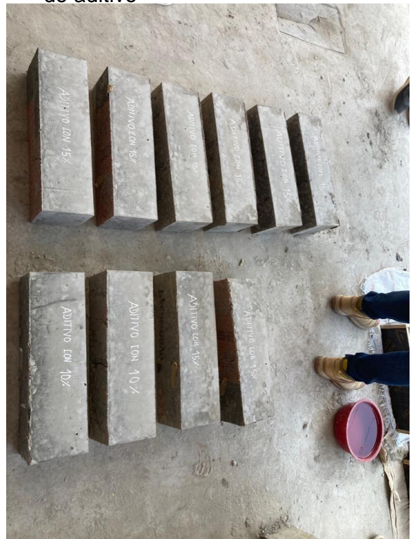
Figura 14: vigas con el 10%-15% de aditivo
