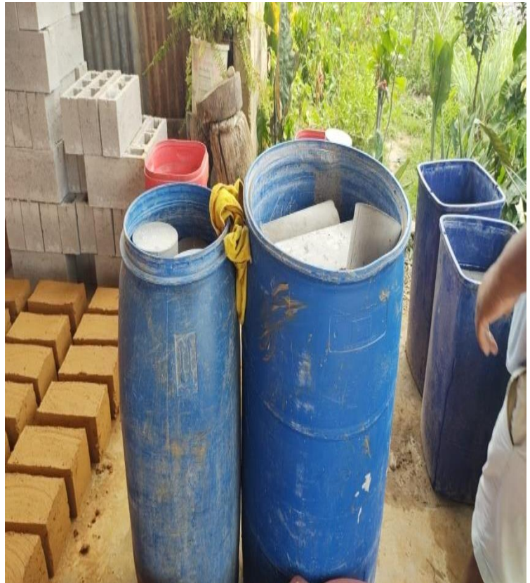
Figura 26: tiempo de curado del concreto a los 7 días
