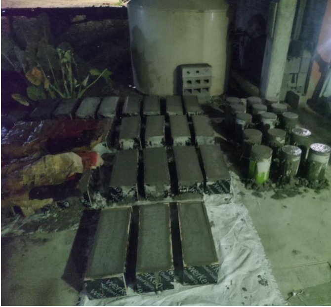
Figura 23: viguetas y probetas semi terminadas
