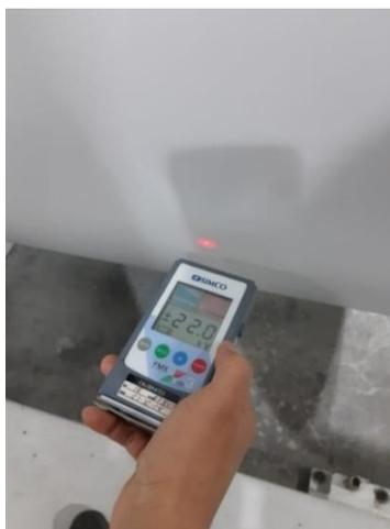
*Figura 39.* Mediciones de estática en laminas pet
