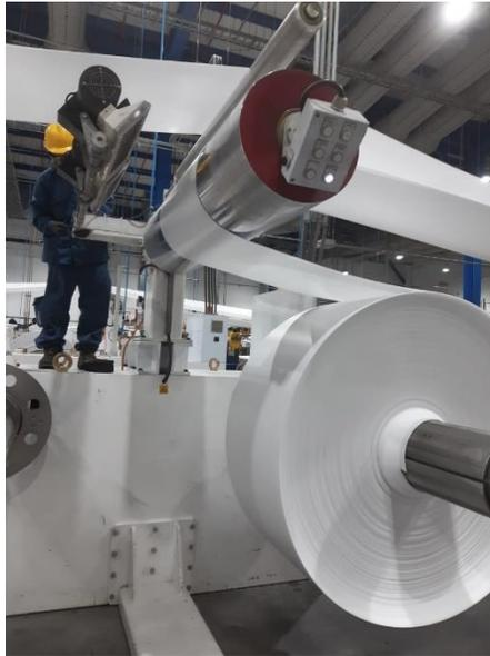
*Figura 38.* Disipador de estática instalado en área de bobinado de lamina
