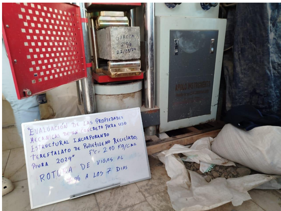
Figura 9: vigas para prueba de resistencia a la flexión a 7 días.
