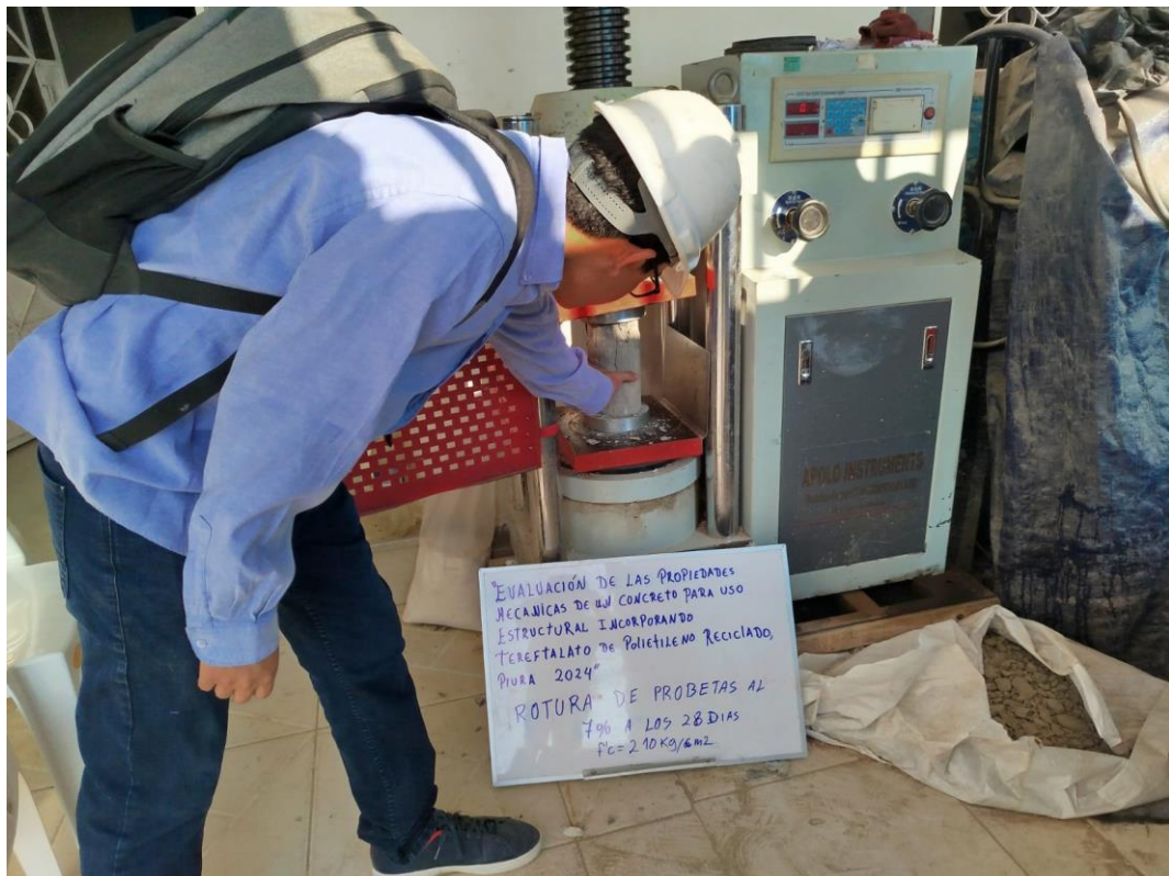
Figura 14: Ensayo de resistencia a la compresión a 28 días
