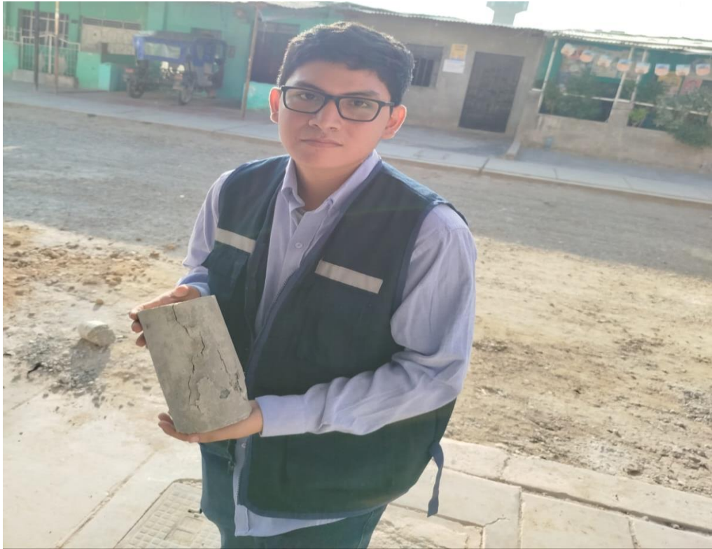
Figura 13: Rotura de probetas a 14 días
