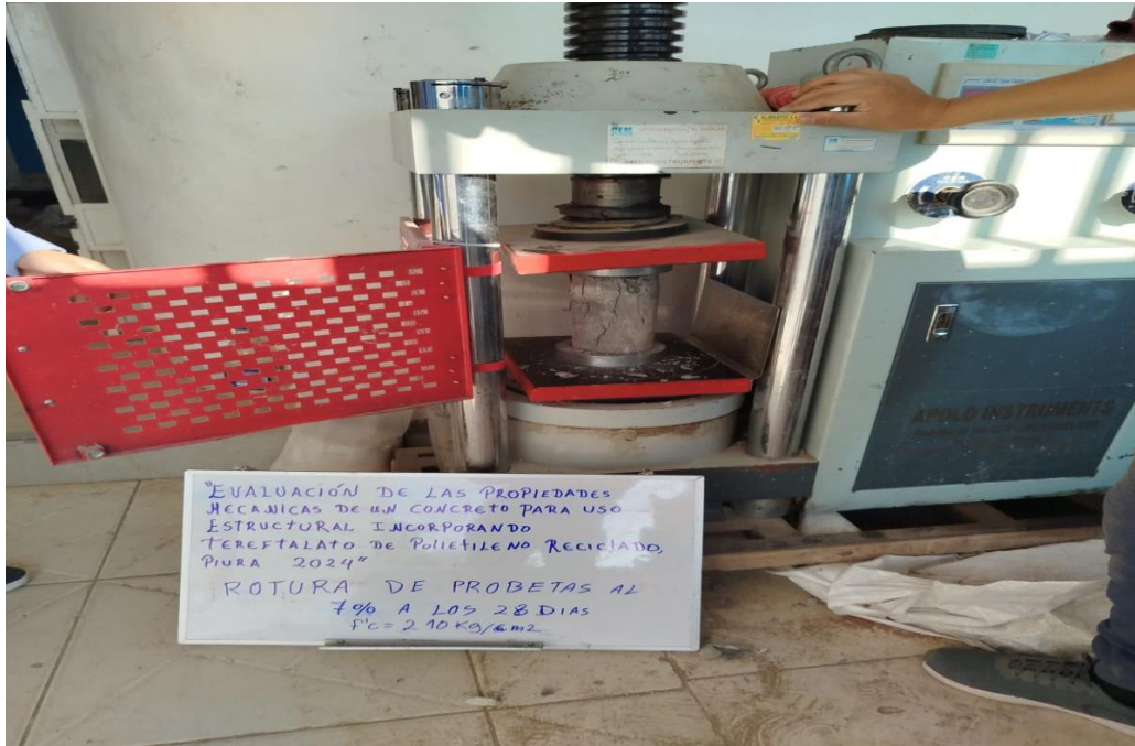
Figura 15: Rotura de probeta con 7% de PET a 28 días
