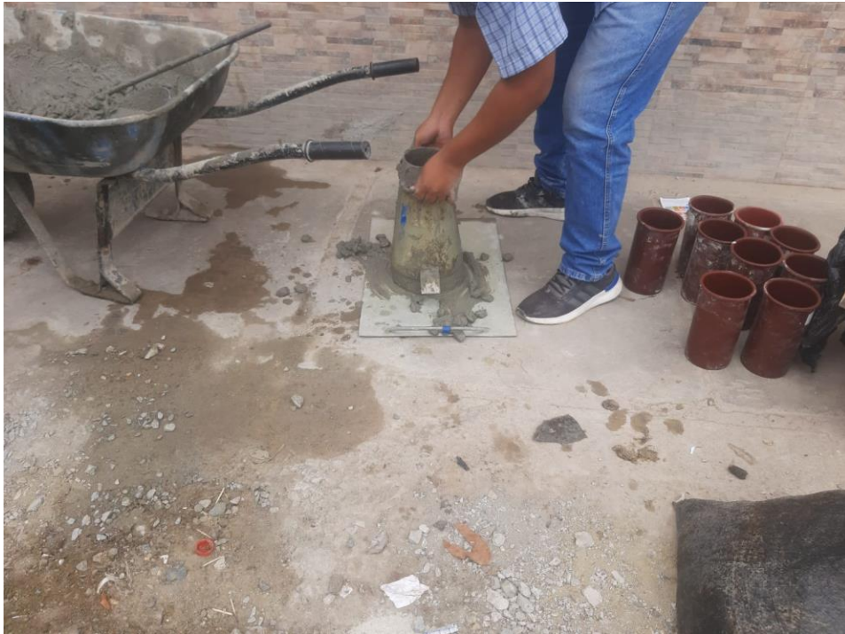
Figura 3: Ensayo SLUMP para diseño de mezcla con 7% de PET
