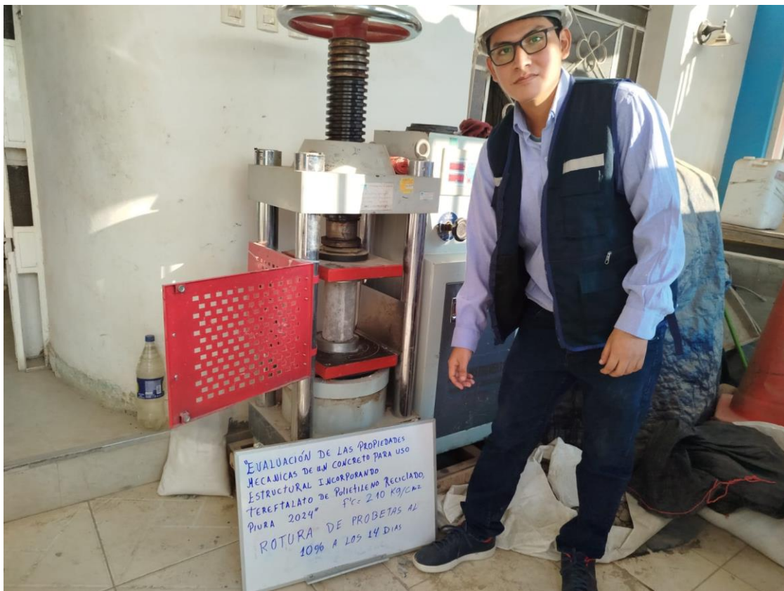
Figura 12: Ensayo de resistencia a la compresión a 14 días
