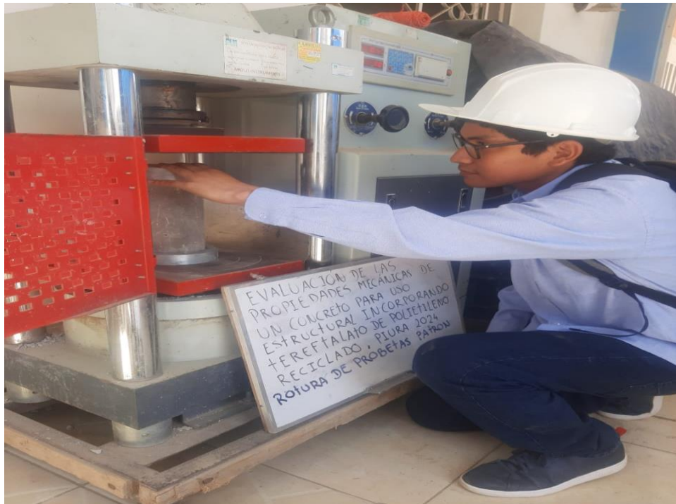
Figura 7: Ensayo de resistencia a la compresión 7 días
