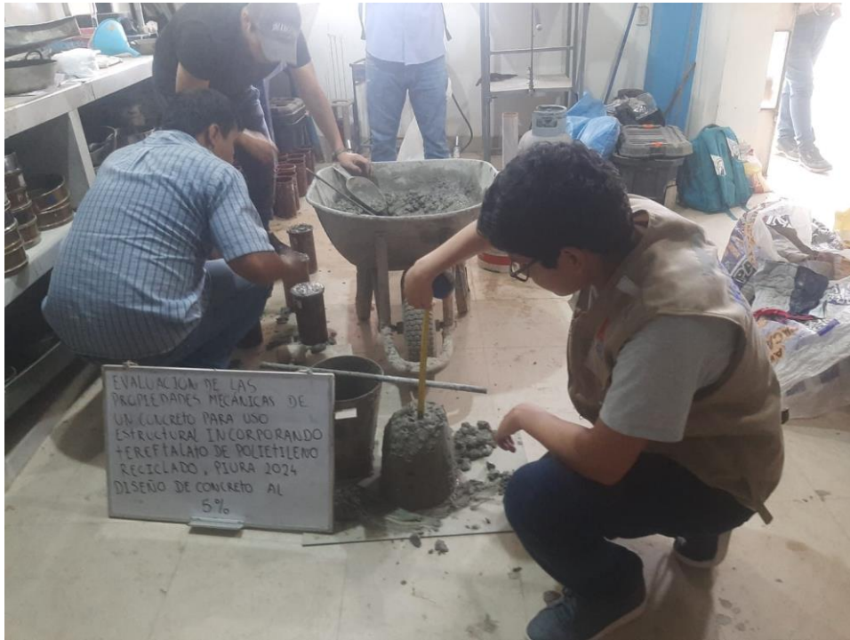
Figura 1: Ensayo SLUMP para diseño de mezcla con 5% de PET
