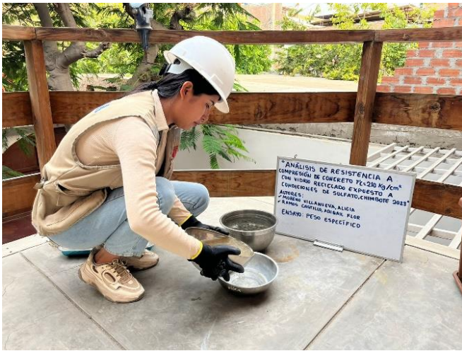
Imagen 09, 10 y 11. Peso específico de agregado grueso.
