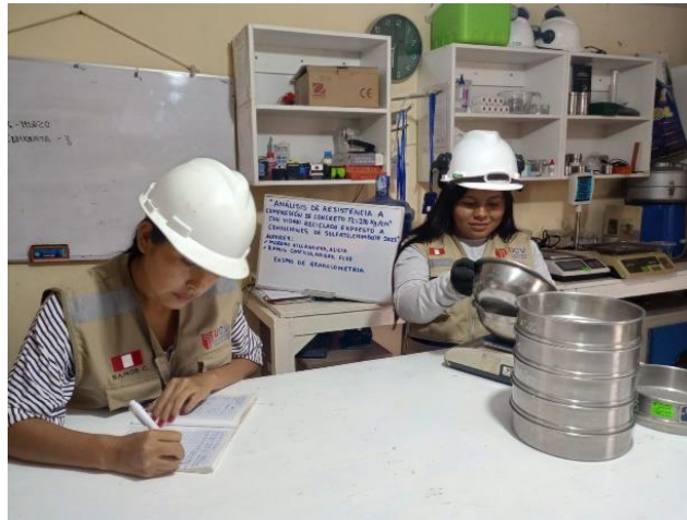
Imagen 05. Análisis granulométrico de agregado grueso.
