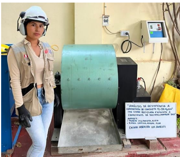
Imagen 15 y 16. Abrasión Los ángeles para triturado de vidrio.
