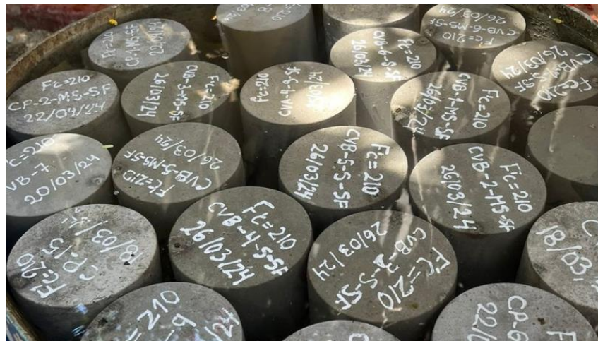
Imagen 18. Curado normal de probetas.
