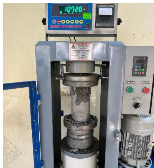
Imagen 24. Rotura de probetas en curado normal.
