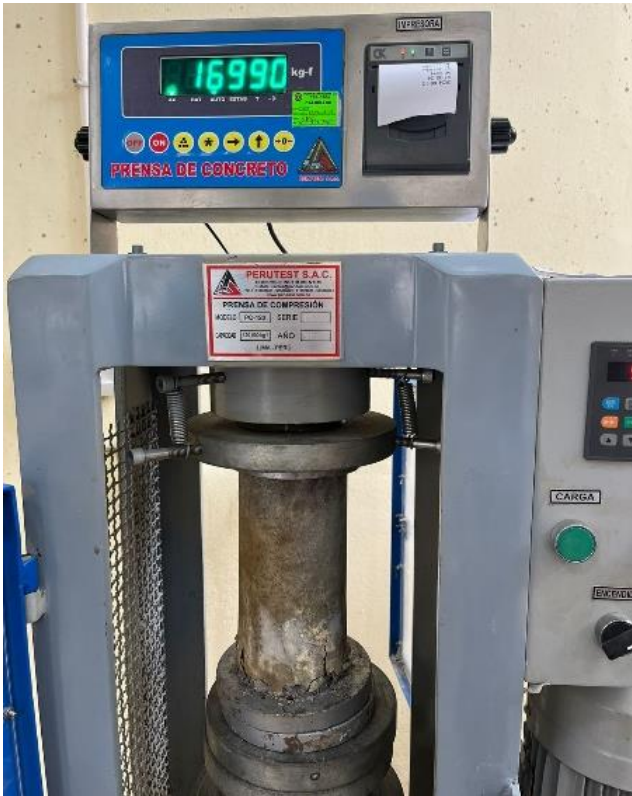
Imagen 25. Rotura de probetas luego de su exposición a sulfato durante 56 días.
