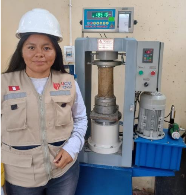
Imagen 25. Rotura de probetas luego de su exposición a sulfato durante 56 días.
