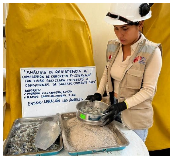
Imagen 15 y 16. Abrasión Los ángeles para triturado de vidrio.
