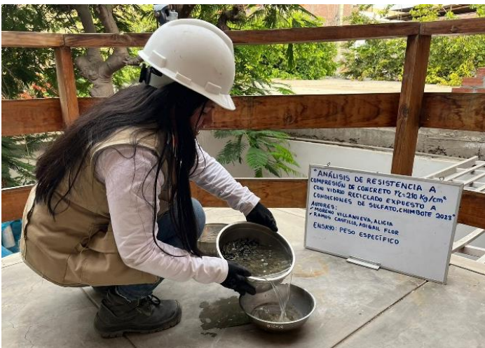
Imagen 09, 10 y 11. Peso específico de agregado grueso.
