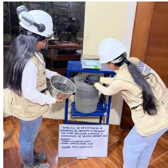
Imagen 09, 10 y 11. Peso específico de agregado grueso.
