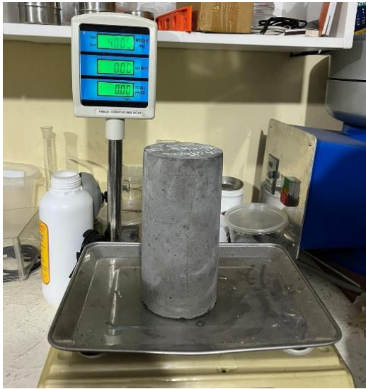
Imagen 21 y 22. Pesaje de probetas previo a su exposición.
