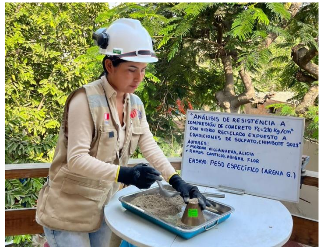
Imagen 09, 10 y 11. Peso específico de agregado grueso.
