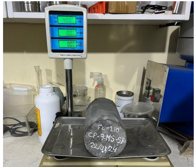
Imagen 21 y 22. Pesaje de probetas previo a su exposición.
