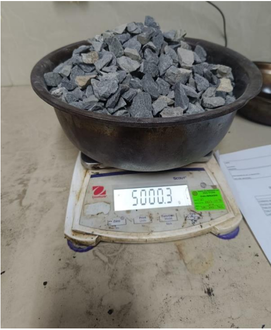
Imagen 16: Proceso de ensayo de Abrasión los Ángeles
