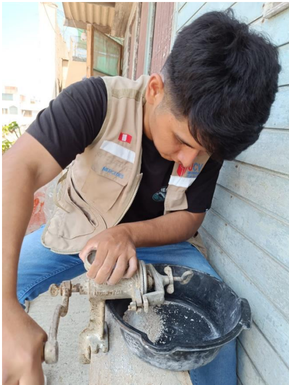
Imagen 5: Triturado manual con molino de las conchas de abanico
