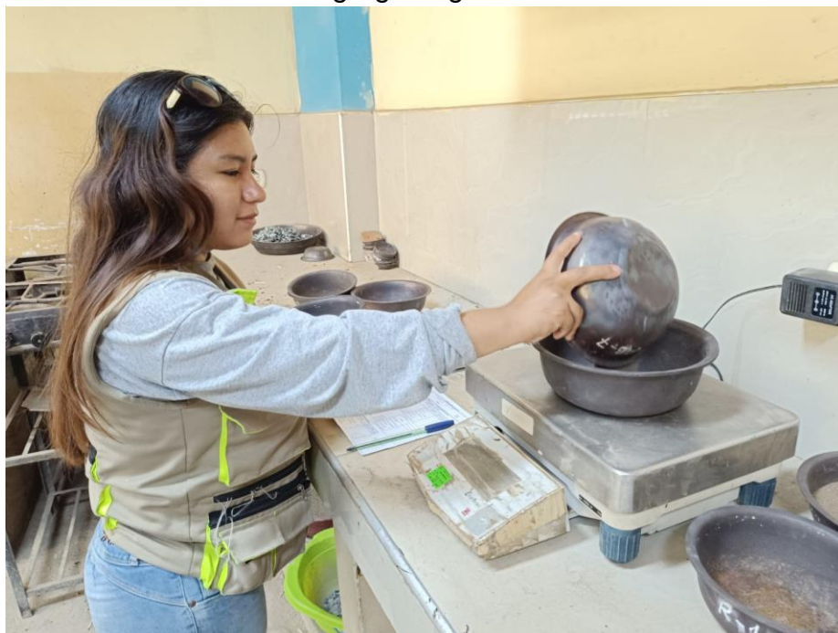
Imagen 11: Pesado para la obtención de los retenidos del agregado grueso
