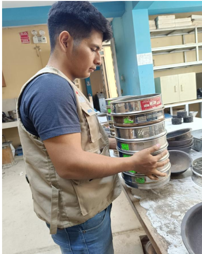
Imagen 9: Tamizado del agregado fino para el análisis granulométrico
