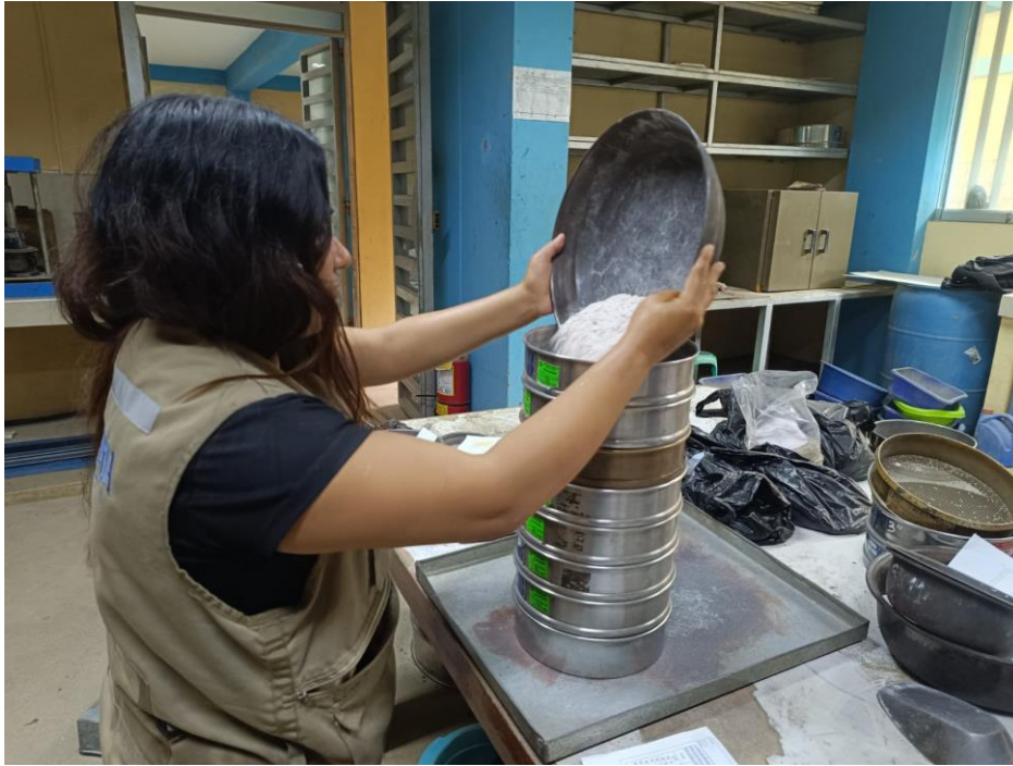
Imagen 12: Tamizado para el análisis granulométrico de las conchas de abanico
