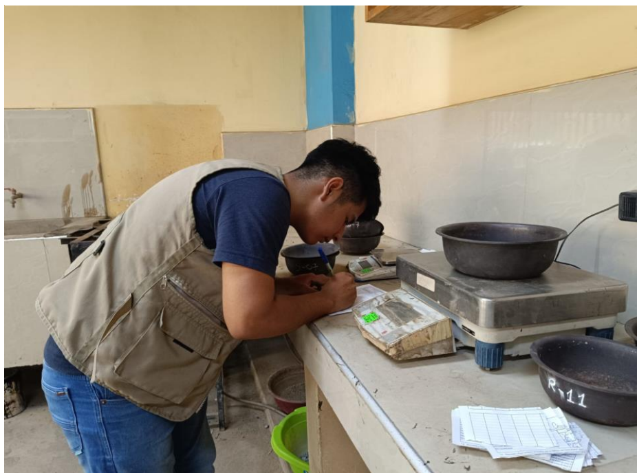
Imagen 8: Pesado para la obtención de los retenidos del agregado fino
