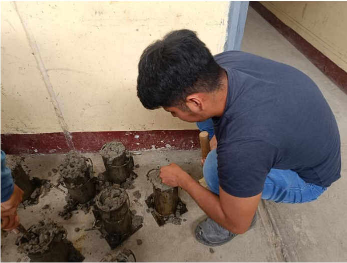
Imagen 19: Proceso de elaboración de probetas
