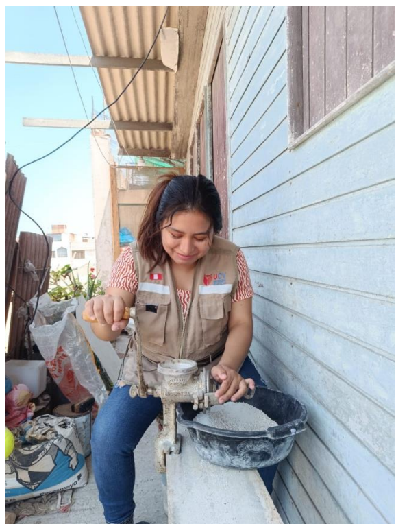
Imagen 5: Triturado manual con molino de las conchas de abanico
