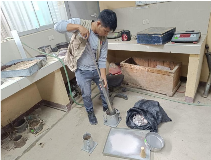
Imagen 7: Triturado y tamizado de las conchas de abanico
