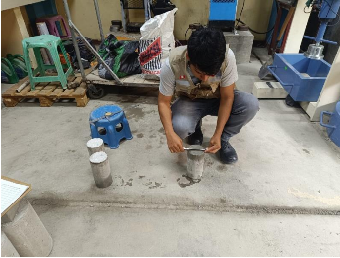
Imagen 20: Proceso de ensayo de la resistencia a la compresión
