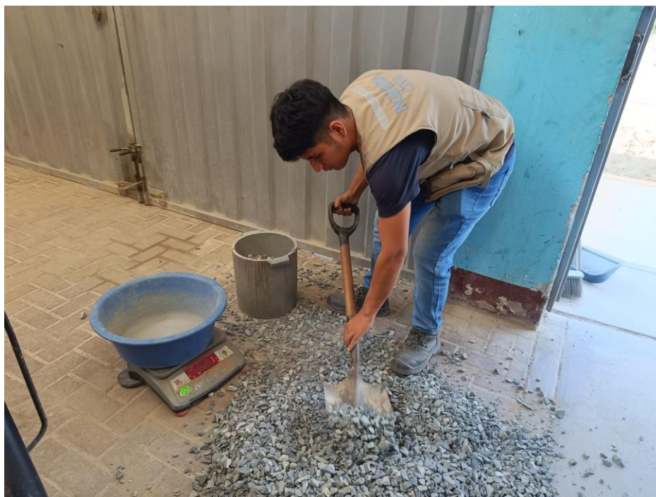
Imagen 14: Proceso del pesado del material suelto y varillado del agregado grueso
