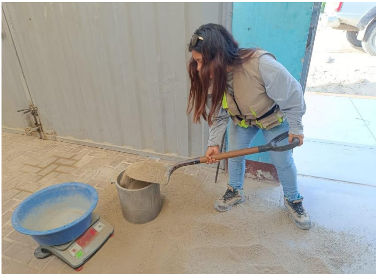
Imagen 13: Proceso del pesado del material suelto y varillado del agregado fino
