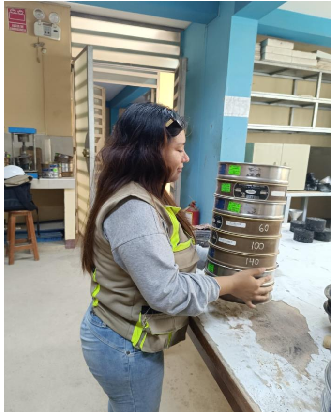
Imagen 10: Tamizado del agregado grueso para el análisis granulométrico
