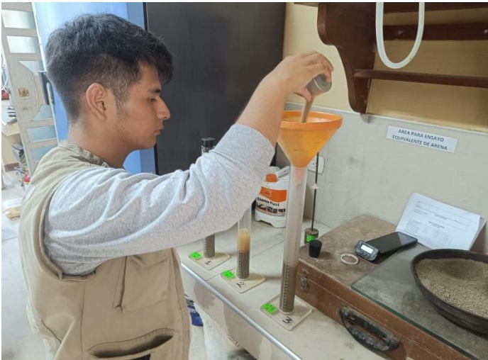
Imagen 15: Proceso de ensayo de equivalente de arena
