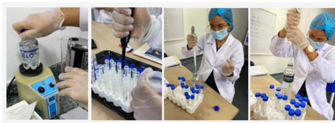
Figura 8. Homogenización en Vortex y mezcla del TISAB II con la muestra de agua embotellada.
