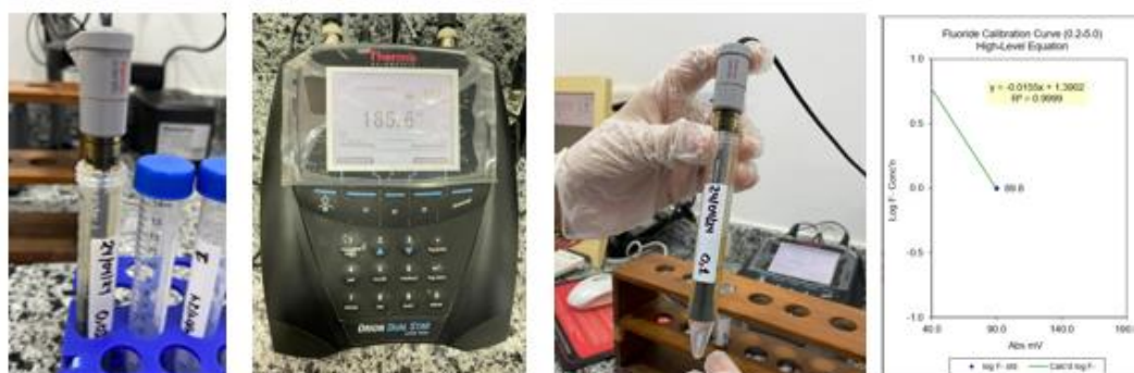
Figura 6. Lectura y construcción de la curva de calibración por el potenciómetro con el electrodo de ion selectivo de fluoruro
