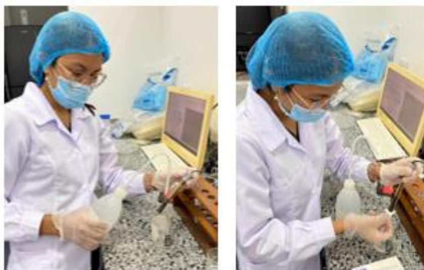
Figura 6. Lectura y construcción de la curva de calibración por el potenciómetro con el electrodo de ion selectivo de fluoruro
