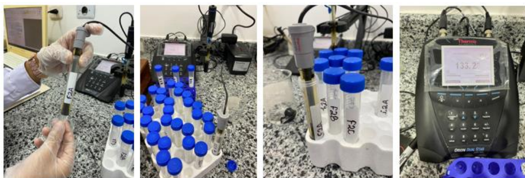
Figura 9. Posicionamiento de viales y medición de la concentración de fluoruro por el potenciómetro.
