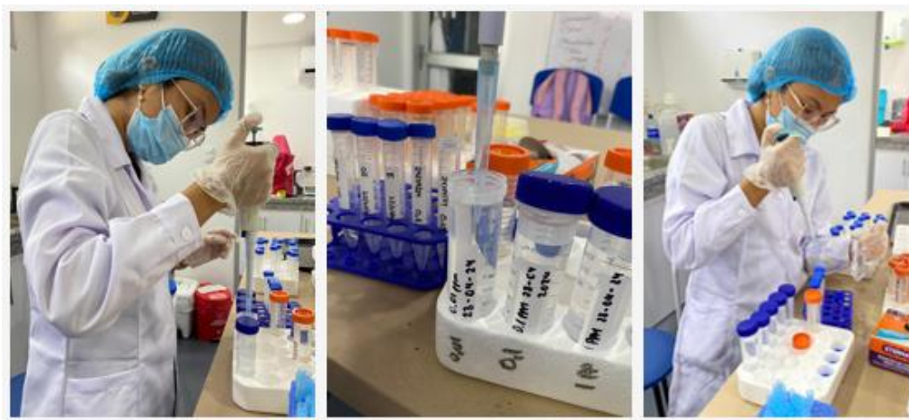
Figura 4. Preparación de los estándares de fluoruro con el uso de las pipetas y micropuntas
