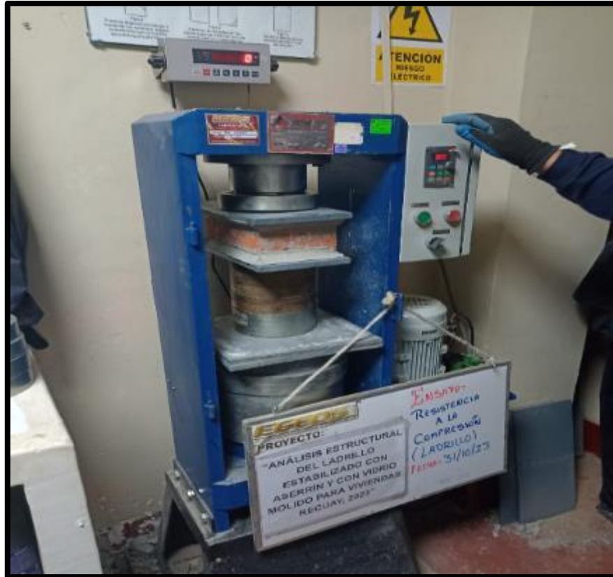
Fotografía 11. Pruebas y ensayos a ladrillo patrón y ladrillo con estabilización de aserrín y vidrio molido.
