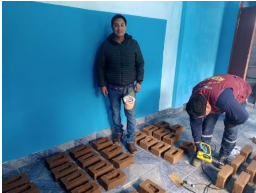
Fotografía 8. Secado de ladrillo patrón y ladrillo con estabilización de aserrín y vidrio molido
