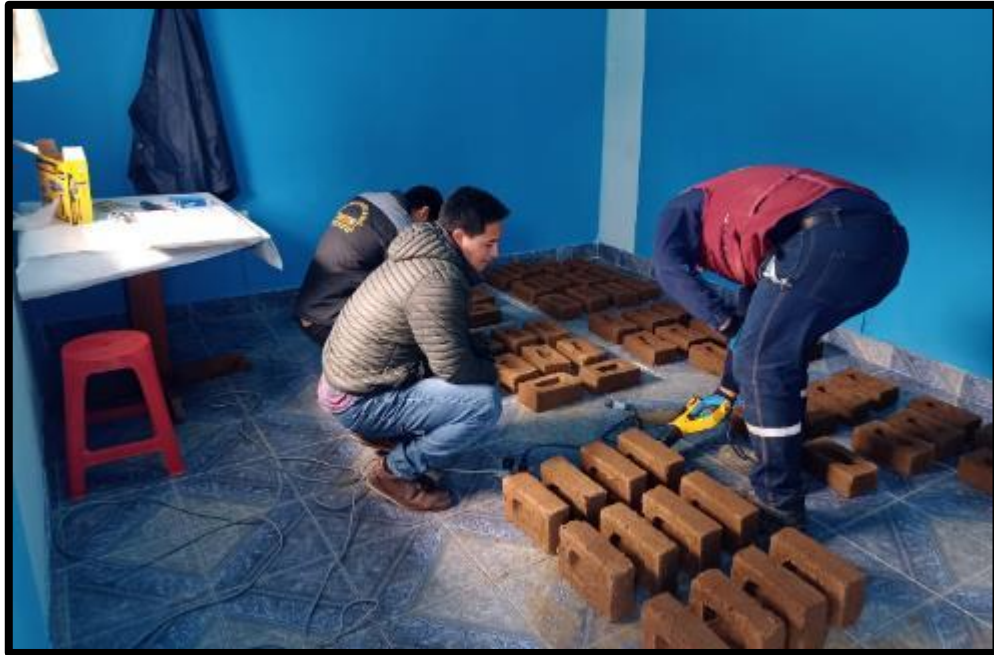
Fotografía 9. Identificación de ladrillo patrón y ladrillo con estabilización de aserrín y vidrio molido
