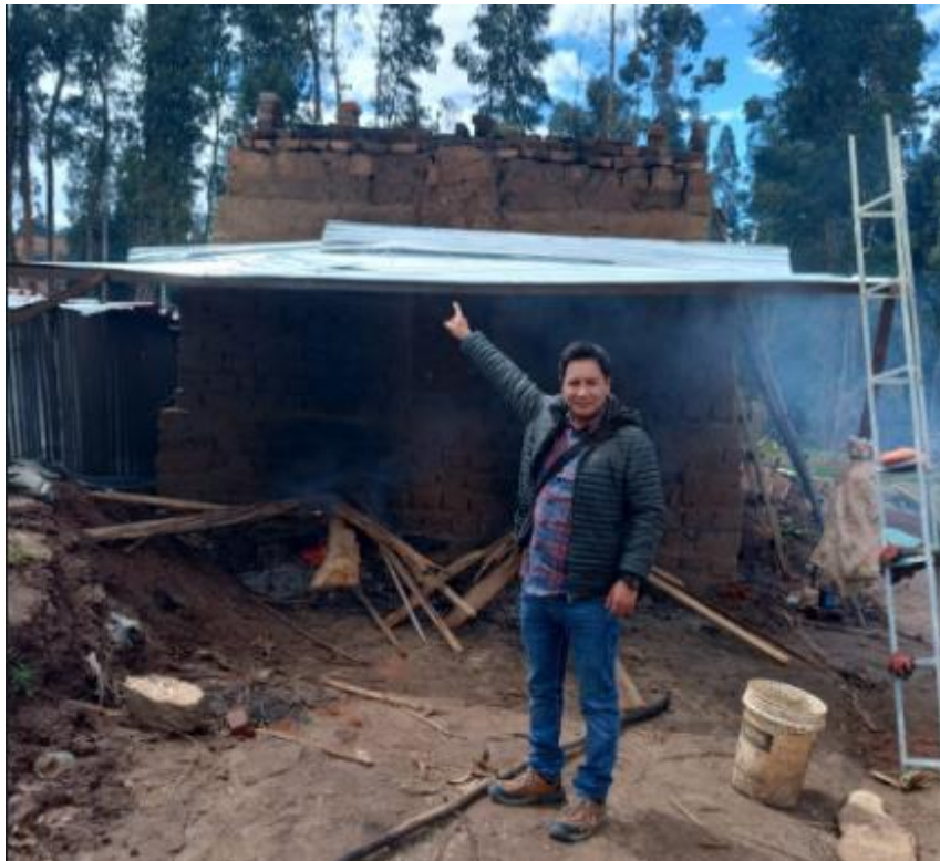
Fotografía 10. Secado de ladrillo patrón y ladrillo con estabilización de aserrín y vidrio molido
