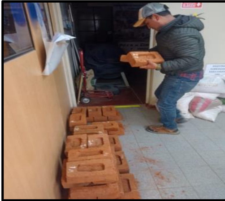
Fotografía 11. Traslado de muestras de ladrillo patrón y ladrillo con estabilización de aserrín y vidrio molido, para ensayos
