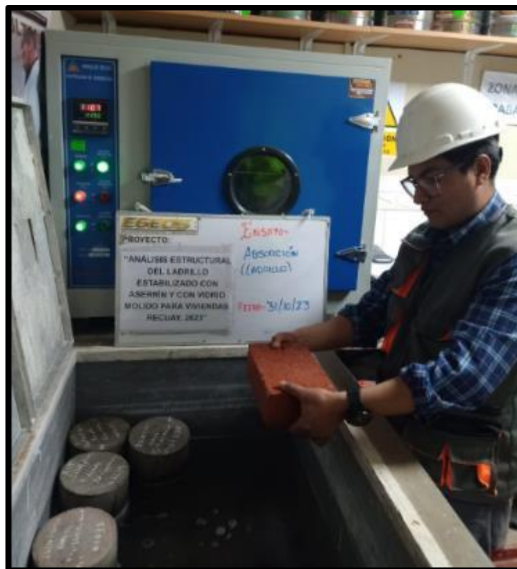
Fotografía 11. Pruebas y ensayos a ladrillo patrón y ladrillo con estabilización de aserrín y vidrio molido.
