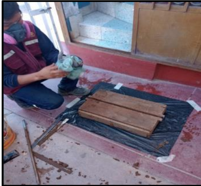
Fotografía 7. Elaboración de ladrillo según porcentajes de adición de los materiales
