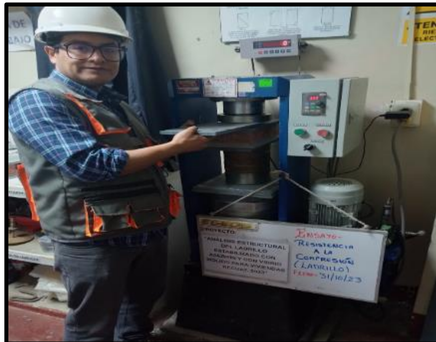
Fotografía 11. Pruebas y ensayos a ladrillo patrón y ladrillo con estabilización de aserrín y vidrio molido.
