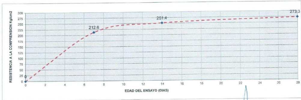
CUADRO ESTADISTICO DE RESISTENCIA A LA COMPRESION DEL CONCRETO Fc=280 Kg/cm2 - 1.5% NANOSILICE A 28 Días
