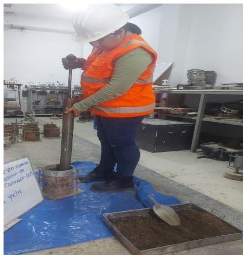
Figura 31. Ensayo de CBR
