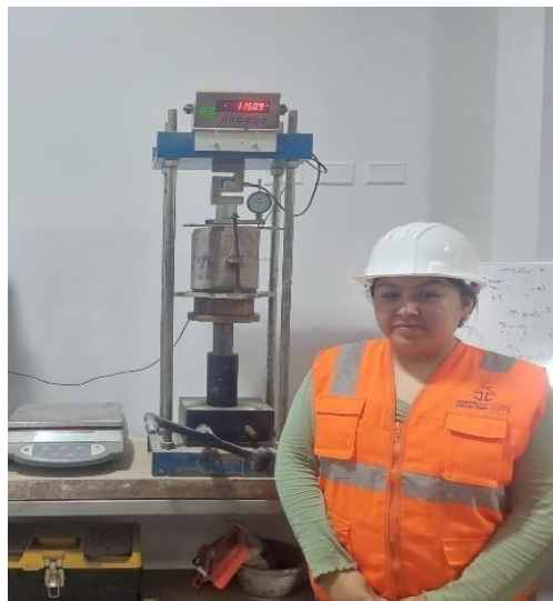
Figura 33. Lectura de Penetración CBR
