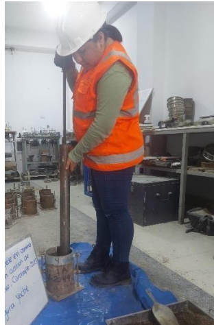
Figura 30. Ensayo de Proctor Modificado
