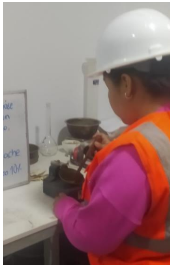
Figura 25. Ensayo Limite Líquido con 10% MgCl 2
