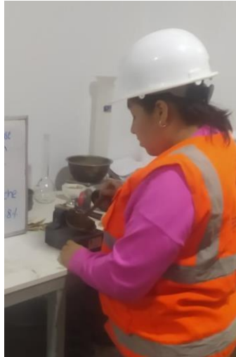
Figura 24. Ensayo Limite Líquido con 8% MgCl 2
