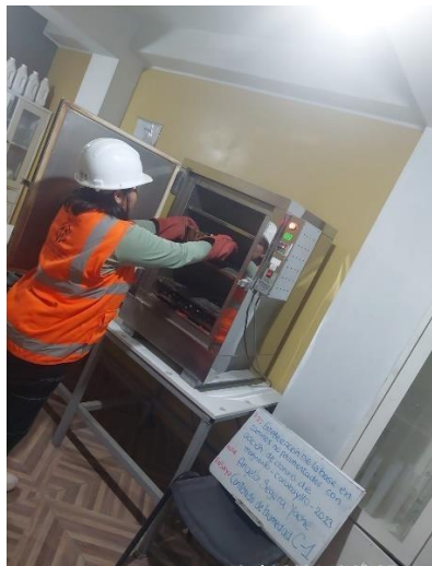
Figura 17. Preparación de las muestras para su colocación en horno
