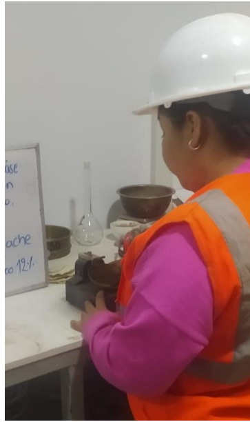
Figura 26. Ensayo Limite Líquido con 12% de MgCl 2
