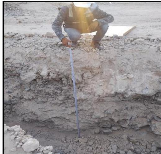
Medición de la calicata N°3 a 1.50m de altura de profundidad
