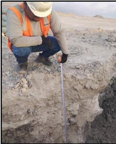
Medición de la calicata N°2 a 1.50m de altura de profundidad
