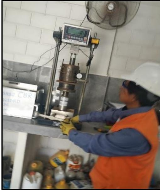
Se utilizó la prensa CBR para hallar la capacidad de soporte del material extraído sin la adición de vidrio y posteriormente con la adición de vidrio reciclado triturado de 5%,6%,7% para hallar la capacidad de soporte de nuestro suelo
