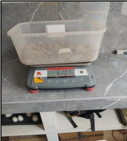
Se pesó el material para el avanzar con el Proctor
