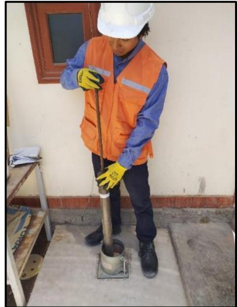
Se comenzó el Proctor sin la adición de vidrio y con la adición de vidrio triturado 5%,6%,7% y con el procedimiento del Proctor modificado respetando la norma para el N° de golpes.
