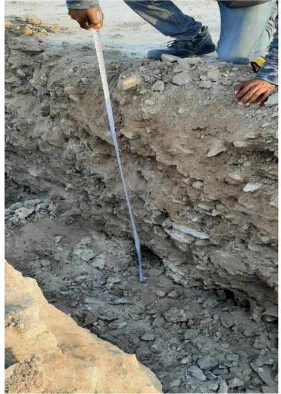
Medición de la calicata N°1 a 1.50m de altura de profundidad
