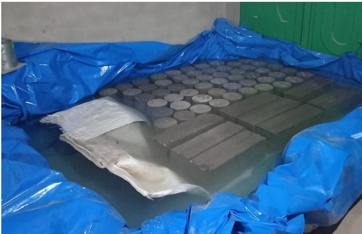
Figura 38 curado de testigos para 7, 14 y 28 días
