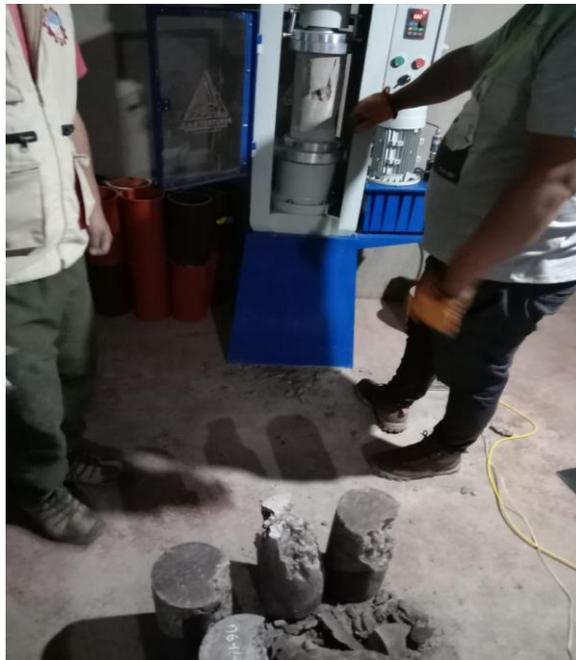
Figura 26 ensayos de resistencia a la compresión
