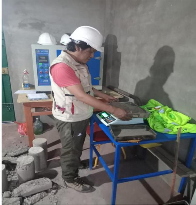
Figura 9 pesado del agregado grueso
