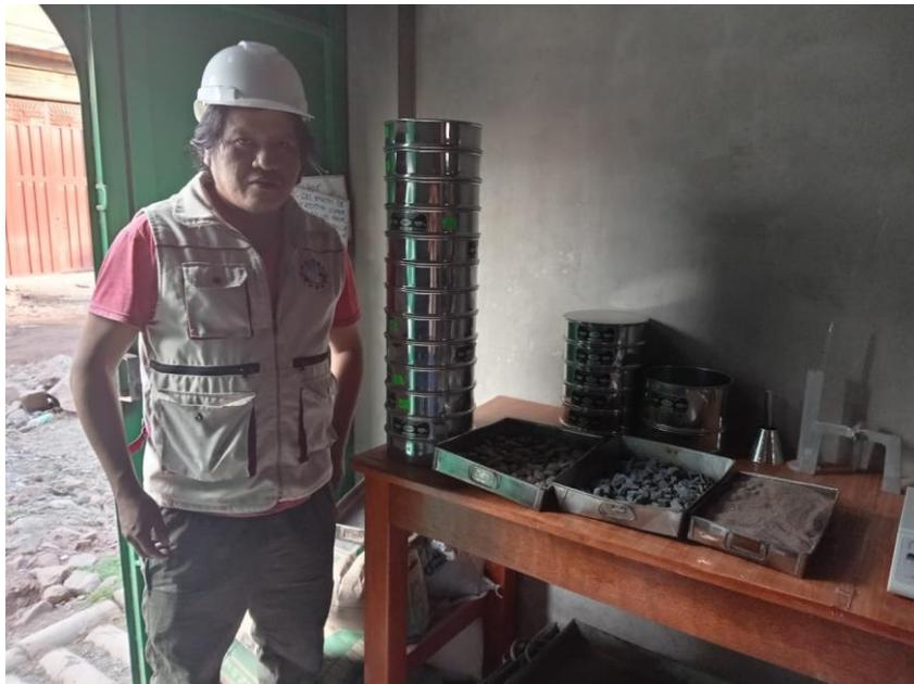
Figura 8 proceso de tamizaje de los agregados
