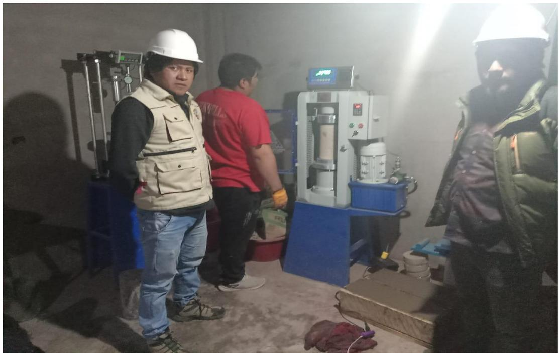
Figura 42 ensayo de ruptura de testigos a compresión
