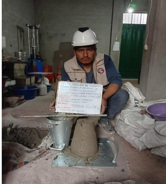
Figura 15 muestra de ensayo slump patrón
