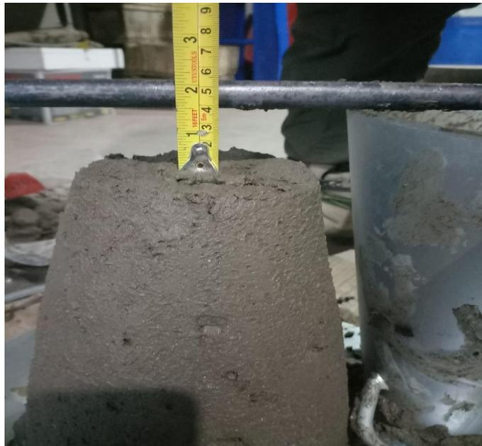
Figura 16 ensayo de slump patrón
