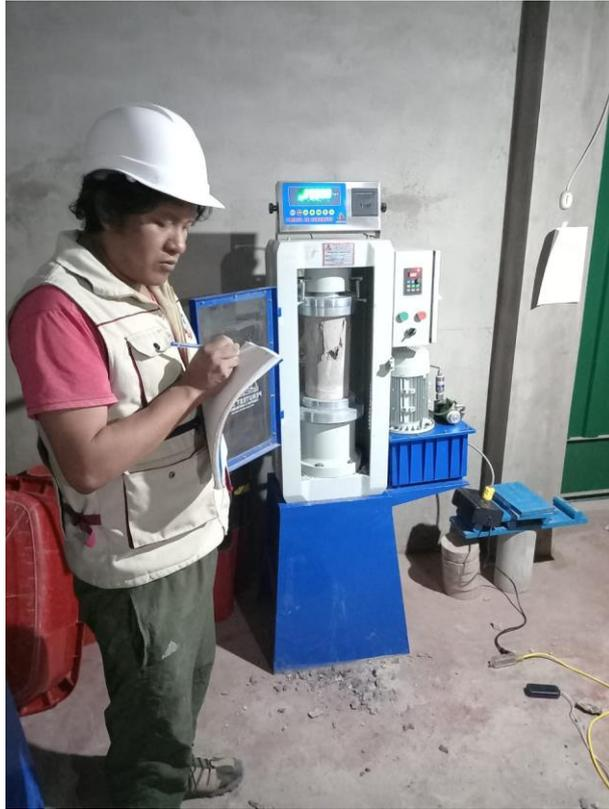
Figura 25 ensayo a la resistencia a la compresión
