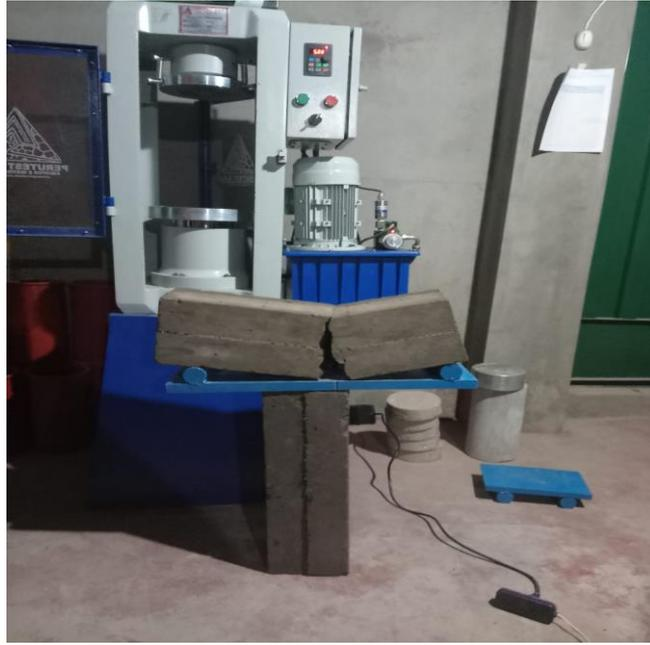
Figura 30 rotura de testigos con ensayo a flexión
