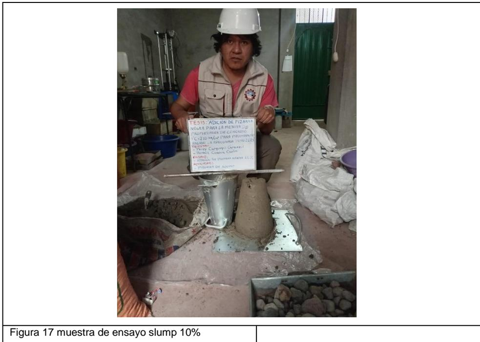
Figura 17 muestra de ensayo slump 10%
