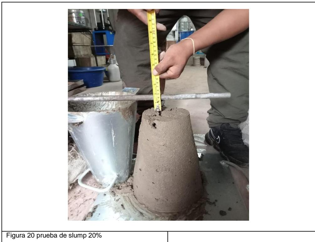
Tabla 8 Resultados de los ensayos de la prueba de Slump
