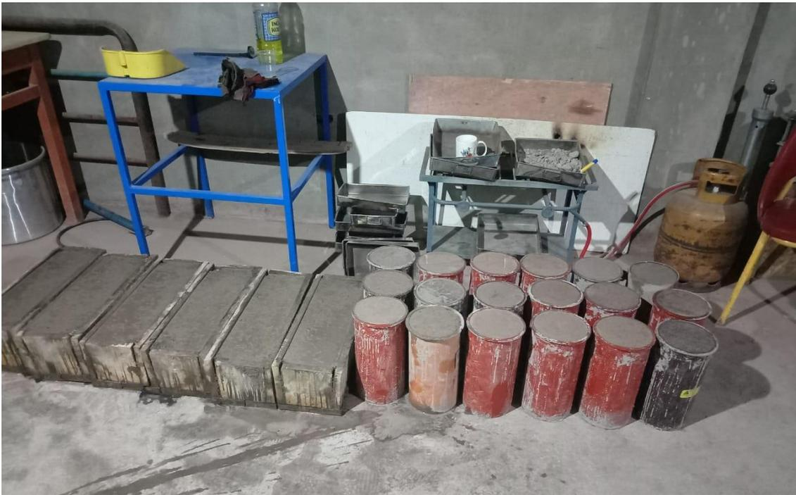
Figura 39 elaboración de testigos de compresión y flexión
