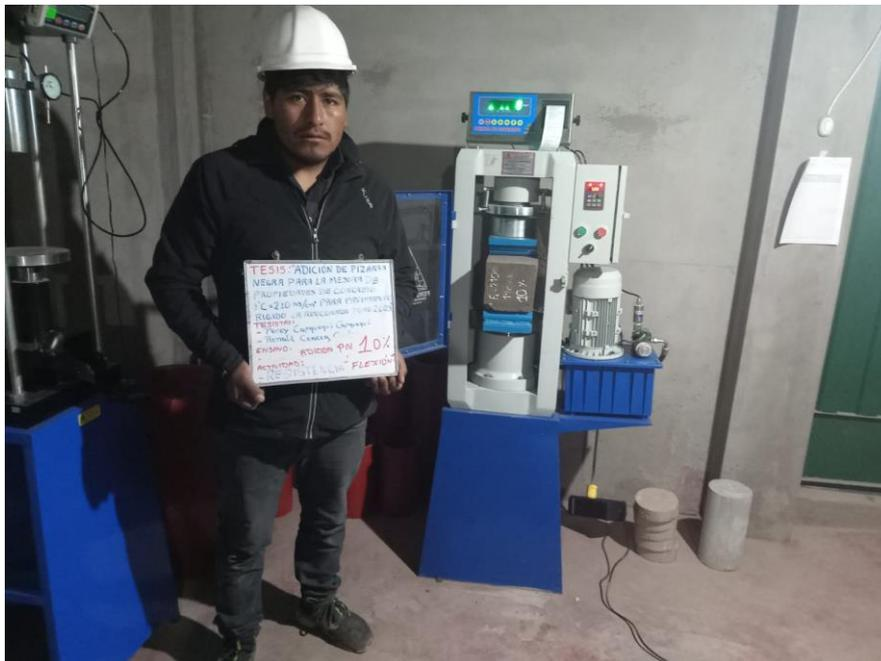
Figura 29 rotura de testigos con ensayo a flexión
