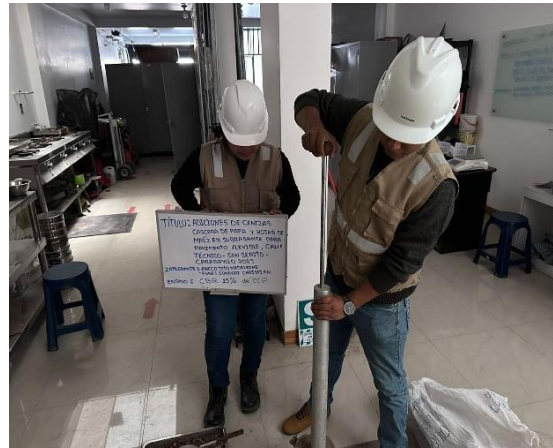
Foto: Ensayo de CBR con las adiciones de cascara de papa
