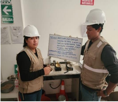
Figura 20. Se realizó el ensayo de índice de plasticidad con las dosificaciones 5%,10% y 15% de CCP y CHM.
