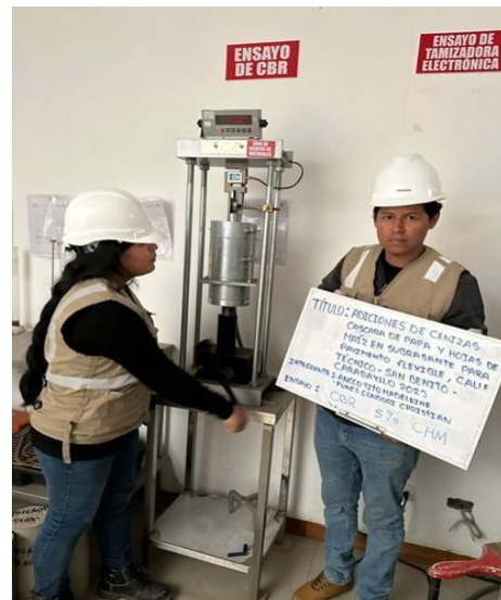
Foto: Ensayo de CBR, con la máquina de compresión axial para determinar resistencia a la compresión
