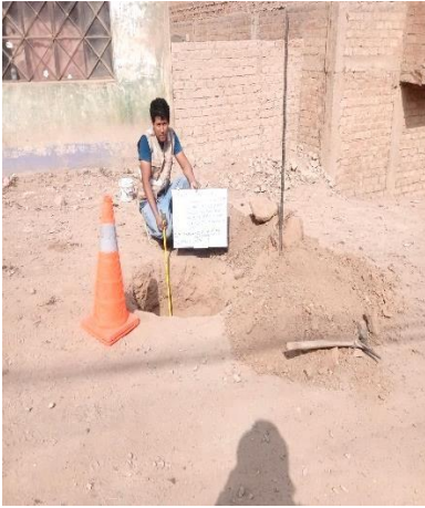
Figura 13. Calicata 1 a una profundidad de 1.50m de 1.00 x1.00
