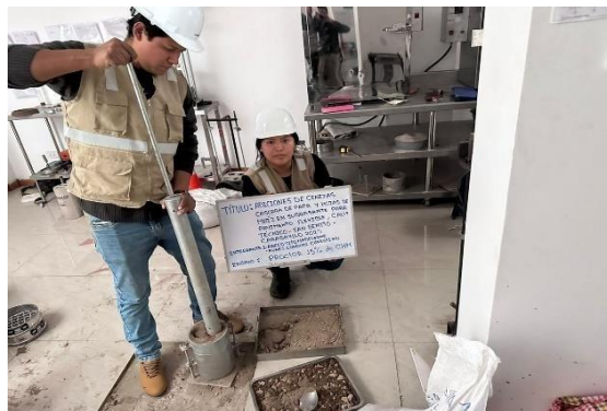
Foto: Ensayo de Proctor con las adiciones de cenizas de hojas de maíz
