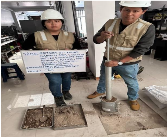
Foto: Ensayo de CBR con la nuestras patrón
