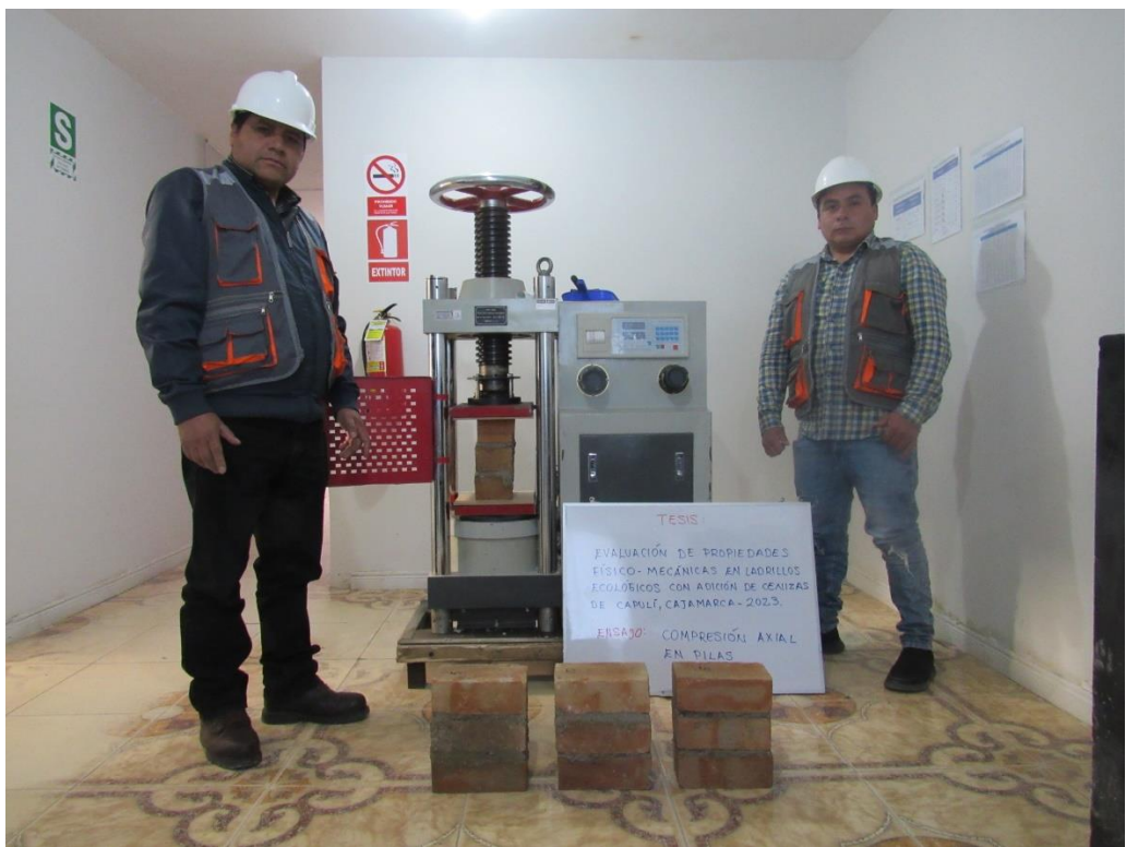
Foto 14. Ensayo de resistencia a la compresión de prismas
