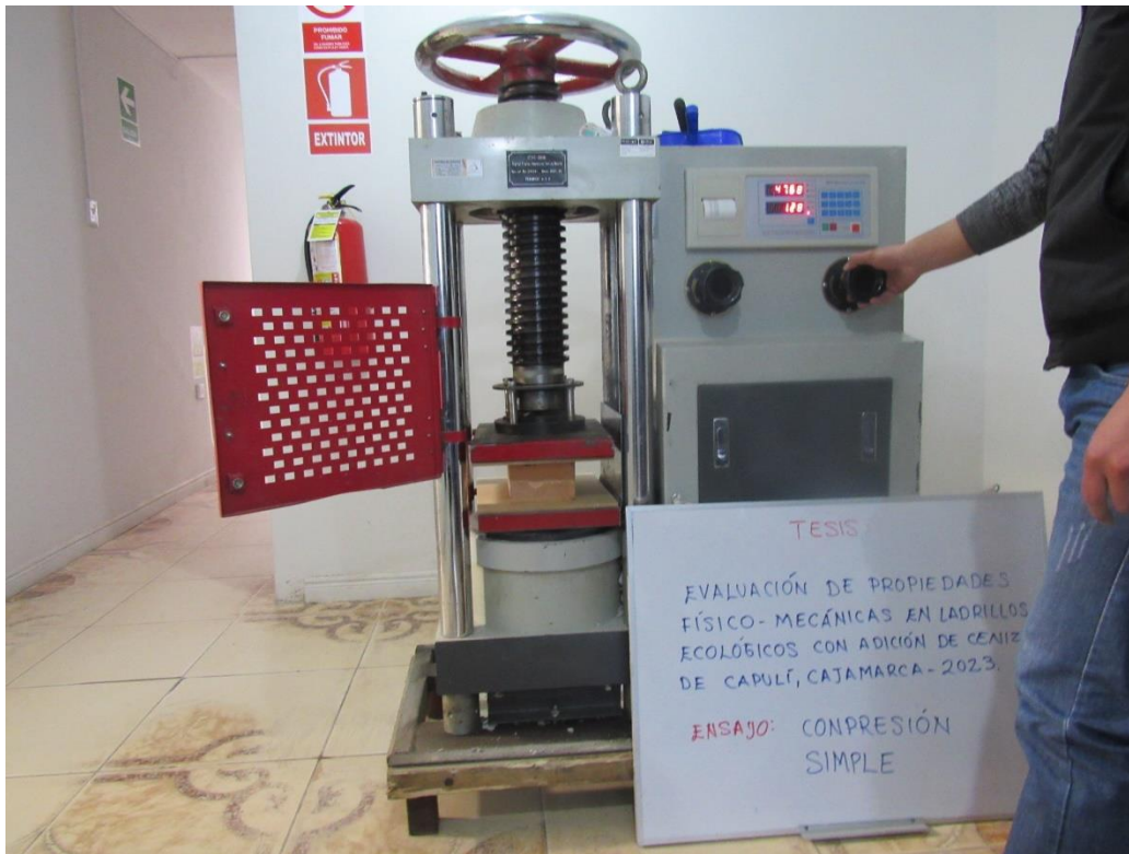
Foto 13 Ensayo de resistencia a la compresión de unidades
