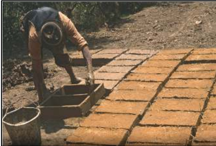
Figura 2. Elaboración de los bloques de adobe Fuente: https://www.archdaily.pe/pe/944575/adobe-el-material-reciclable-mas-sostenible
