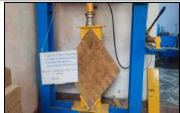
Figura 36. Prueba de resistencia diagonal en muretes
