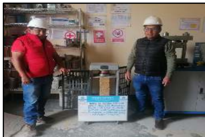
Figura 15. Prueba de esfuerzo a compresión en pilas
