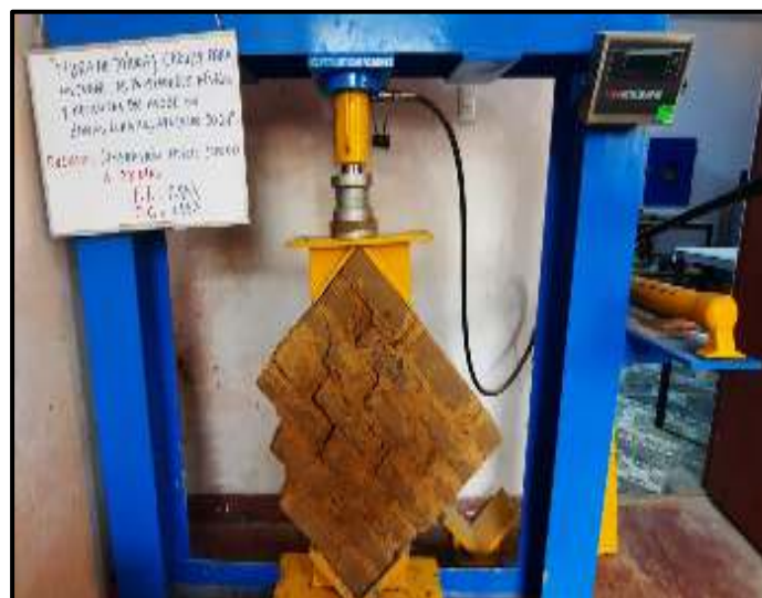
Figura 17. Prueba de esfuerzo a compresión diagonal en muretes
