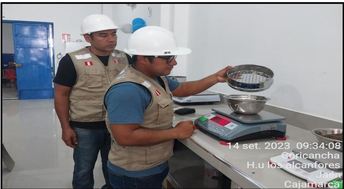
Figura 15. Anotación del peso de cada malla previamente tamizada incluyendo el fondo, para la realizar los cálculos correspondientes
