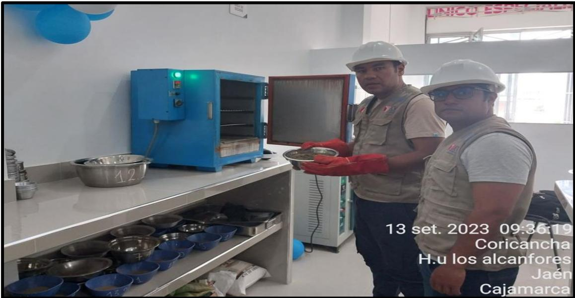
Figura 7. Introducir al horno a 110 °C durante 24 horas.
