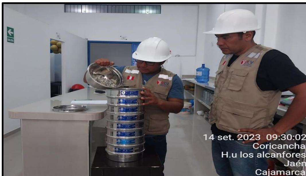
Figura 14. Colocación del agregado en el orden del N° 200 para agregado fino y agregado grueso malla N° 2 al N° 4
