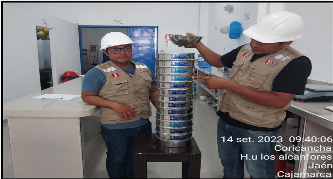
Figura 13. Colocación del agregado en el orden de juego de tamices desde la malla N° 1/2" al N° 200 para agregado fino y agregado grueso malla N° 2 al N° 4
