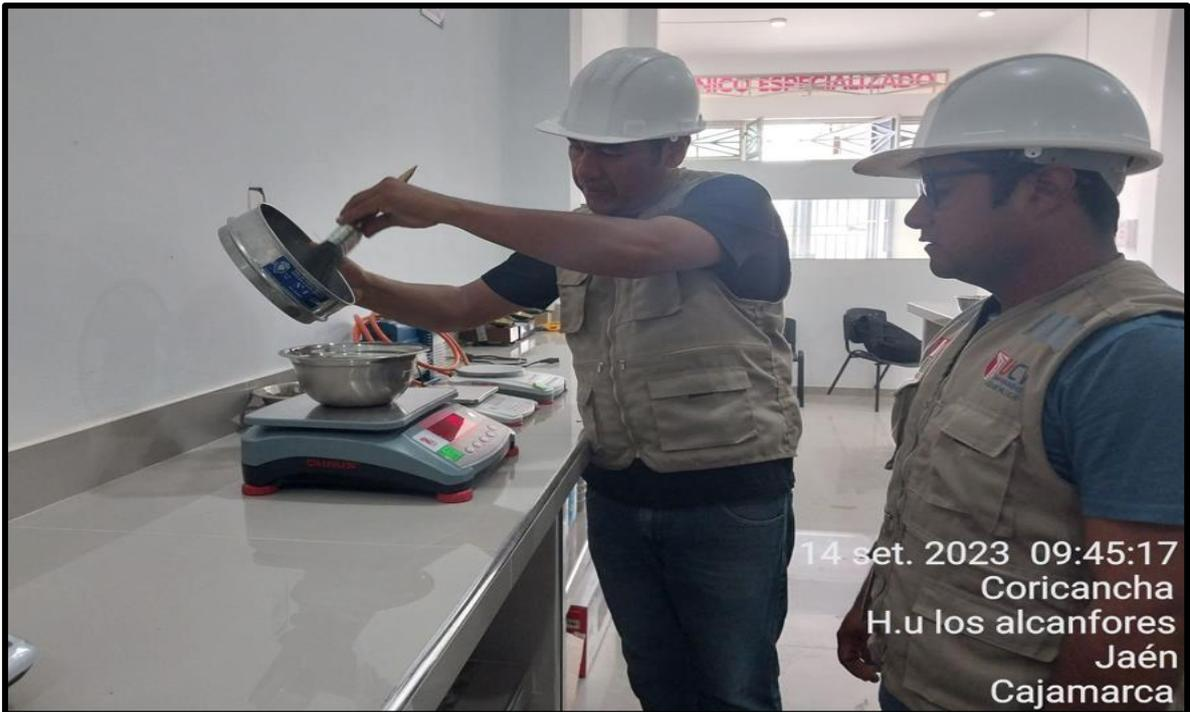
Figura 15. Anotación del peso de cada malla previamente tamizada incluyendo el fondo, para la realizar los cálculos correspondientes.
