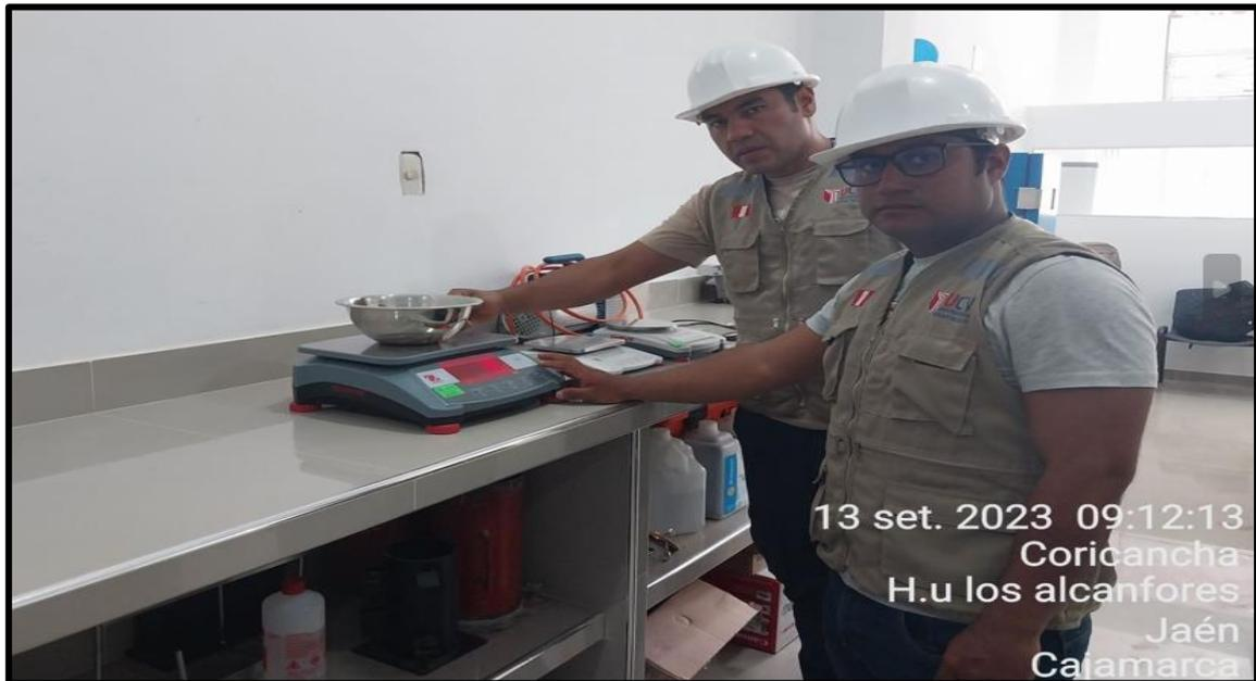
Figura 5. Peso de tara + muestra tanto del agregado fino como agregado grueso
