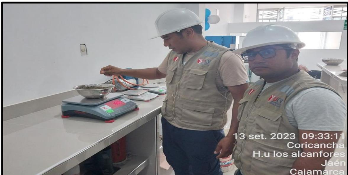
Figura 6. Peso del agregado grueso
