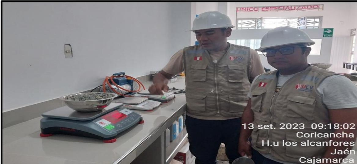
Figura 12. Peso de tara + muestra tanto del agregado fino como agregado grueso.
