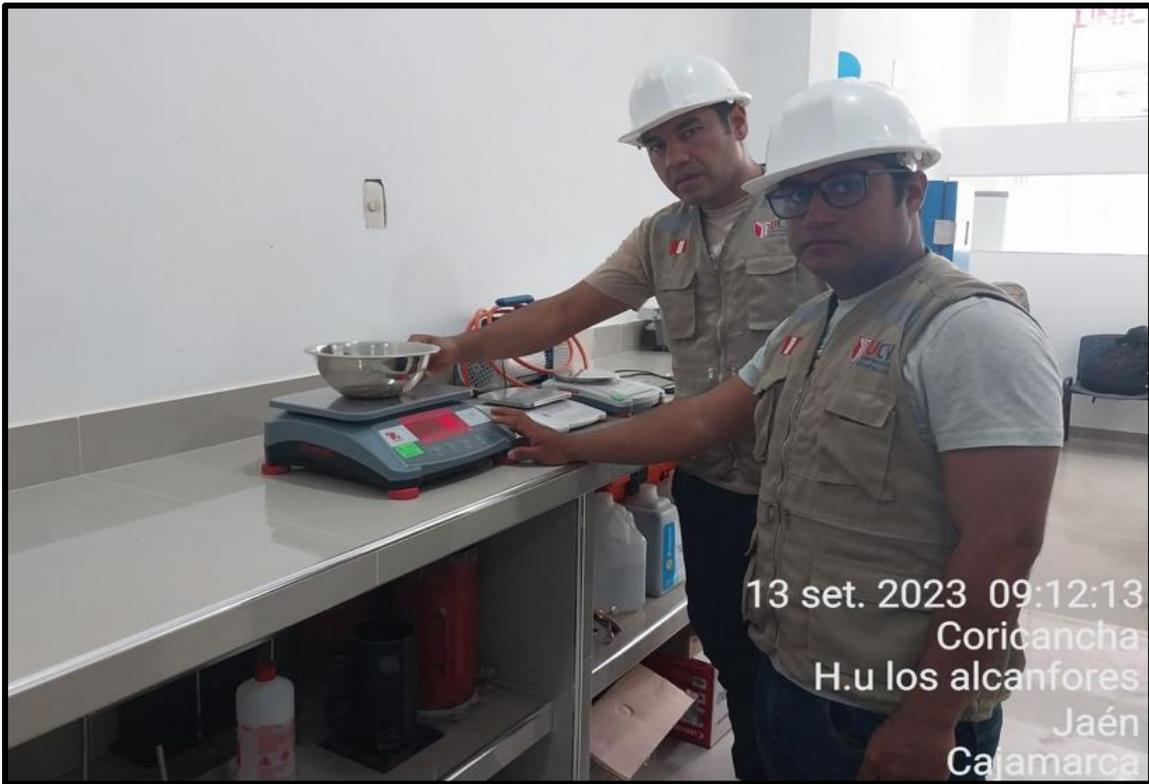
Figura 11: Peso de tara + muestra tanto del agregado fino como agregado grueso.
