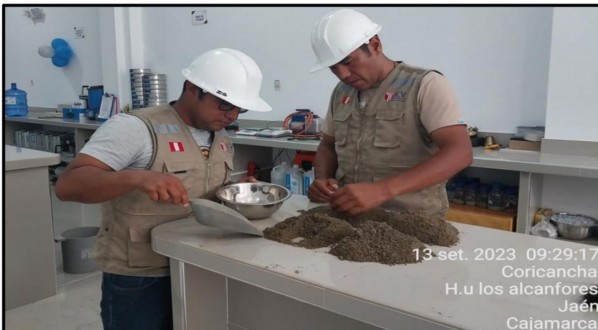
Figura 9: Cuarteo de muestras tanto del agregado fino.
