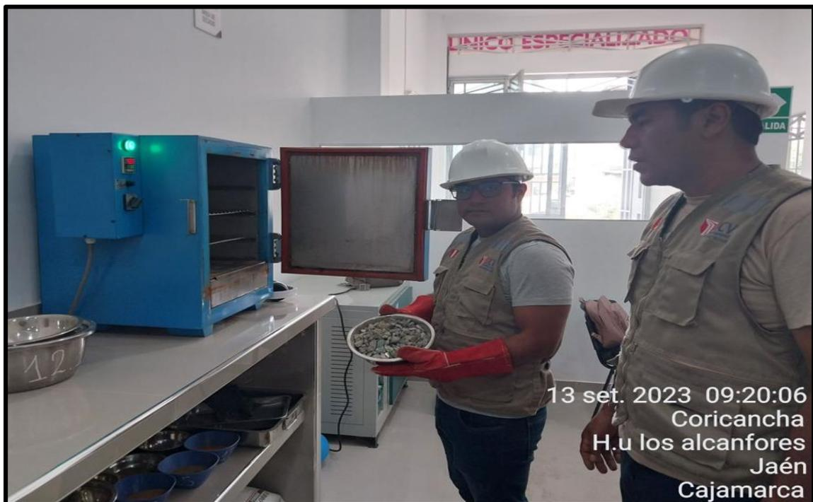
Figura 8. Introducir al horno a 110 °C durante 24 horas.
