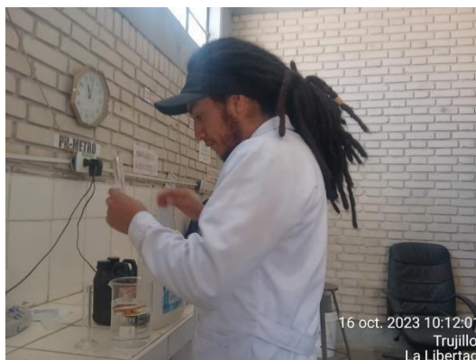
Fig.9. Mezcla de coronta pulverizado y ácido fosfórico al 25%.
