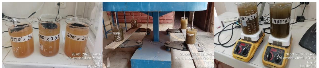
Fig.17. Mezcla de carbon activo y solución de arsénico
