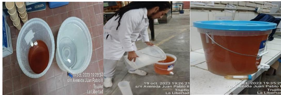
Fig.14. Preparación de solución arsénico a una concentración de 6.58ppm.
