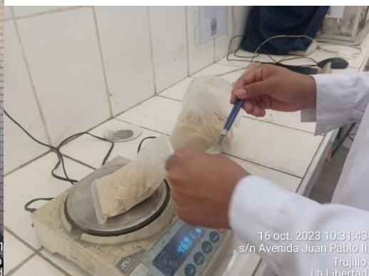
Fig.9. Mezcla de coronta pulverizado y ácido fosfórico al 25%.
