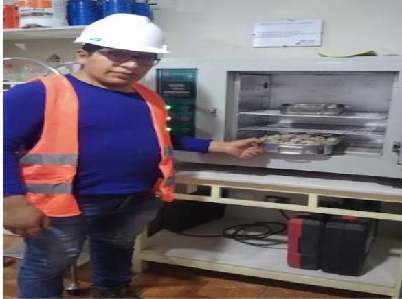
**Fotografía 7.** Contenido de humedad de los agregados
