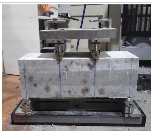
**Fotografía 12.** Ensayo de resistencia a flexión
