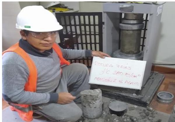
**Fotografía 10.** Ensayo de resistencia a compresión
