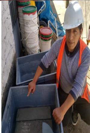
**Fotografía 9.** Elaboración de probetas y vigas
