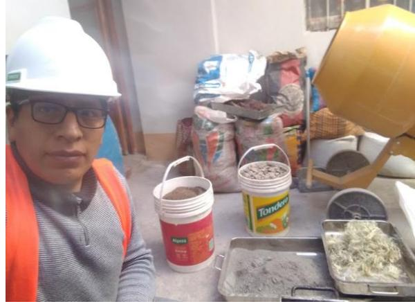
**Fotografía 8.** Adición de la fibra de agave al concreto
