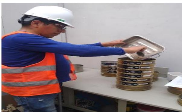
**Fotografía 5.** Granulometría del agregado
