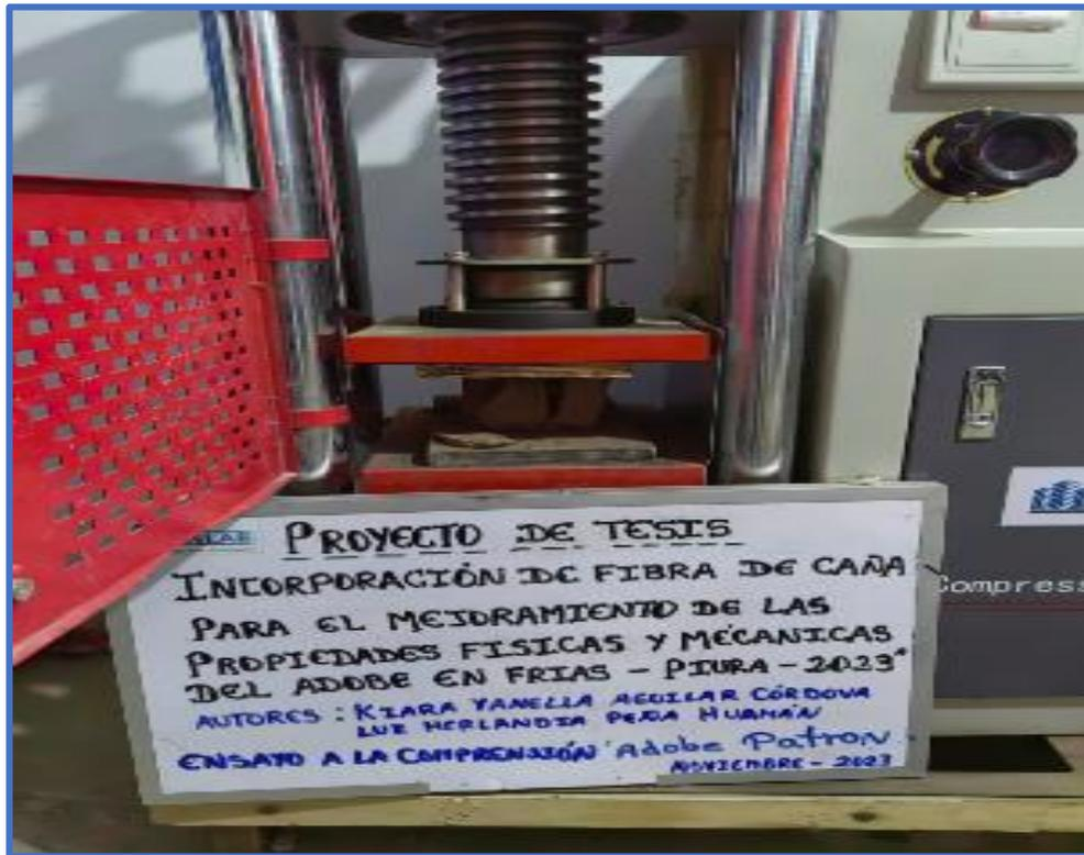
Figura N°22: Ensayo de resistencia a la compresión rotura de adobe patrón
