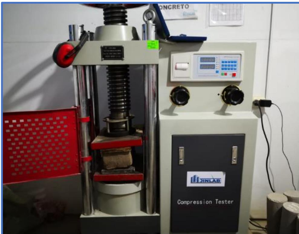
**Figura N°21:** Ensayo de resistencia a la compresión al 4% de fibra de caña.
