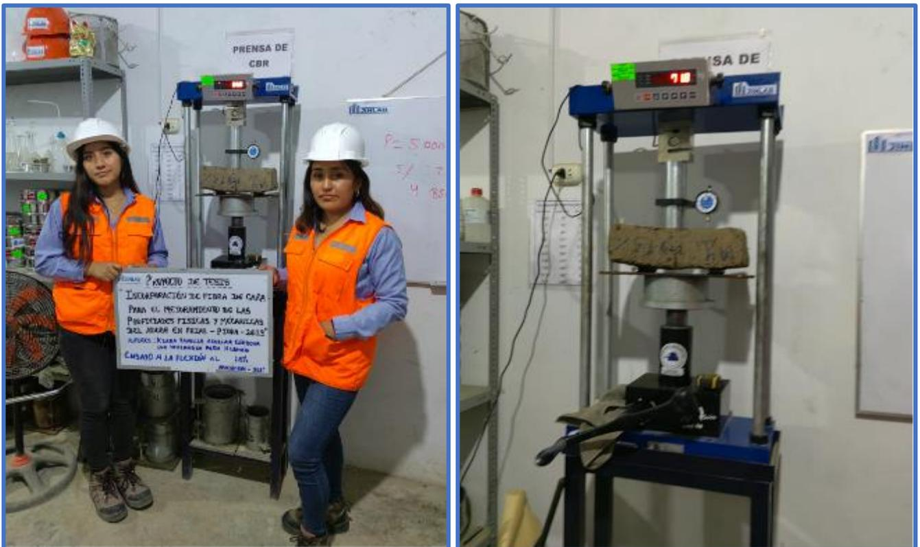
Figura N°25: Ensayo de resistencia a la flexión al 1.5 de fibra de caña
