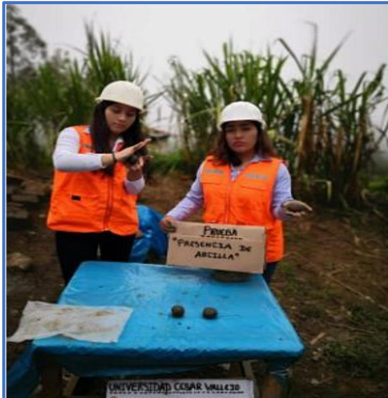
Figura N°11: Prueba “Presencia de Arcilla o Resistencia Seca”
