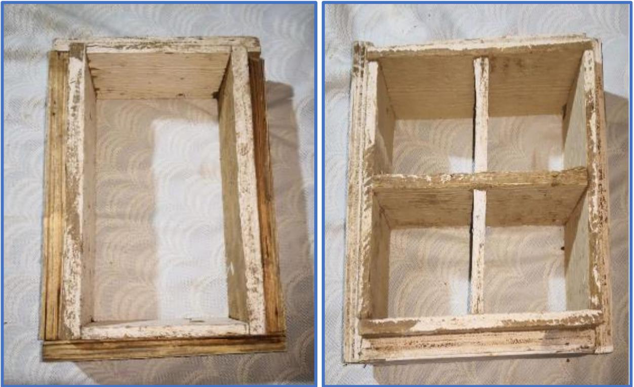
**Figura N°12: Moldes Fabricados de madera**
