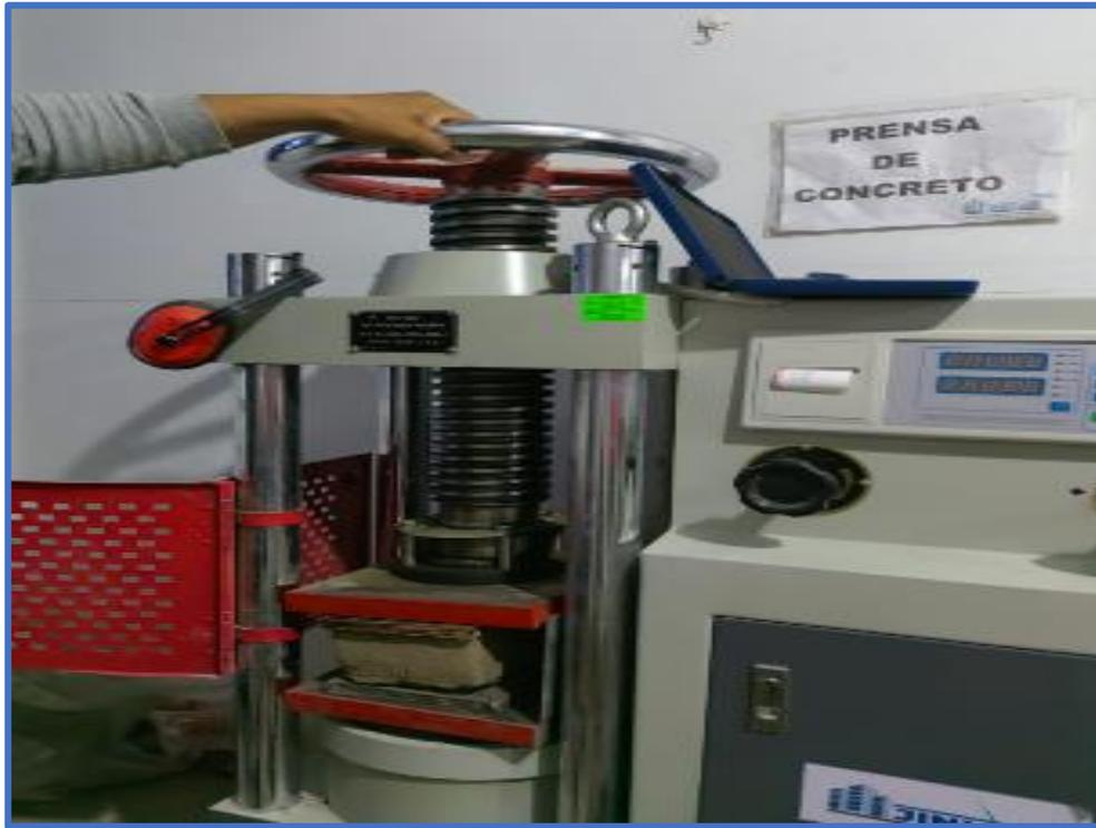
**Figura N°20:** Ensayo de resistencia a la compresión al 1.5% de fibra de caña
