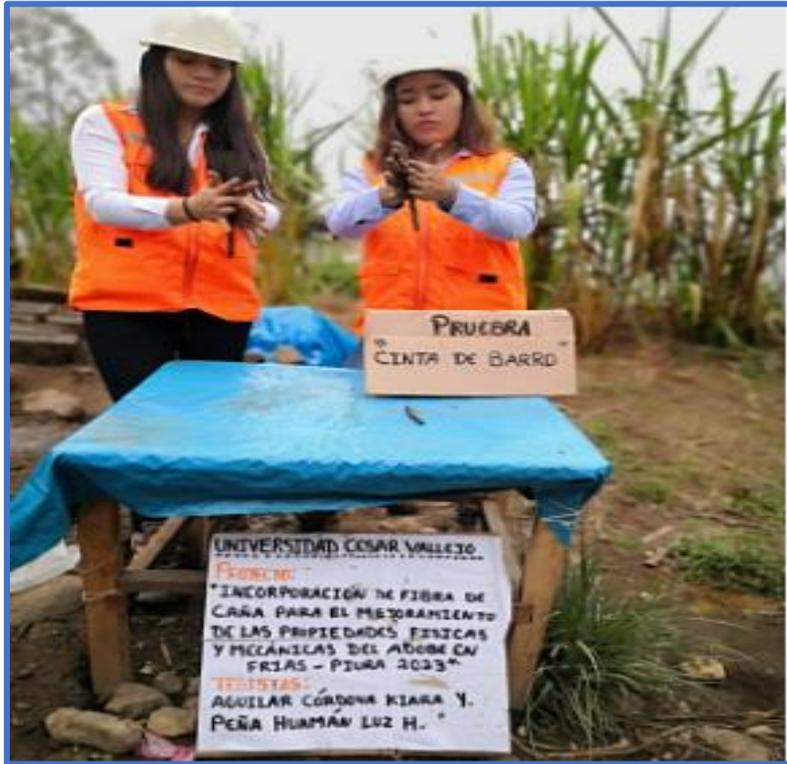
Figura N°10: Prueba “Cinta de Barro”
