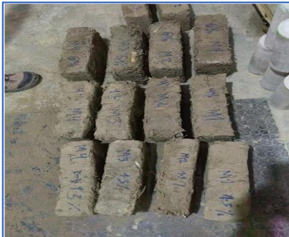
Figura N°23: Selección de muestras de adobe para ensayo de resistencia a la flexión
