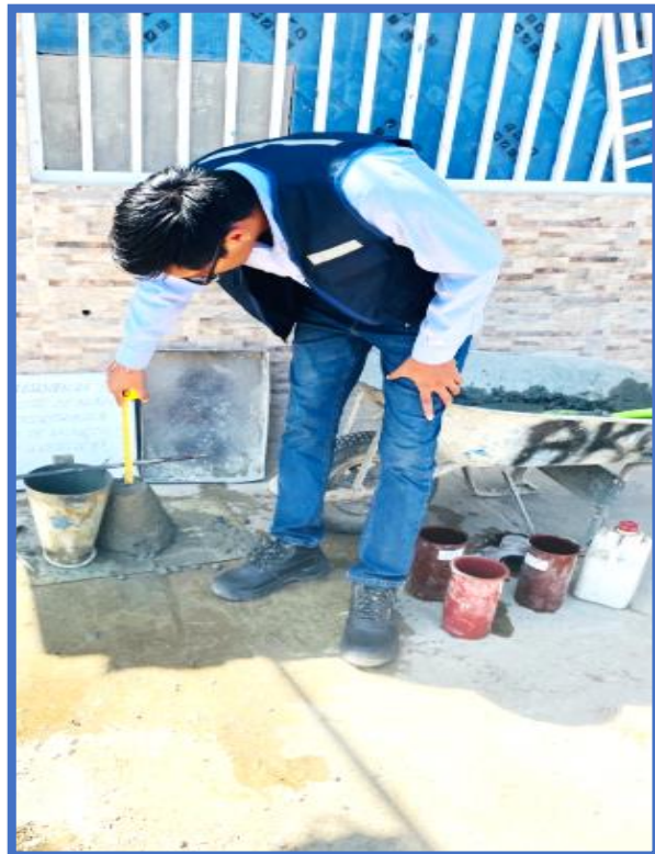
Fotografía N°14 – Dosificación, preparación de mezcla, ensayos de Slump y resistencia
