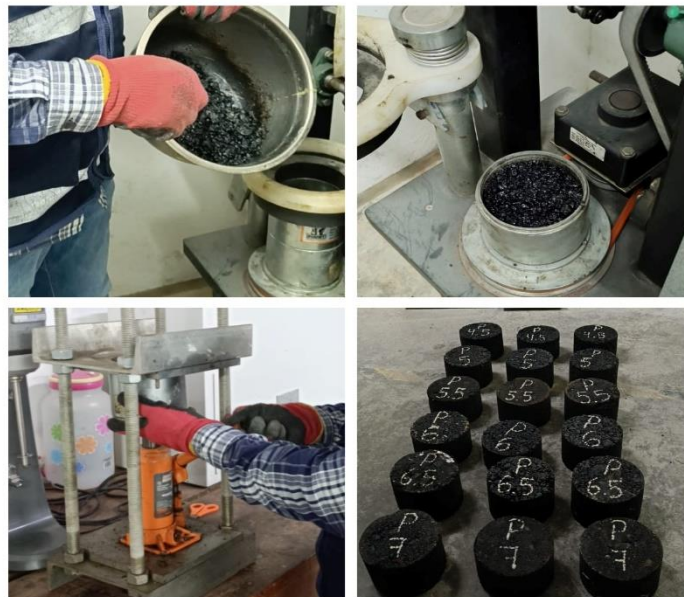
figura 7. Compactación y elaboración de briquetas
