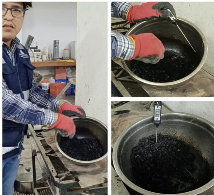
figura 6. Mezcla de agregados y betún a 140 c°
