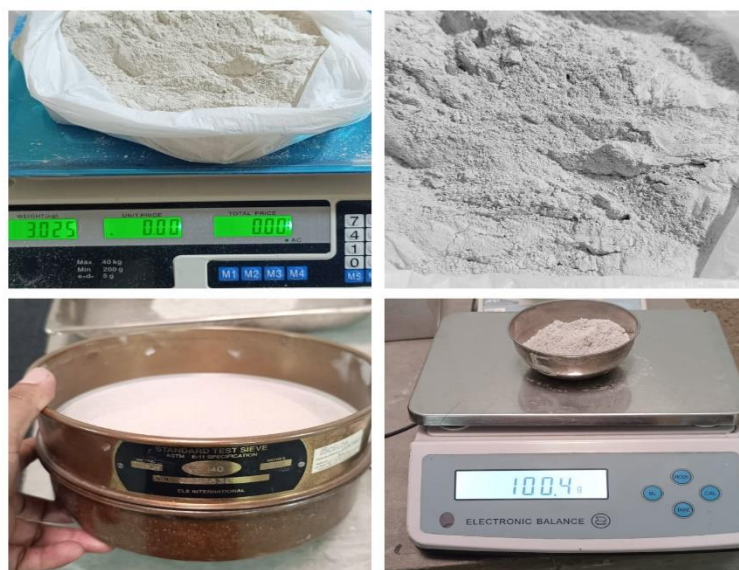
figura 5. Espécimen en filler de \text{CaCO}_3 pasante por malla n° 140
