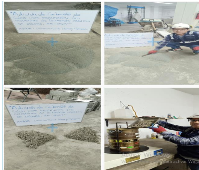
figura 4. Cuarteo de material y granulometría
