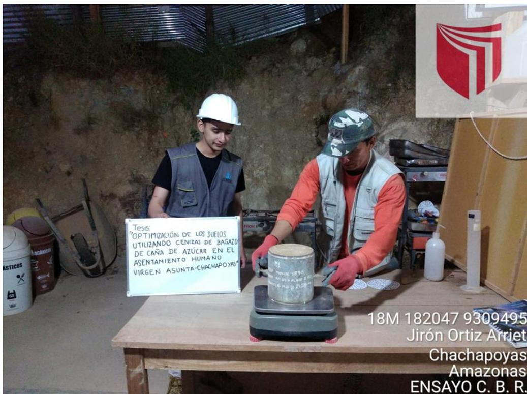
Figura 47. Ensayo CBR de la muestra SA-95+SBA-5
