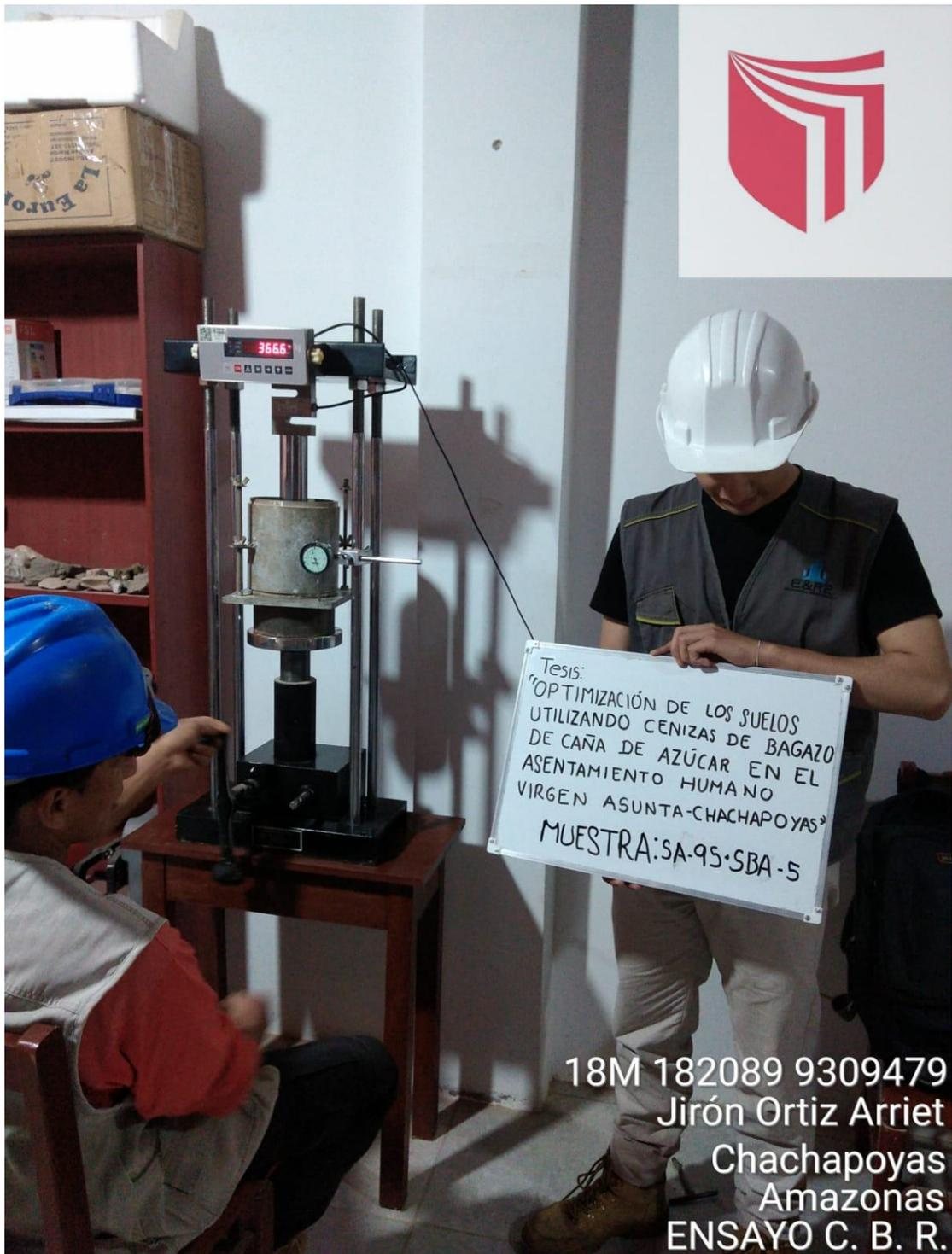
Figura 48. Ensayo CBR de la muestra SA-85+SBA-15
