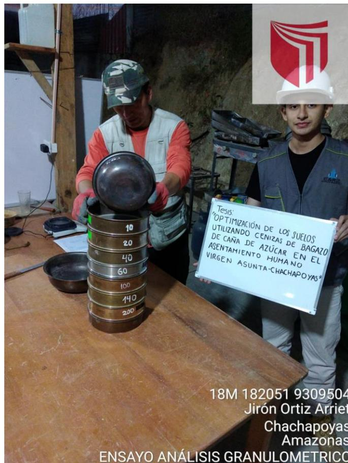
Figura 35. Ensayo de análisis granulométrico SA-75+SBA-25
