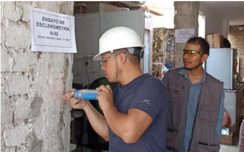
Figura 4. Esclereometria in situ
