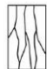
Tipo 3 Fisuras verticales encolumnadas a través de ambos extremos, conos no bien formados
