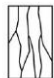
Tipo 3 Fisuras verticales en columnas a través de ambos extremos, conos no bien formados
