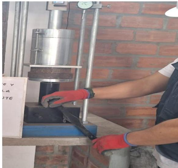
**Figuras 23.** Se procede a iniciar la penetración
