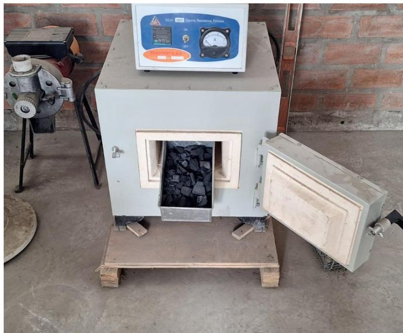
**Figuras 126.** Incineración de Carbón Industrial
