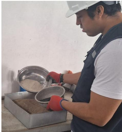
**Figuras 17.** Mezcla de C.V y C.C.A
