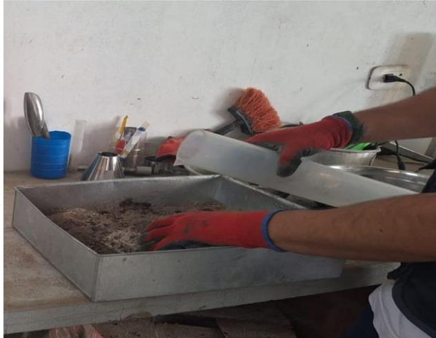
**Figuras 25.** Mezcla de muestra, agua y C.V + C.C.A
