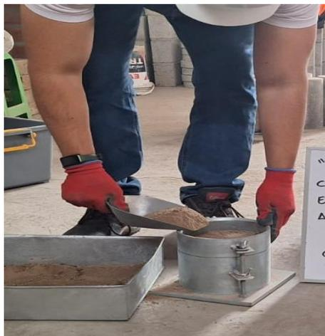
**Figuras 18.** Colocación del collarín y el disco espaciador
