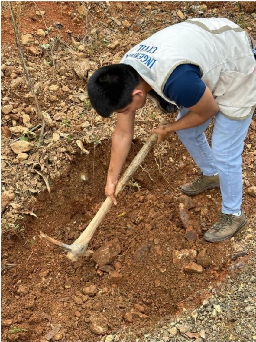
OBTENCION DE MUESTRAS DE SUELOS ATRAVES DE CALICATAS
