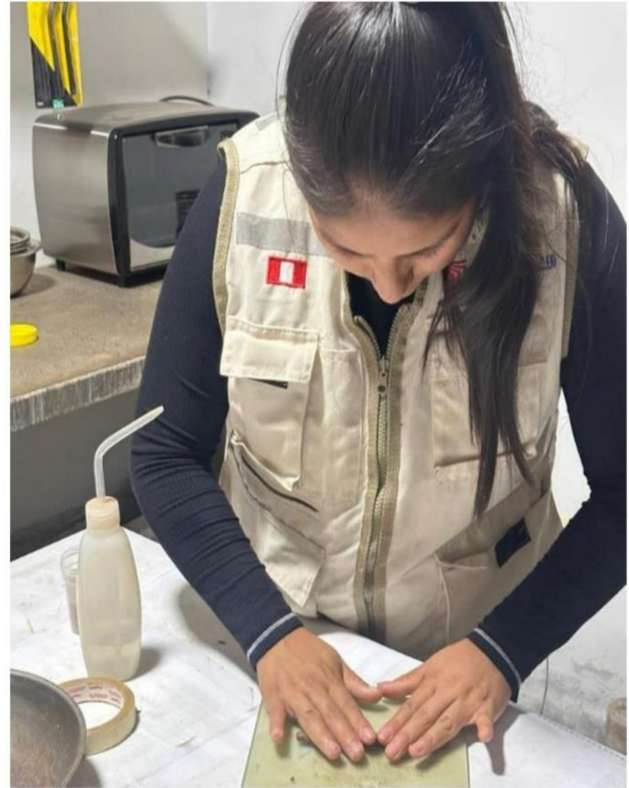
RODADURA DE LOS ROLLOS HUMEDOS
