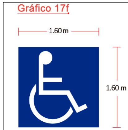
Figura 3. Señalización horizontal para espacios de estacionamiento vehicular.
