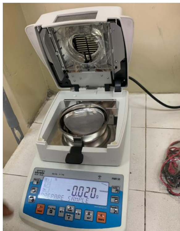
Imagen 6: Preparación de la balanza donde será medida la ceniza de cascara de arroz.
