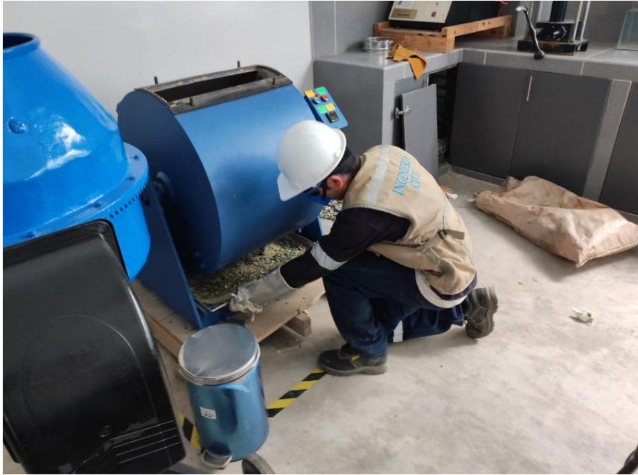
Imagen 3: Molienda del vidrio reciclado en maquina de Abrasión de los Angeles.
