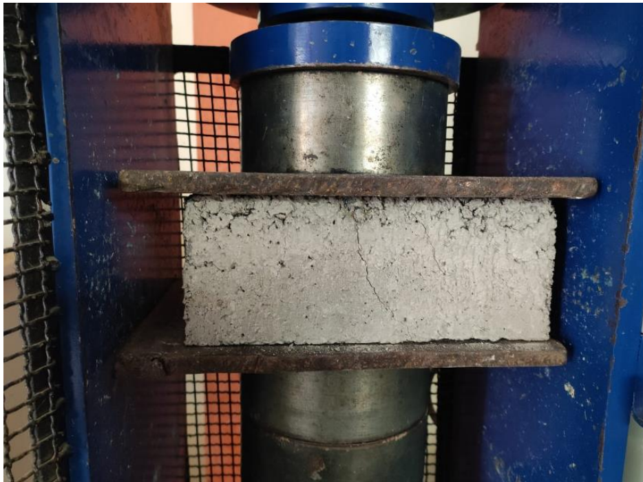
Imagen 12: Falla del ladrillo a ser sometido a una fuerza de compresión.
