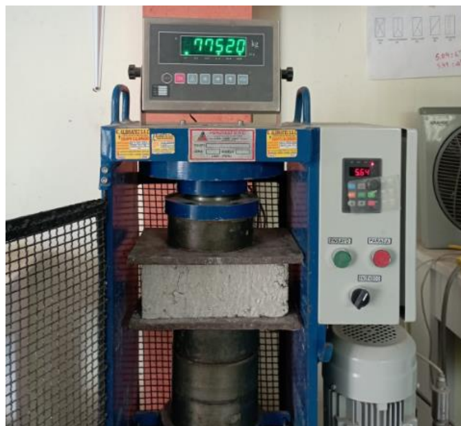
Imagen 14: Falla del ladrillo a ser sometido a una fuerza de compresión.
