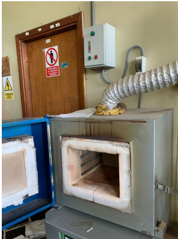
Imagen 5: Preparación de horno para la quema controlada de la cascara de arroz.
