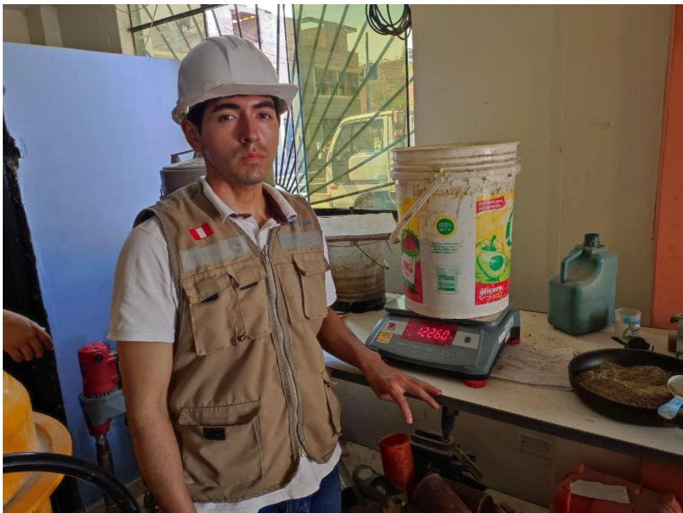
Imagen 8: Pesado de los agregados para su posterior ensayo granulométrico.
