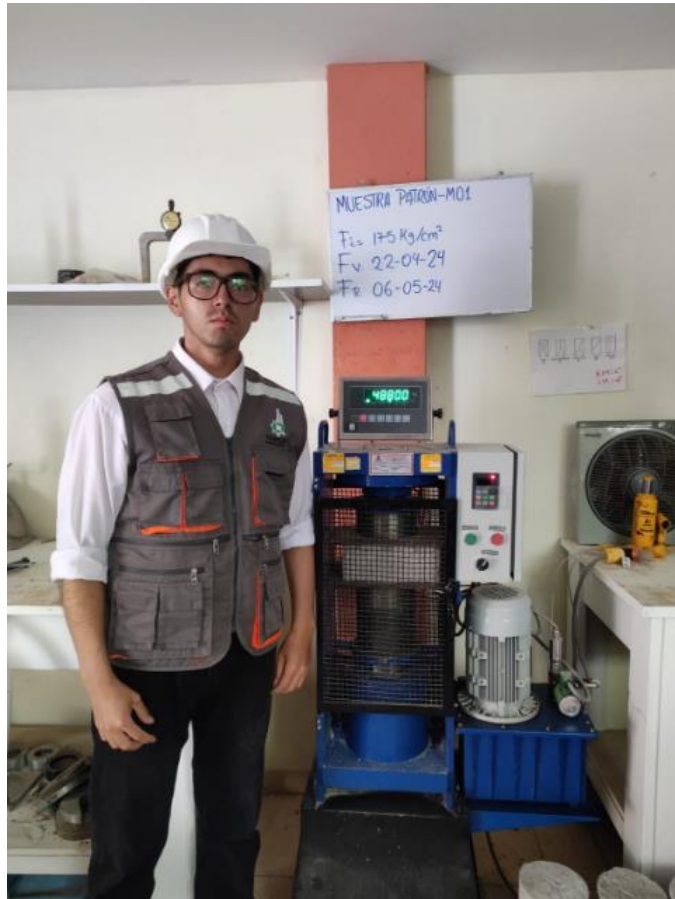
Imagen 13: Ensayo de compresión a los 14 días de curado.
