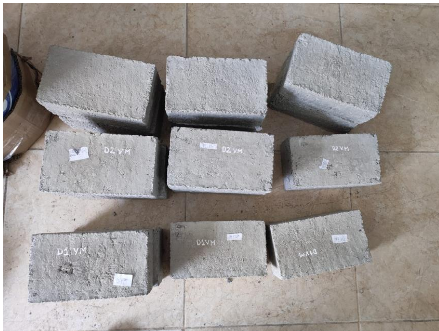
Imagen 10: Habilitado de las muestras de ladrillos con sus diferentes dosificaciones.
