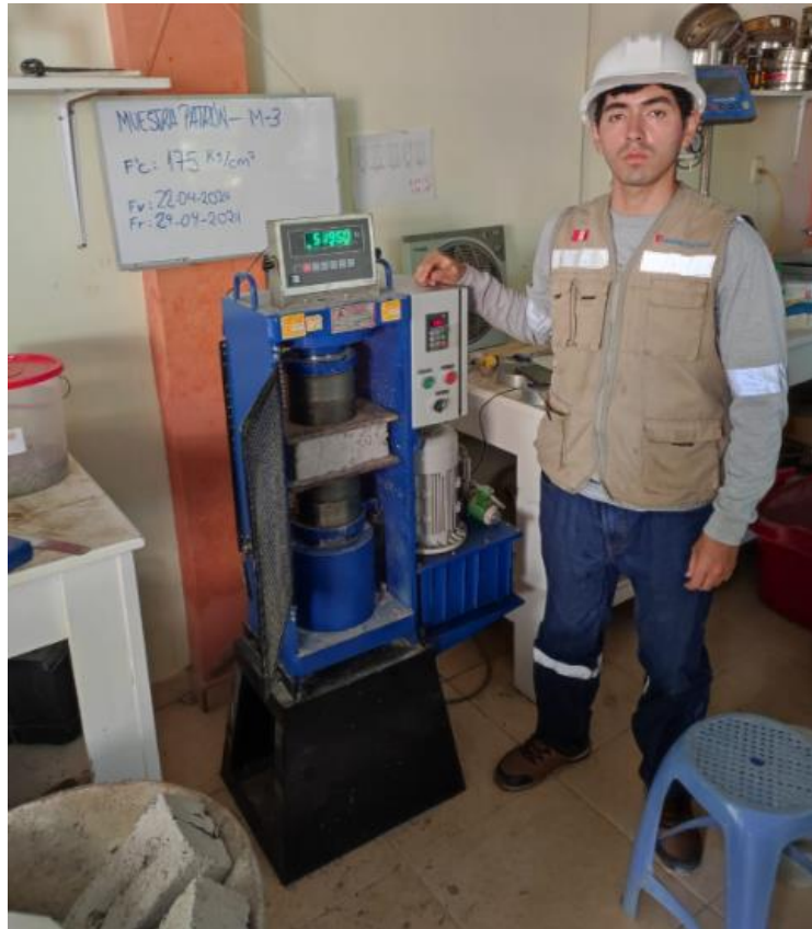
Imagen 11: Ensayo de compresión a los 7 días de curado
