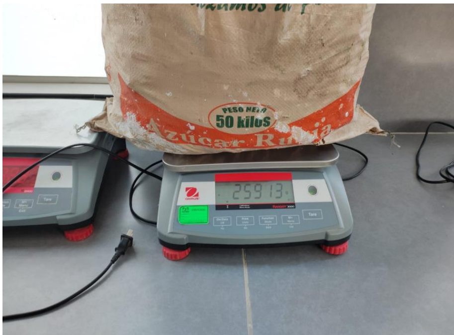
Imagen 4: Pesado del vidrio triturado
