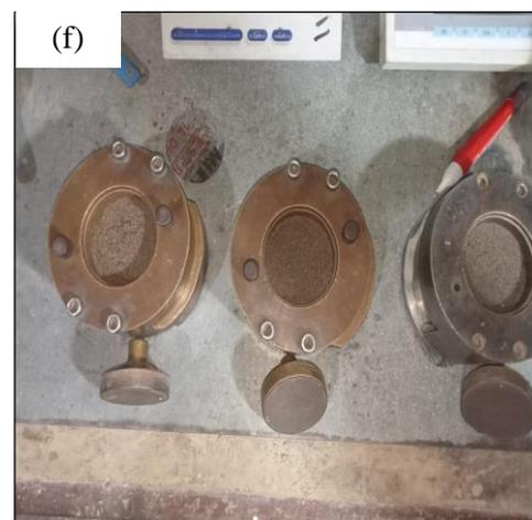
Fotografía 9. Corte Directo - En la imagen (a), se observa el equipo para el tallado de la muestra, en la imagen (b), se observa la piedra porosa, en la imagen (c), se observa la caja de corte con el material a ensayar, en la imagen (d), se observa realizando el ensayo, en la imagen (e), se muestra el equipo de corte directo y en la imagen (f), se observa el resultado del ensayo.
