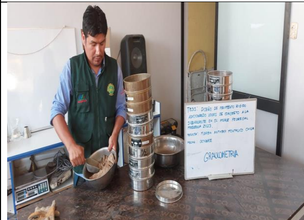
Figura 30. Ensayo de análisis granulométrico
