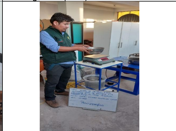
Figura 37. Obtención del valor de peso específico de los lodos de concreto
