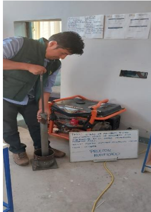
Figura 14. Compactación de las muestras
