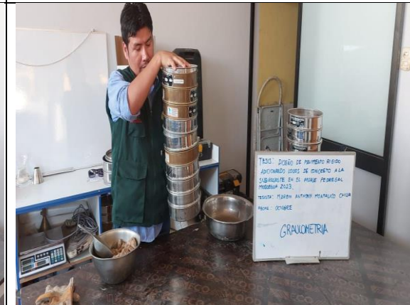
Figura 31. Ensayo de análisis granulométrico
