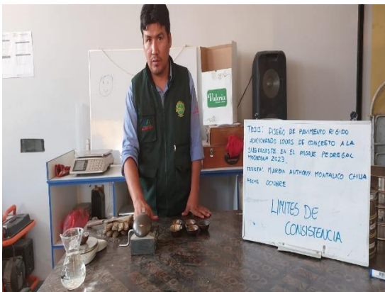
Figura 11. Ensayo de límite plástico
