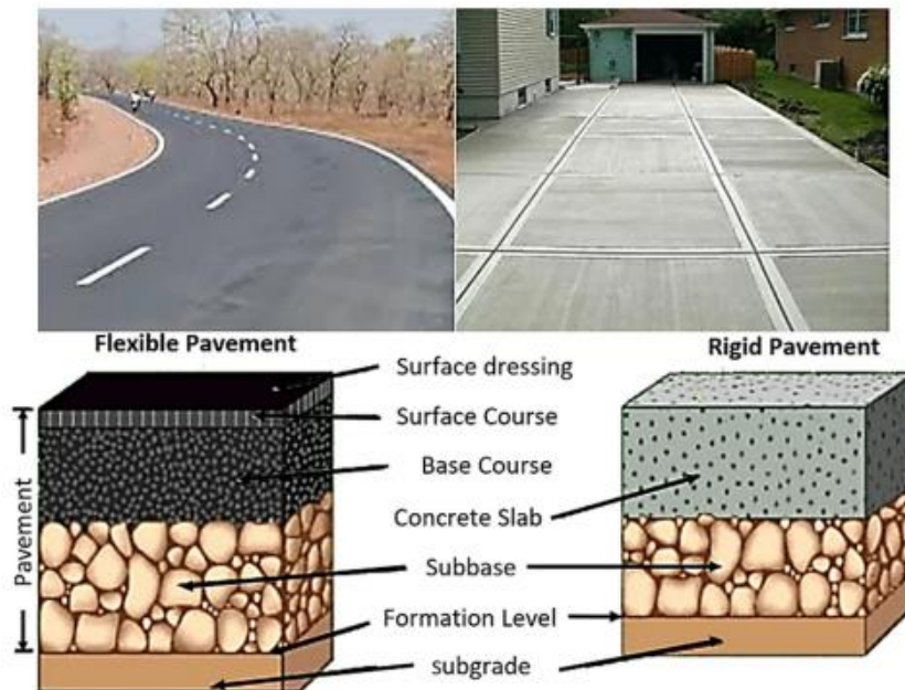
Figura 2. Diferencias entre un pavimento flexible y rígido
