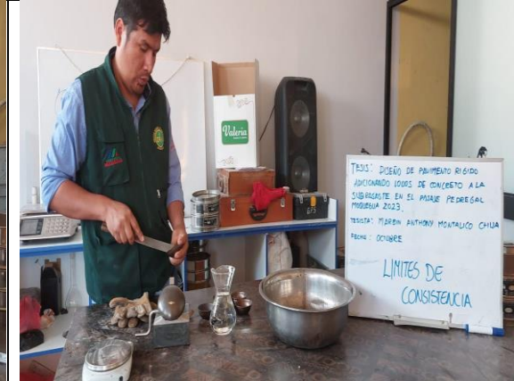
Figura 29. Ensayos de límites de consistencia
