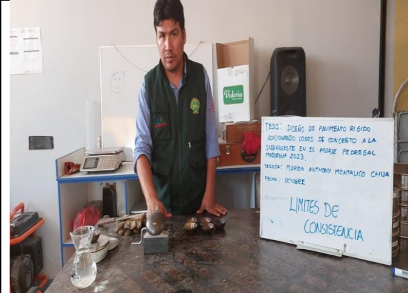
Figura 28. Ensayo de límites de consistencia
