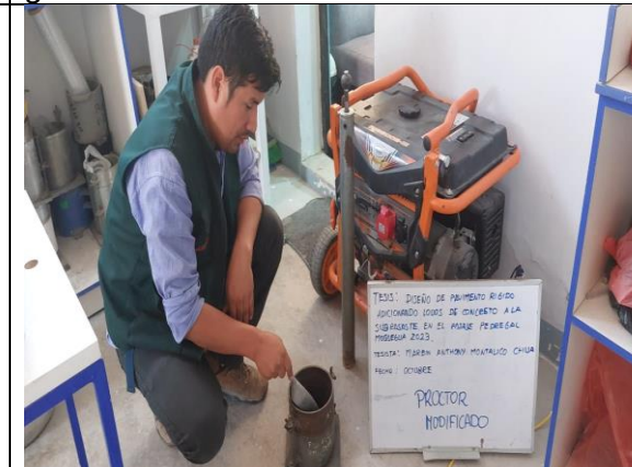
Figura 33. Ensayo de Proctor modificado
