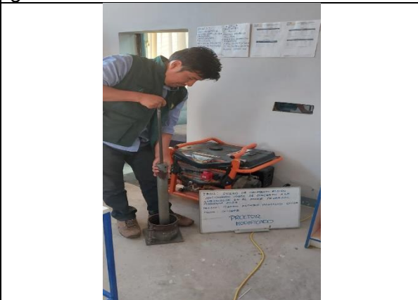
Figura 32. Ensayo de Proctor modificado
