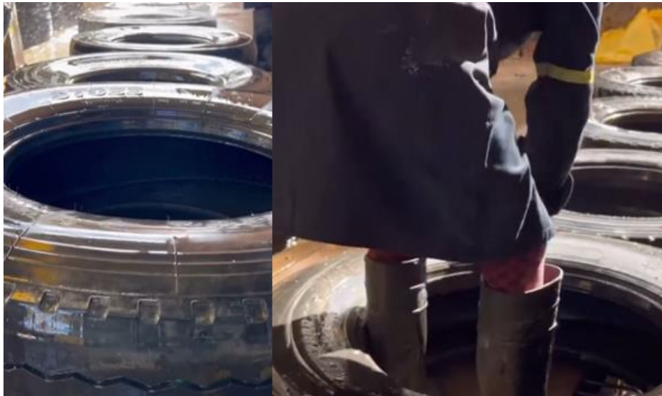
Figura 4. Lavado y cepillado de llantas
