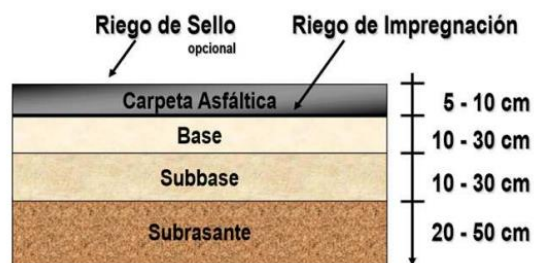
Figura 1. Estructura del pavimento flexible
