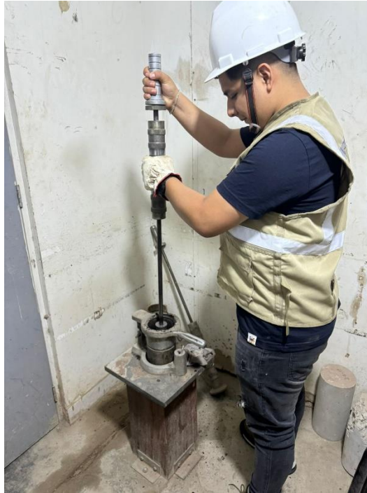
Figura 25. Compactación específica de golpes (típicamente 75 golpes).
