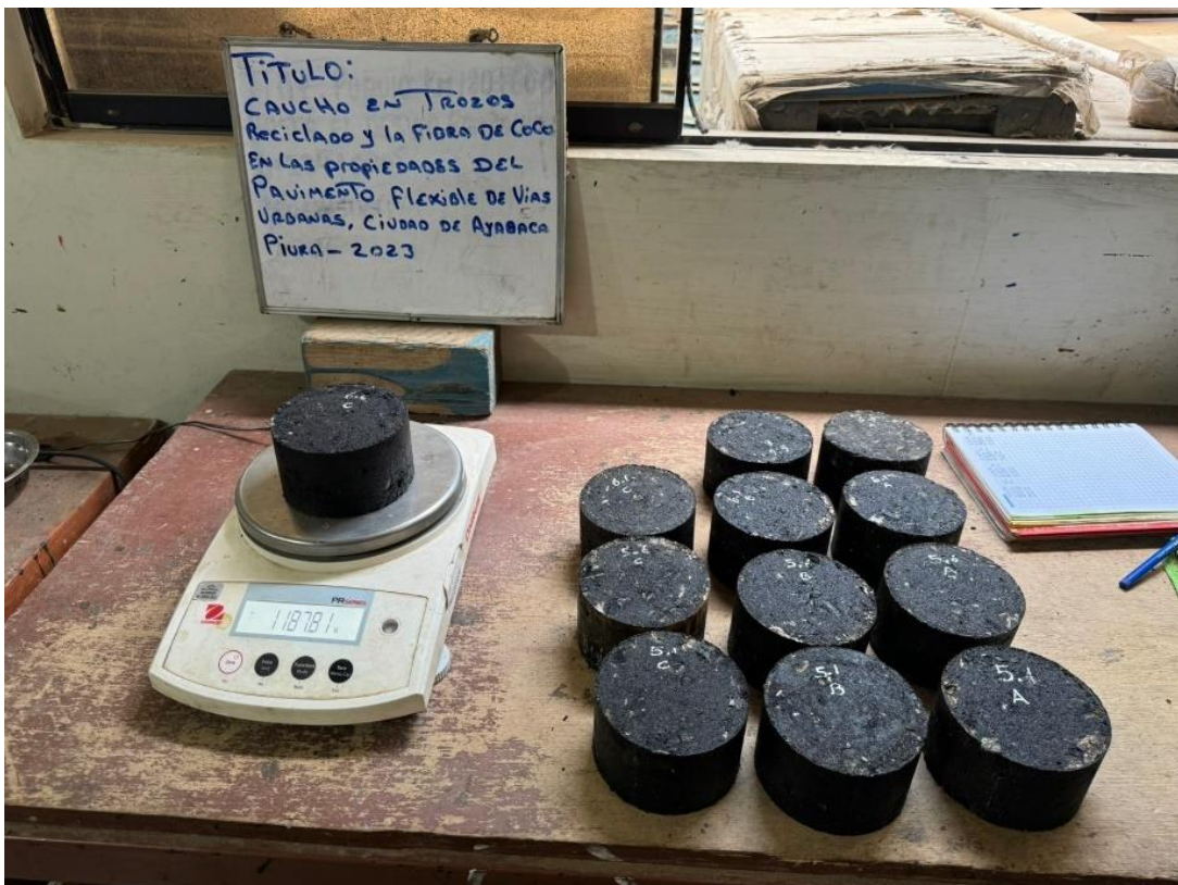
Figura 38. Dimensión de las briquetas patrón, diámetro 101.6mm y espesor 63.5mm
