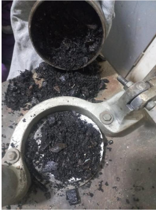
Figura 27. La dosificación D5 no tiene conexión no compacta, el % de caucho es demasiado
