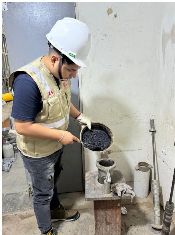
Figura 24. Colocación aproximada de 1,200 gramos de mezcla en el molde
