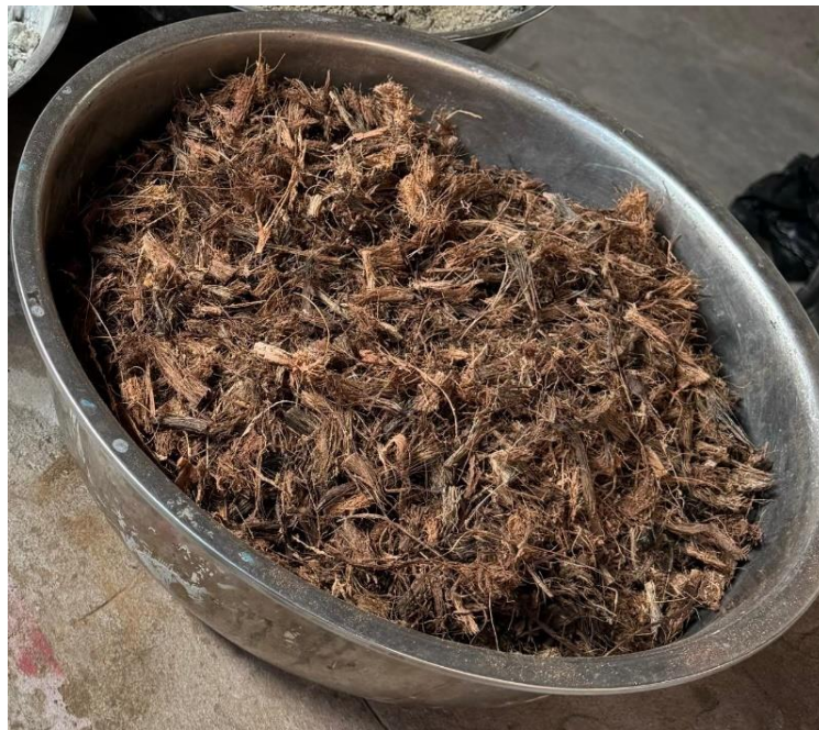
Figura 13. Tamaño de la fibra de coco 2-2.5 cm
