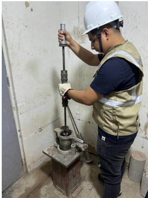
Figura 26. Compactación específica de 75 golpes mas
