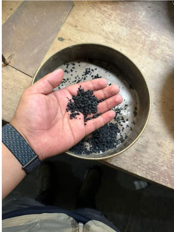
Figura 8. Caucho en gránulos pasante malla N° 10
