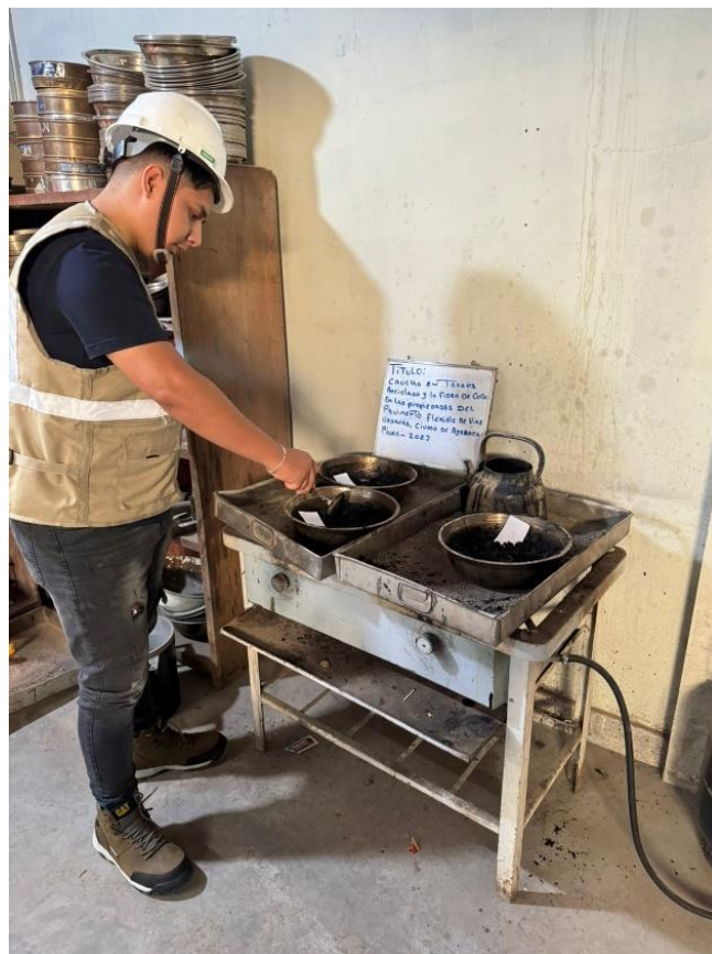
Figura 22. Calentamiento de la mezcla patrón de 175 a 190 grados
