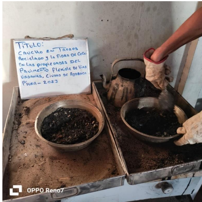
Figura 23. Calentamiento de la mezcla con dosificaciones 175 a 190 grados
