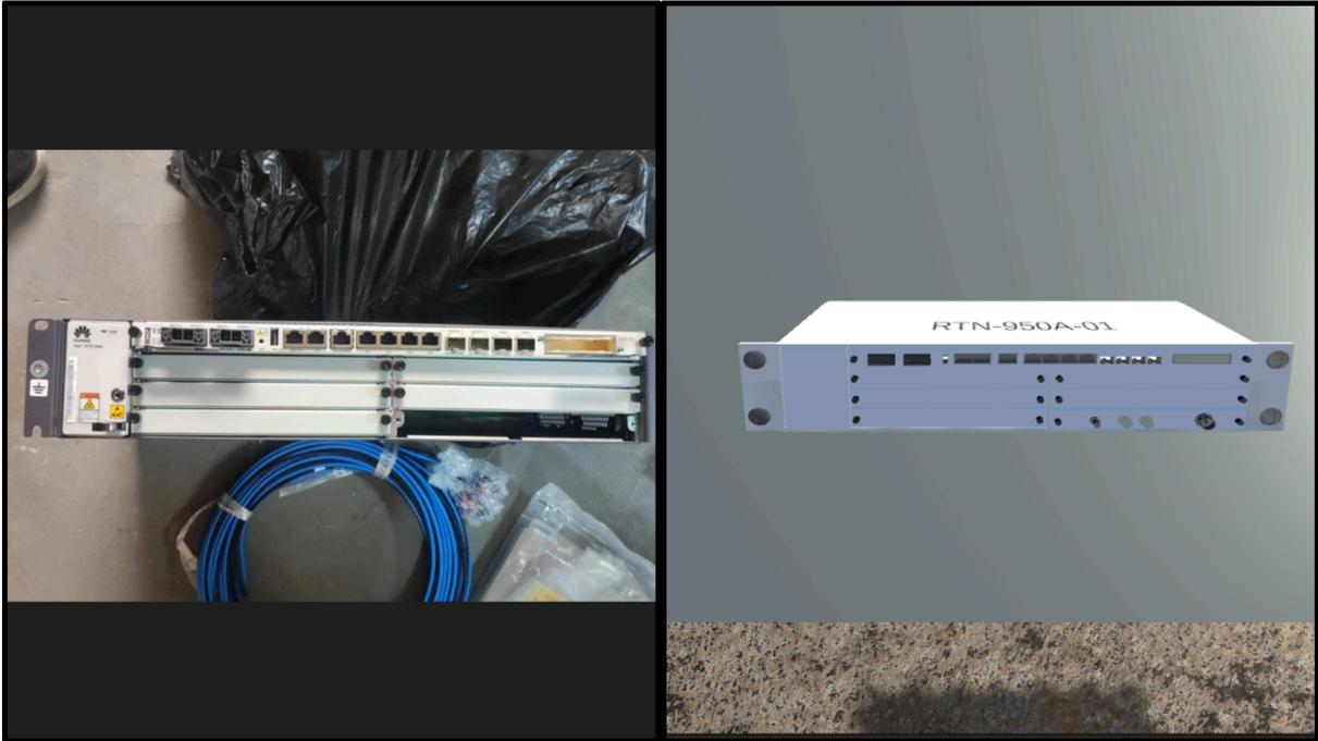
**Figura N° 19: Comparación de equipo modelado en 3D y equipos reales, Unidad de distribución de energía - DCDU-12B**
