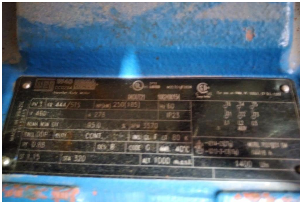
Figura C – 2: Placa característica del motor de 250 HP
