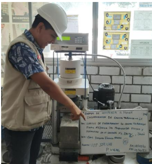
Figura N°87: Ensayo de resistencia a flexión, con incorporación del 6% de caucho triturado, 14 días, 2023. Fuente: Elaboración propia
