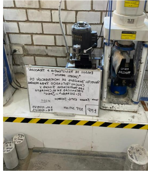
Figura N°54: Ensayo de resistencia a tracción, concreto patrón, 28 días, 2023.
