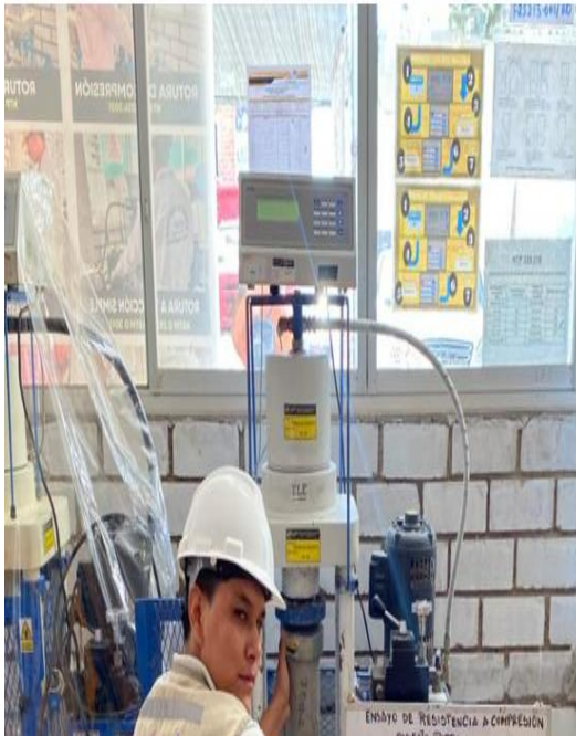
Figura N°57: Ensayo de resistencia a compresión, con incorporación del 1% caucho triturado, 7 días, 2023. Fuente: Elaboración propia
