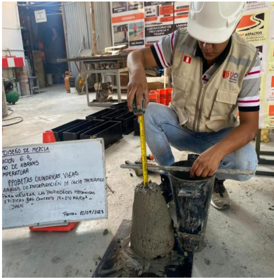
Figura N°33: Ensayo de slump, incorporación de caucho triturado 6%, 2023.
