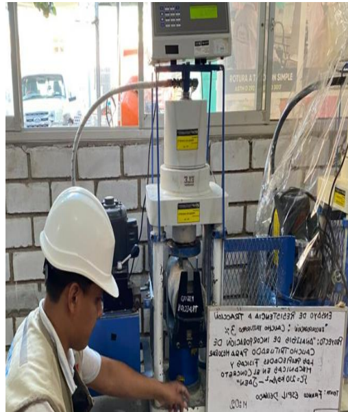
Figura N°70: Ensayo de resistencia a tracción, con incorporación del 3% de caucho triturado, 7 días, 2023. Fuente: Elaboración propia
