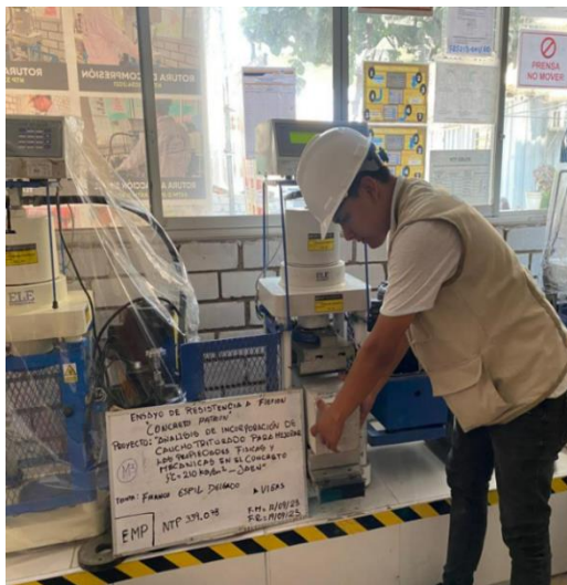
Figura N°47: Ensayo de resistencia a flexión, concreto patrón, 7 días, 2023. Fuente: Elaboración propia
