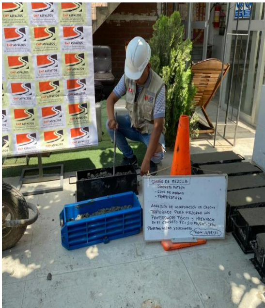
Figura N°21: Elaboración de probetas, del concreto patrón, 2023.
