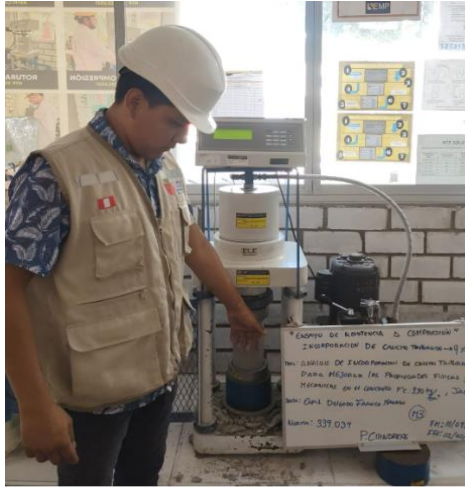
Figura N°93: Ensayo de resistencia a compresión, con incorporación del 9% de caucho triturado, 7 días, 2023. Fuente: Elaboración propia
