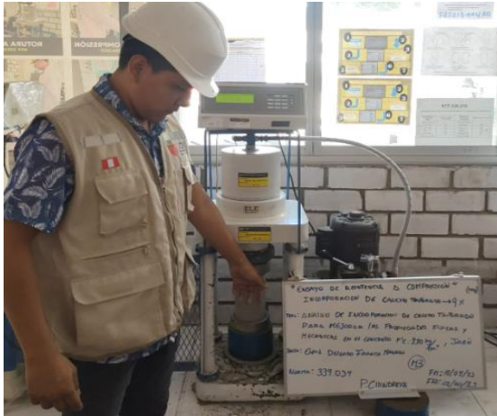
Figura N°97: Ensayo de resistencia a compresión, con incorporación del 9% de caucho triturado, 14 días, 2023. Fuente: Elaboración propia
