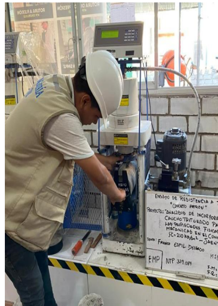
Figura N°46: Ensayo de resistencia a tracción, concreto patrón, a los 7 días, 2023. Fuente: Elaboración propia
