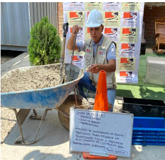
Figura N°19: Ensayo de temperatura, del concreto patrón, 2023. Fuente: Elaboración propia
