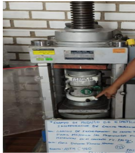
Figura N°96: Ensayo de elasticidad, con incorporación del 9% de caucho triturado, 7 días, 2023. Fuente: Elaboración propia
