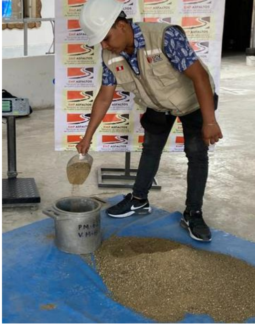
Figura N°13: Ensayo de Peso específico, agregado fino, 2023. Fuente: Elaboración propia
