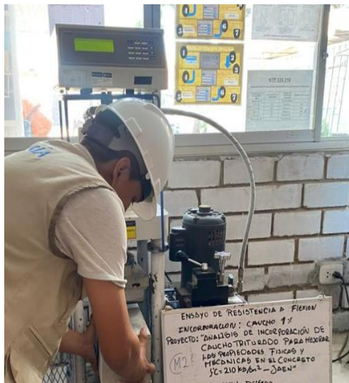
Figura N°67: Ensayo de resistencia a flexión , con incorporación del 1% de caucho triturado ,28 días, 2023. Fuente: Elaboración propia
