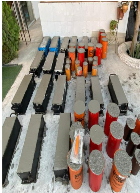
Figura N°22 : Elaboración de probetas, del concreto patrón, 2023.
