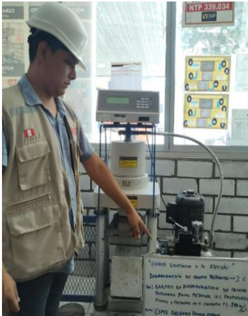
Figura N°79: Ensayo de resistencia a flexión, con incorporación del 3% de caucho triturado, 28 días, 2023. Fuente: Elaboración propia
