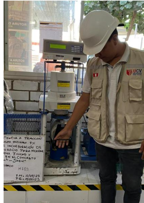
Figura N°58: Ensayo de resistencia a tracción, con incorporación del 1% caucho triturado, 7 días, 2023. Fuente: Elaboración propia
