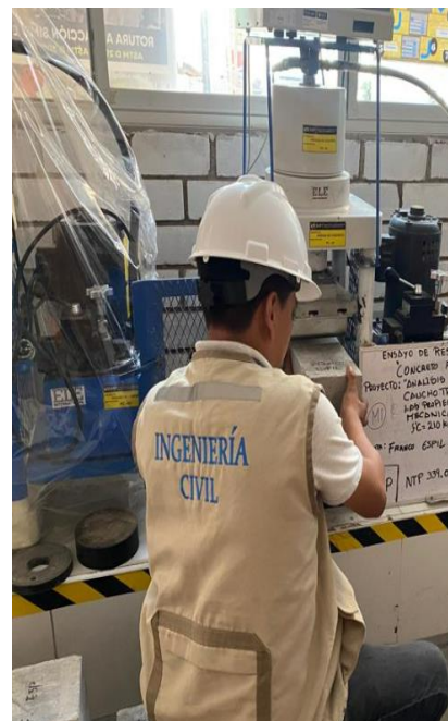
Figura N°52: Ensayo de resistencia a flexión, concreto patrón, 14 días, 2023. Fuente: Elaboración propia
