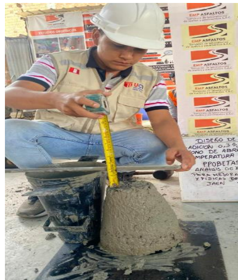
Figura N°30: Ensayo de slump, incorporación de caucho triturado 3%, 2023.
