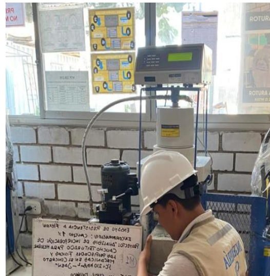
Figura N°68: Ensayo de resistencia a flexión , con incorporación del 1% de caucho triturado ,28 días, 2023. Fuente: Elaboración propia
