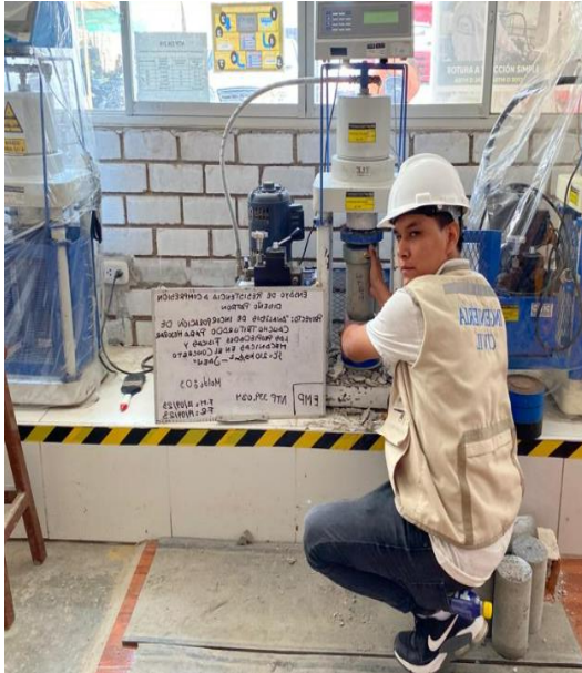
Figura N°49: Ensayo de resistencia a compresión, concreto patrón, 14 días, 2023. Fuente: Elaboración propia
