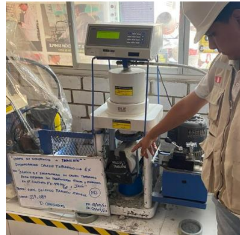
Figura N°90: Ensayo de resistencia a tracción, con incorporación del 6% de caucho triturado, 28 días, 2023. Fuente: Elaboración propia
