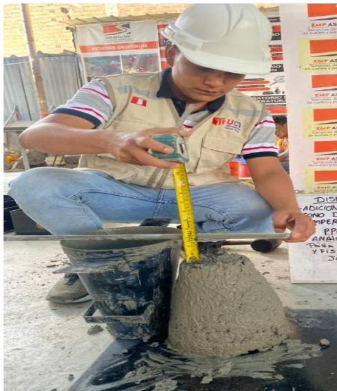
Figura N°23: Ensayo de slump, incorporación de caucho triturado 1%, 2023.
