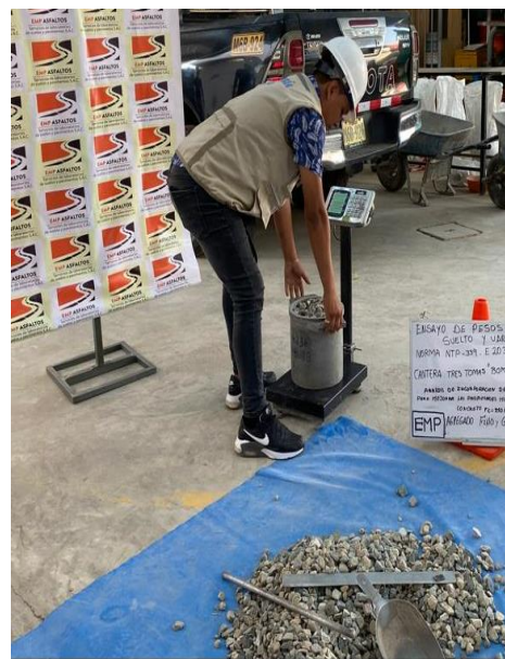
Figura N°12: Ensayo de Peso específico, agregado grueso, 2023 Fuente: Elaboración propia.
