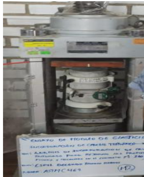
Figura N°80: Ensayo de elasticidad, con incorporación del 3% de caucho triturado, 28 días, 2023. Fuente: Elaboración propia
