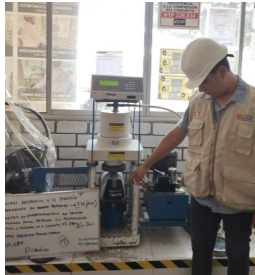
Figura N°74: Ensayo de resistencia a tracción, con incorporación del 3% de caucho triturado, 14 días, 2023.
