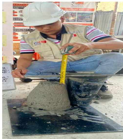
Figura N°24: Ensayo de slump, incorporación de caucho triturado 1%, 2023.
