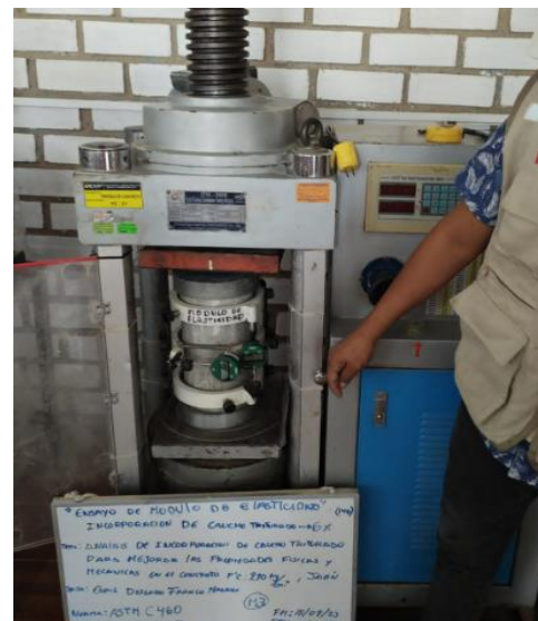
Figura N°88: Ensayo de elasticidad, con incorporación del 6% de caucho triturado, 14 días, 2023. Fuente: Elaboración propia
