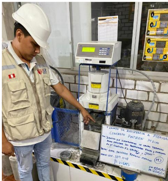
Figura N°51: Ensayo de resistencia a flexión, concreto patrón, 14 días, 2023. Fuente: Elaboración propia
