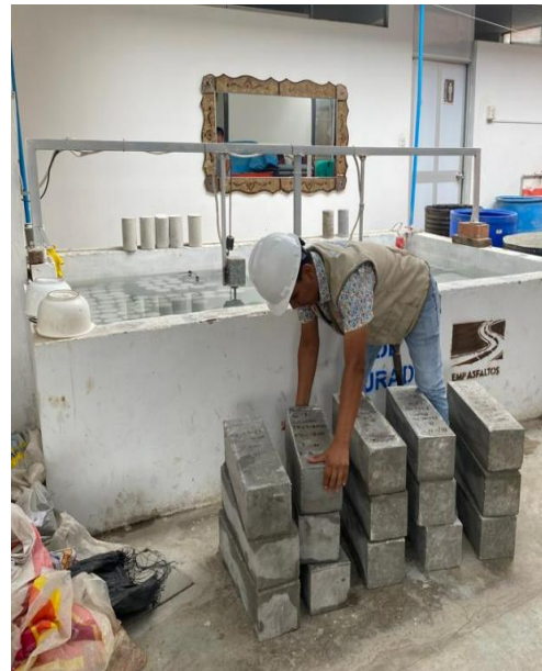
Figura N°44: CHICLAYO. Curado de las probetas a los 7,14 y 28 días, 2023. Fuente: Elaboración propia
