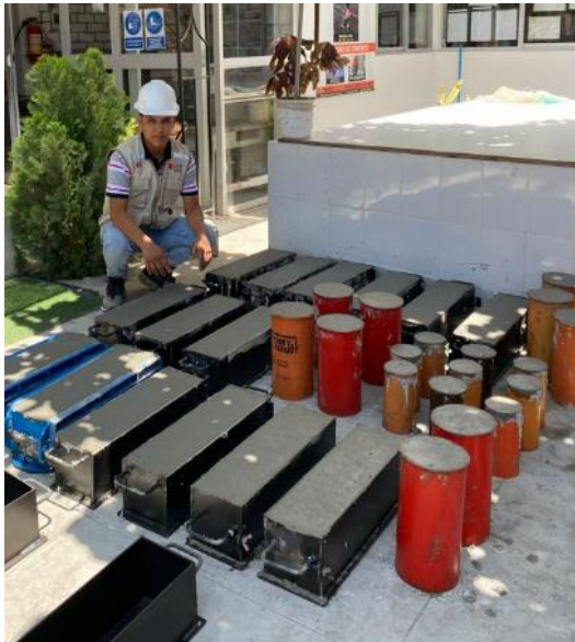
Figura N°31: Probetas, incorporación de caucho triturado del 3%, 2023.
