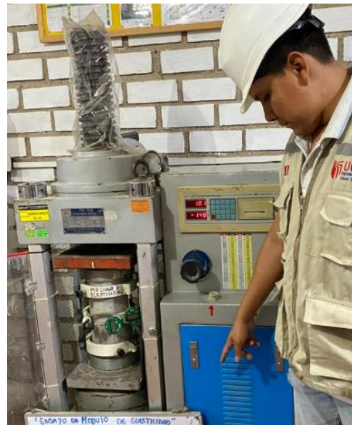
Figura N°56: Ensayo de módulo de elasticidad, concreto patrón, 28 días, 2023
