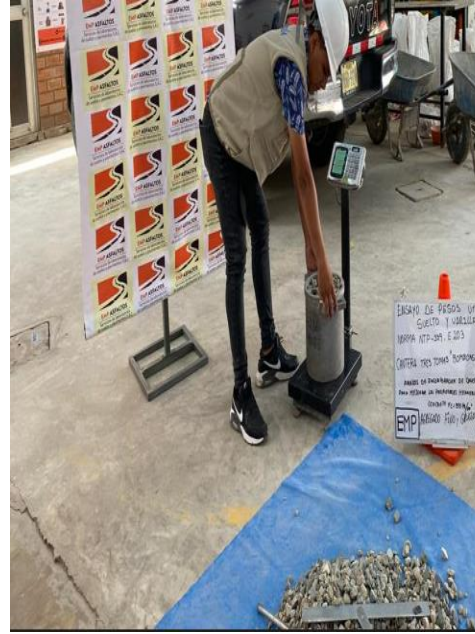
Figura N°10: Ensayo de Peso específico, agregado grueso, 2023 Fuente: Elaboración propia.
