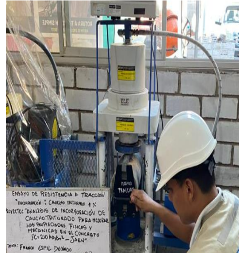
Figura N°66: Ensayo de resistencia a tracción, con incorporación del 1% de caucho triturado ,28 días, 2023. Fuente: Elaboración propia
