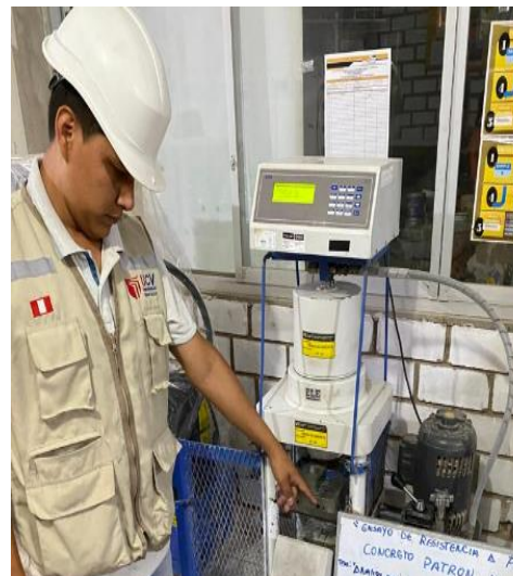
Figura N°48: Ensayo de resistencia a flexión, concreto patrón, 7 días, 2023. Fuente: Elaboración propia
