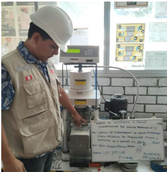
Figura N°99: Ensayo de resistencia a flexión, con incorporación del 9% de caucho triturado, 14 días, 2023. Fuente: Elaboración propia
