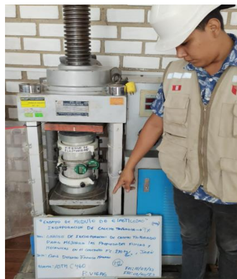
Figura N°100: Ensayo de elasticidad, con incorporación del 9% de caucho triturado, 14 días, 2023. Fuente: Elaboración propia
