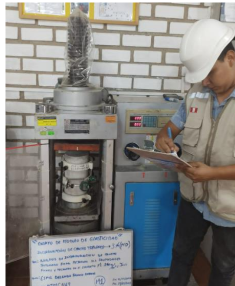
Figura N°72: Ensayo de elasticidad, con incorporación del 3% de caucho triturado, 7 días, 2023. Fuente: Elaboración propia
