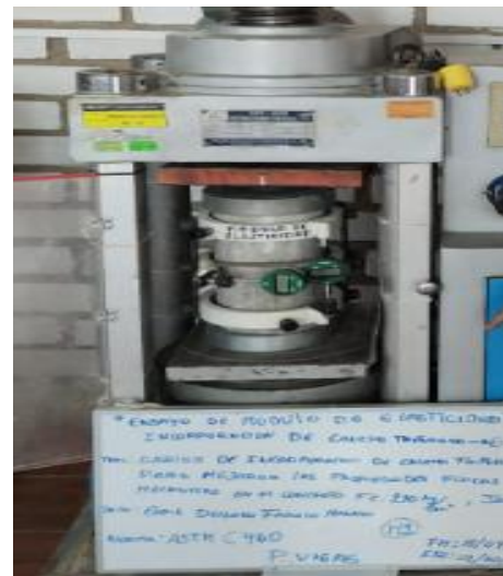
Figura N°92: Ensayo de elasticidad, con incorporación del 6% de caucho triturado, 28 días, 2023. Fuente: Elaboración propia
