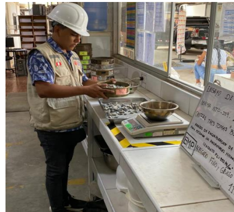
Figura N°04: Ensayo de granulometría, agregado grueso, 2023.
