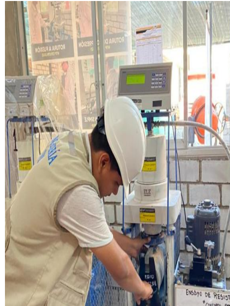
Figura N°50: Ensayo de resistencia a tracción, concreto patrón, a los ,14 días, 2023. Fuente: Elaboración propia
