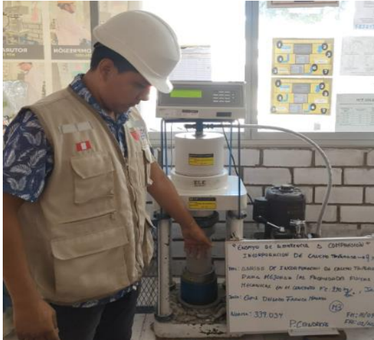
Figura N°101: Ensayo de resistencia a compresión, con incorporación del 9% de caucho triturado, 28 días, 2023. Fuente: Elaboración propia
