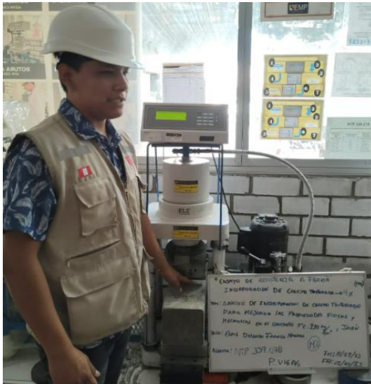
Figura N°95: Ensayo de resistencia a flexión, con incorporación del 9% de caucho triturado, 7 días, 2023. Fuente: Elaboración propia
