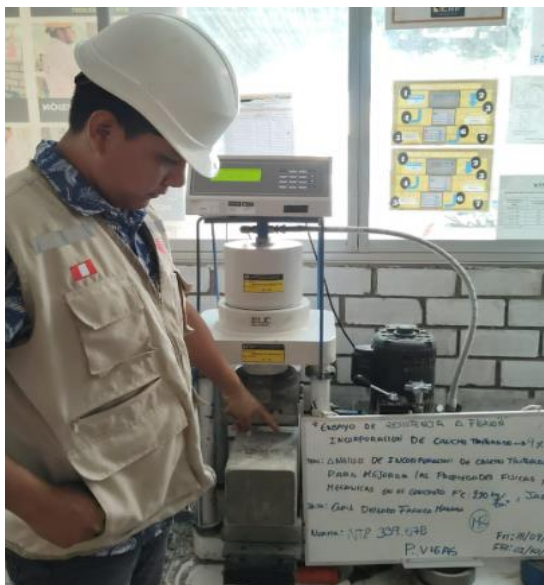
Figura N°103: Ensayo de resistencia a flexión, con incorporación del 9% de caucho triturado, 28 días, 2023. Fuente: Elaboración propia
