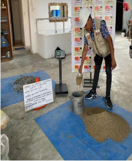
Figura N°9: Ensayo de Peso específico, agregado fino, 2023. Fuente: Elaboración propia
