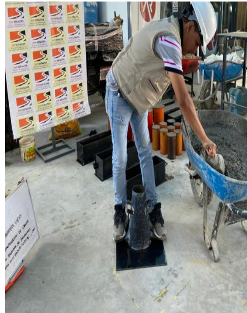
Figura N°18: Ensayo de slump, del concreto patrón, 2023. Fuente: Elaboración propia
