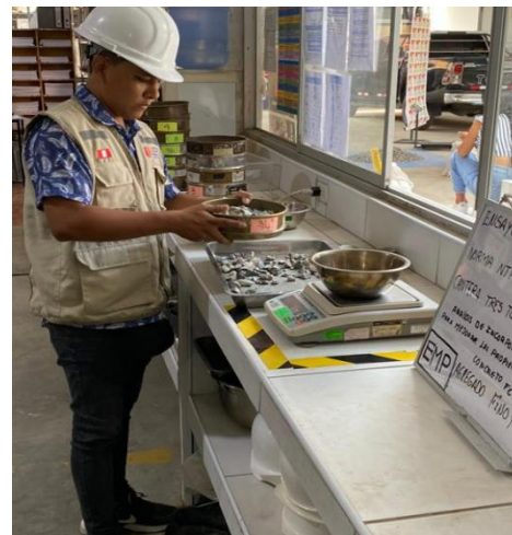
Figura N°08: Ensayo de Peso, agregado grueso, 2023. Fuente: Elaboración propia
