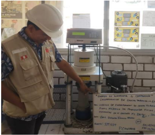
Figura N°89: Ensayo de resistencia a compresión, con incorporación del 6% de caucho triturado, 28 días, 2023. Fuente: Elaboración propia
