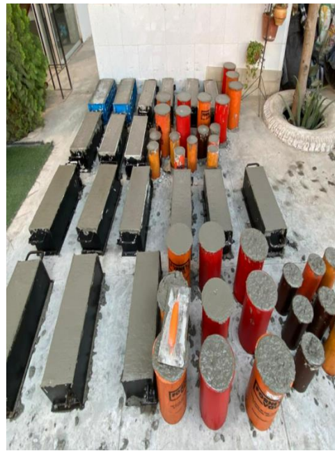
Figura N°42: Probetas, con incorporación de caucho triturado del 9%, 2023. Fuente: Elaboración propia
