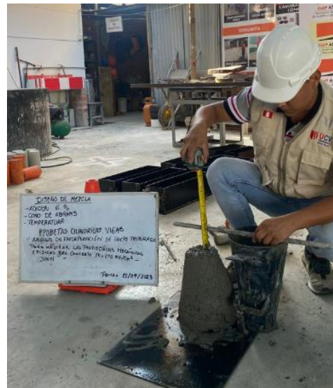
Figura N°34: Ensayo de slump, incorporación de caucho triturado 6%, 2023.
