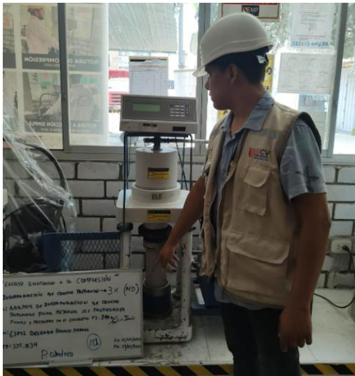
Figura N°73: Ensayo de resistencia a compresión, con incorporación del 3% de caucho triturado, 14 días, 2023.
