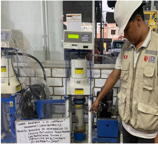
Figura N°77: Ensayo de resistencia a compresión, con incorporación del 3% de caucho triturado, 28 días, 2023. Fuente: Elaboración propia
