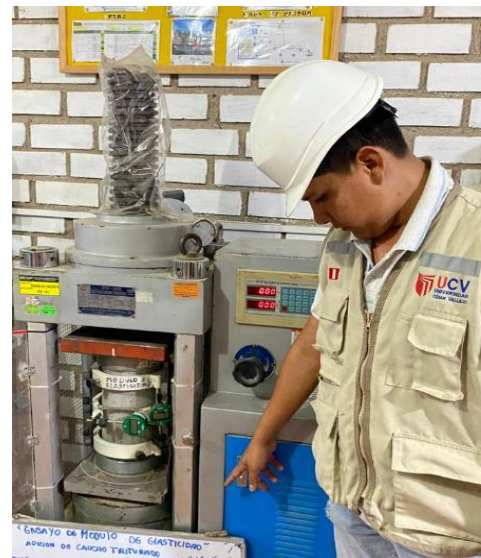
Figura N°58: Ensayo de resistencia a tracción, con incorporación del 1% caucho triturado, 7 días, 2023. Fuente: Elaboración propia
