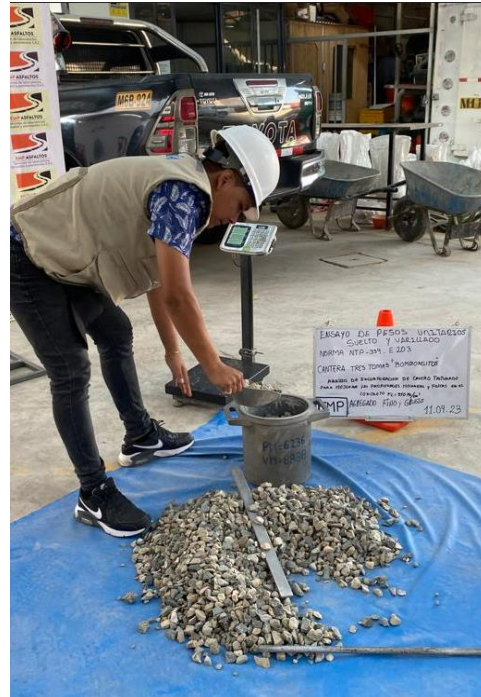
Figura N°14: Ensayo de Peso específico, agregado grueso, 2023. Fuente: Elaboración propia
