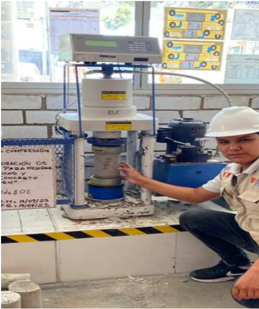
Figura N°53: Ensayo de resistencia a compresión, concreto patrón, 28 días, 2023.
