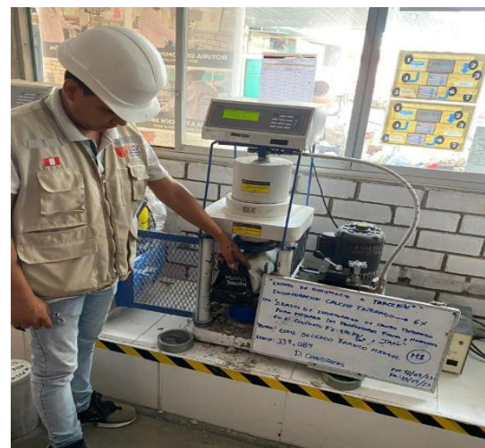
Figura N°82: Ensayo de resistencia a tracción, con incorporación del 6% de caucho triturado, 7 días, 2023. Fuente: Elaboración propia
