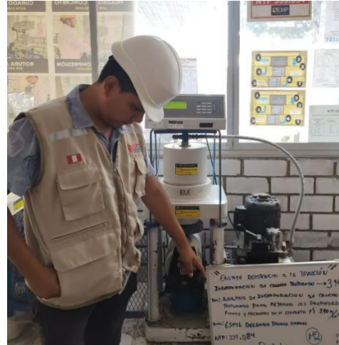
Figura N°78: Ensayo de resistencia a tracción, con incorporación del 3% de caucho triturado, 28 días, 2023. Fuente: Elaboración propia
