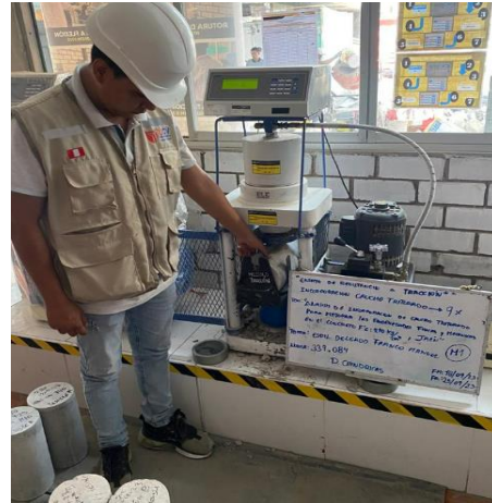
Figura N°94: Ensayo de resistencia a tracción, con incorporación del 9% de caucho triturado, 7 días, 2023. Fuente: Elaboración propia
