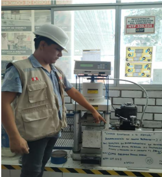
Figura N°69: Ensayo de resistencia a compresión, con incorporación del 3% de caucho triturado, 7 días, 2023. Fuente: Elaboración propia
