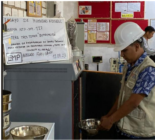
Figura N°05: Ensayo de contenido de humedad, agregado fino, 2023. Fuente: Elaboración propia
