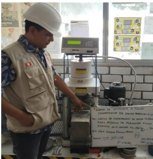
Figura N°91: Ensayo de resistencia a flexión, con incorporación del 6% de caucho triturado, 28 días, 2023. Fuente: Elaboración propia
