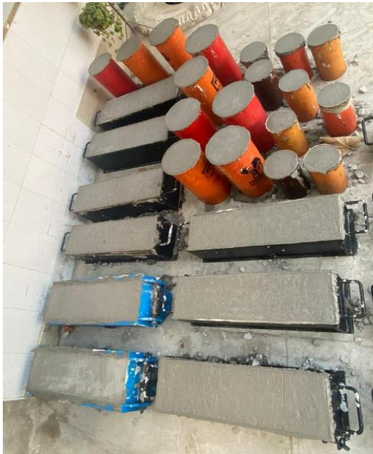
Figura N°41: Probetas, con incorporación de caucho triturado del 9%, 2023. Fuente: Elaboración propia
