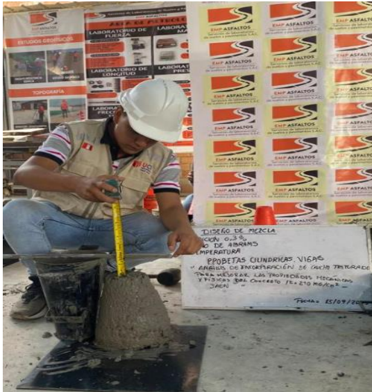
Figura N°29: Ensayo de slump, incorporación de caucho triturado 3%, 2023.
