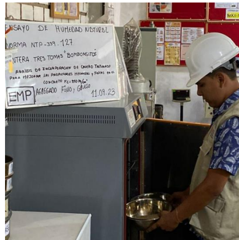
Figura N°06: Ensayo de contenido de humedad, agregado grueso, 2023 Fuente: Elaboración propia
