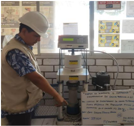
Figura N°81: Ensayo de resistencia a compresión, con incorporación del 6% de caucho triturado, 7 días, 2023. Fuente: Elaboración propia
