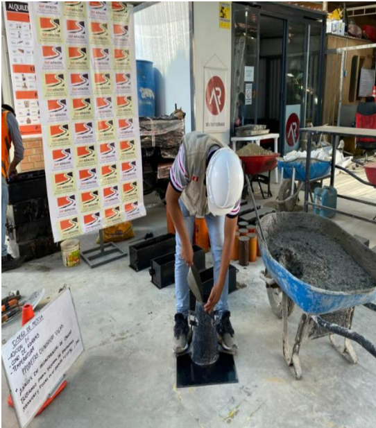
Figura N°17: Ensayo de slump, del concreto patrón, 2023. Fuente: Elaboración propia
