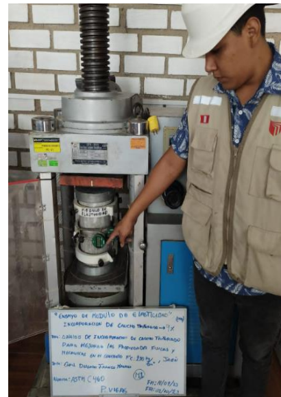
Figura N°102: Ensayo de resistencia a tracción, con incorporación del 9% de caucho triturado, 28 días, 2023. Fuente: Elaboración propia
