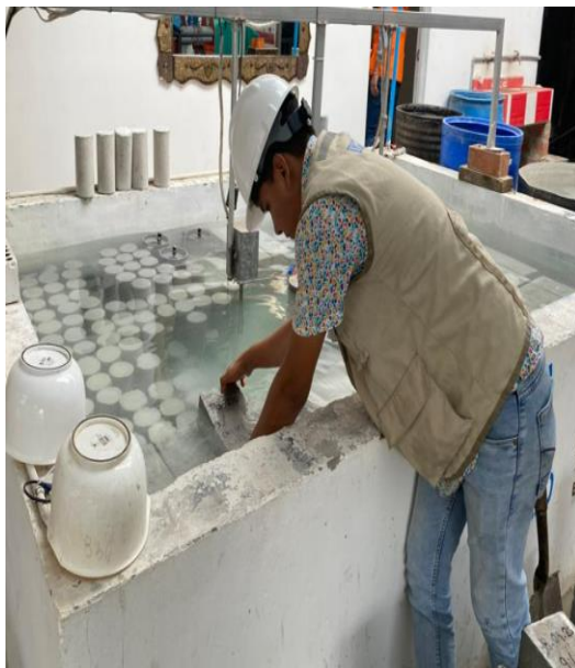
Figura N°43: Curado de las probetas, a los 7,14 y 28 días, 2023. Fuente: Elaboración propia
