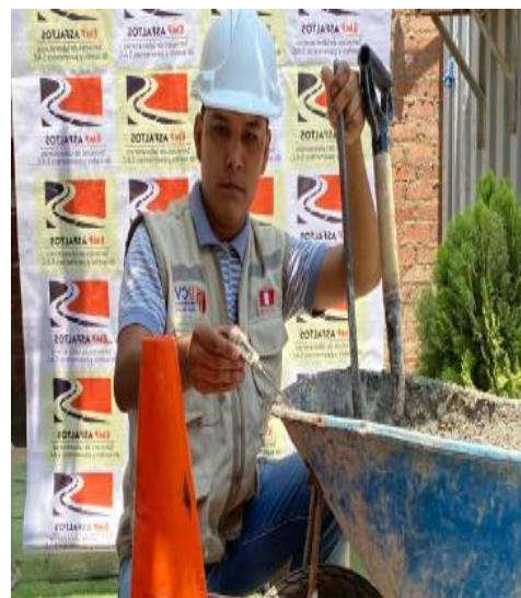
Figura N°36: Ensayo de slump, incorporación de caucho triturado 6%, 2023.
