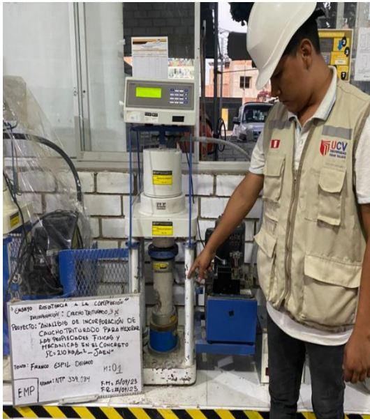
Figura N°69: Ensayo de resistencia a compresión, con incorporación del 3% de caucho triturado, 7 días, 2023. Fuente: Elaboración propia
