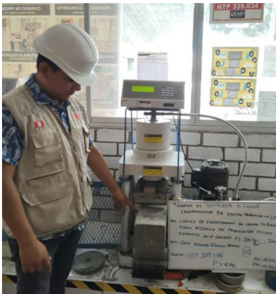
Figura N°83: Ensayo de resistencia a flexión, con incorporación del 6% de caucho triturado, 7 días, 2023.
