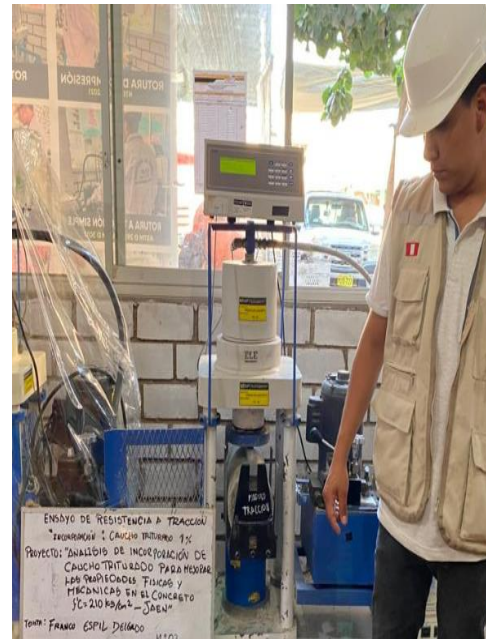
Figura N°62: Ensayo de resistencia a tracción, con incorporación del 1% caucho triturado ,14 días, 2023. Fuente: Elaboración propia
