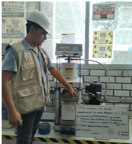
Figura N°75: Ensayo de resistencia a flexión, con incorporación del 3% de caucho triturado, 14 días, 2023.
