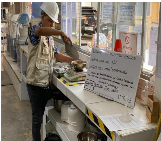
Figura N°07: Ensayo de Peso, agregado fino, 2023. Fuente: Elaboración propia
