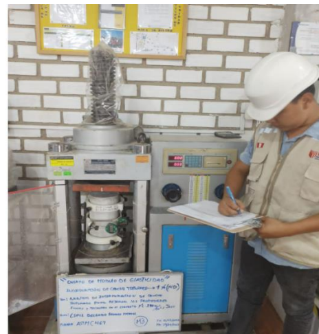
Figura N°76: Ensayo de elasticidad, con incorporación del 3% de caucho triturado, 14 días, 2023.
