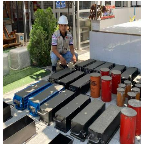
Figura N°28: Probetas, incorporación de caucho triturado del 1%, 2023.
