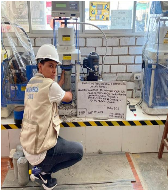
Figura N°45: Ensayo de resistencia a compresión, concreto patrón, 7 días, 2023. Fuente: Elaboración propia
