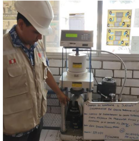
Figura N°102: Ensayo de resistencia a tracción, con incorporación del 9% de caucho triturado, 28 días, 2023. Fuente: Elaboración propia
