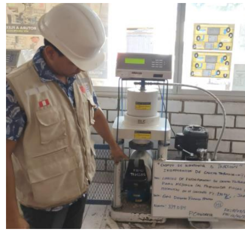
Figura N°98: Ensayo de resistencia a tracción, con incorporación del 9% de caucho triturado, 14 días, 2023. Fuente: Elaboración propia
