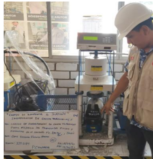
Figura N°86: Ensayo de resistencia a tracción, con incorporación del 6% de caucho triturado, 14 días, 2023. Fuente: Elaboración propia
