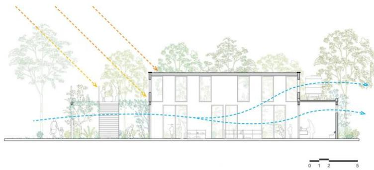
Un dibujo simplificado ilustra el ángulo en el que incide la luz del sol y la dirección por la que entra y sale el viento, creando confort térmico interior. / Fuente: HGAA
