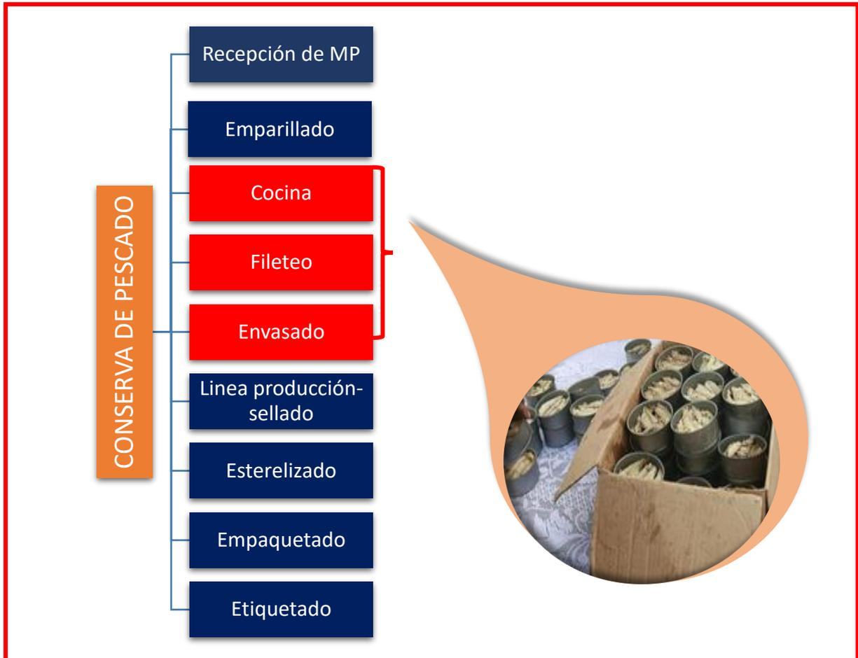
Figura 13. Esquema de los procesos de la elaboración de conserva de pescado
