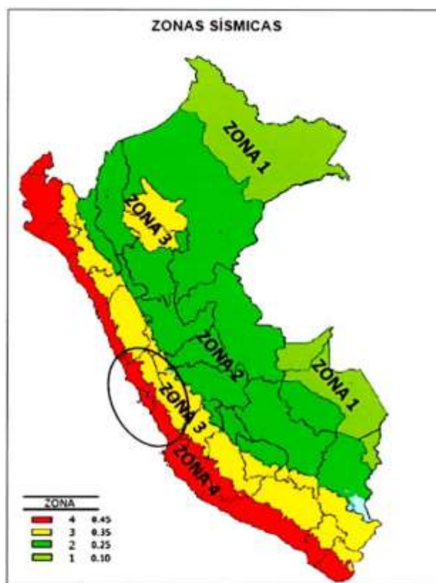
Figura N° 06 Zonas sísmicas del Perú (norma e.030 diseño sismorresistente)
