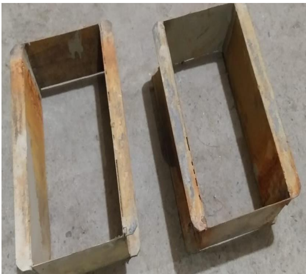
Ilustración 21 Molde de Ladrillos
