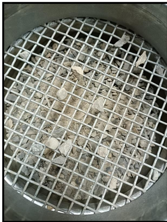
Ilustración 59. Tamizado de agregado
