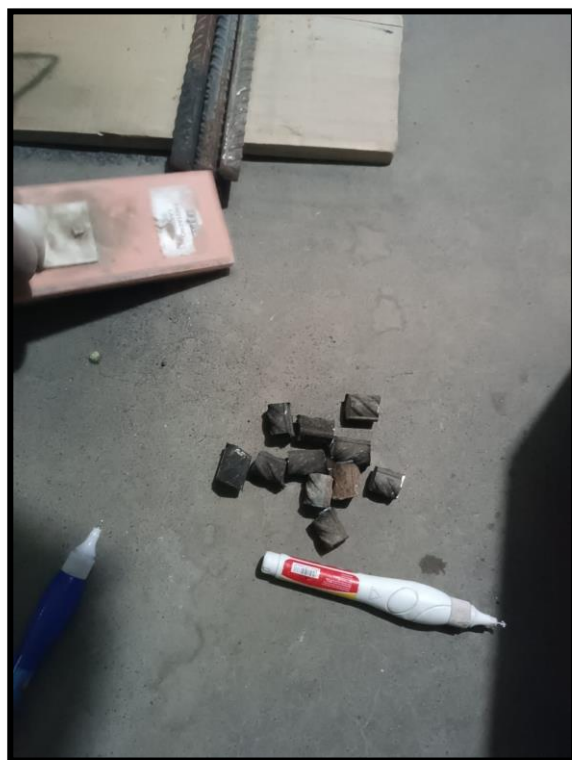
Ilustración 48. Corte de acero
