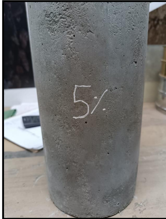
Ilustración 85. Testigo con 5% de partículas de acero
