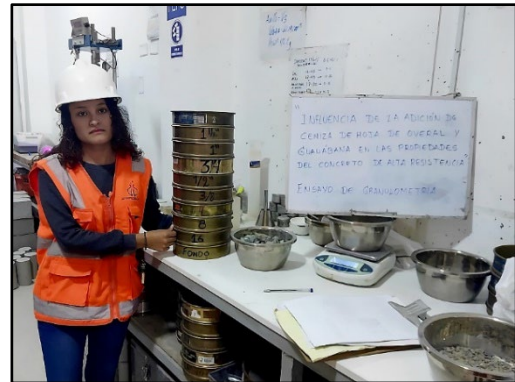
Fotografía 08. Granulometría de los agregados
