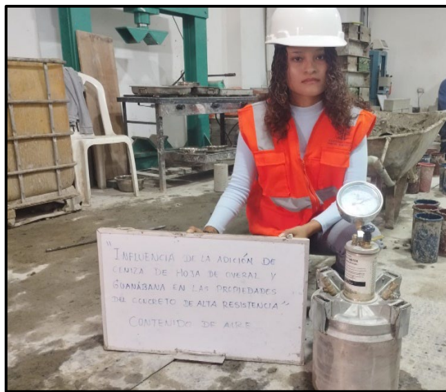
Figura 17. Ensayo de contenido de aire. Fuente: Propia
