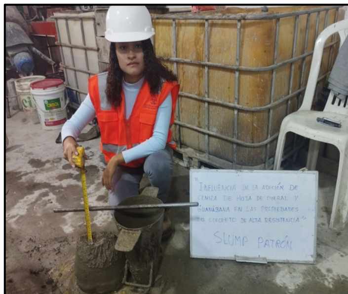
Figura 16. Asentamiento del Concreto patrón Fuente: Propia
