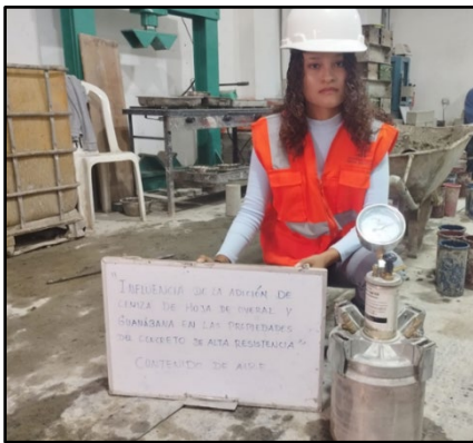
Fotografía 15. Contenido de aire del concreto
