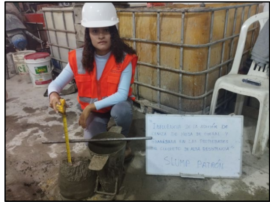
Fotografía 14. Slump del concreto
