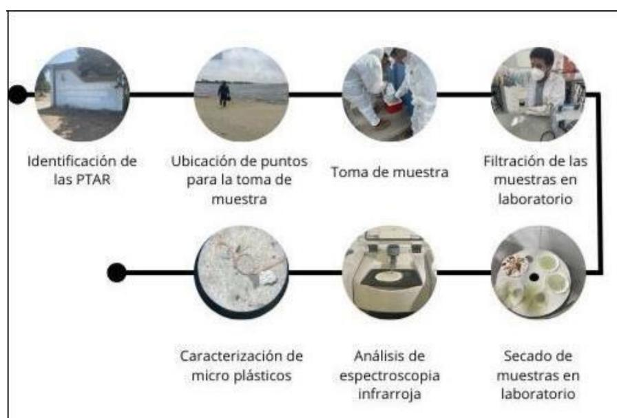
**Figura 3.** Diagrama de Procedimiento.
