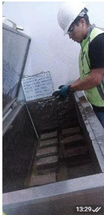
**Fotografía 19.** Curado de adoquines bajo exposición de intemperie. **Fotografía 20.** Curado de adoquines bajo exposición de helada.
