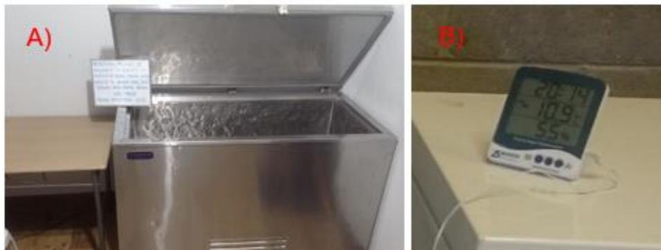
Nota: (a) Equipamiento de la congeladora de capacidad de 439 litros marca HAMFOR, (b) Conexión del termómetro digital marca BOECO con un rango de -50°C a +70°C y una precisión de  $\pm 1.0^{\circ}\text{C}$ .
