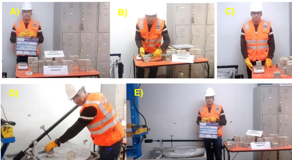
Nota: (a) Muestra de los especímenes para el ensayo de abrasión, (b) Dimensionamiento de los especímenes, (c) Pesado de los especímenes, (d) Colocado de los especímenes para el ensayo de abrasiones y (e) Prueba del ensayo.
