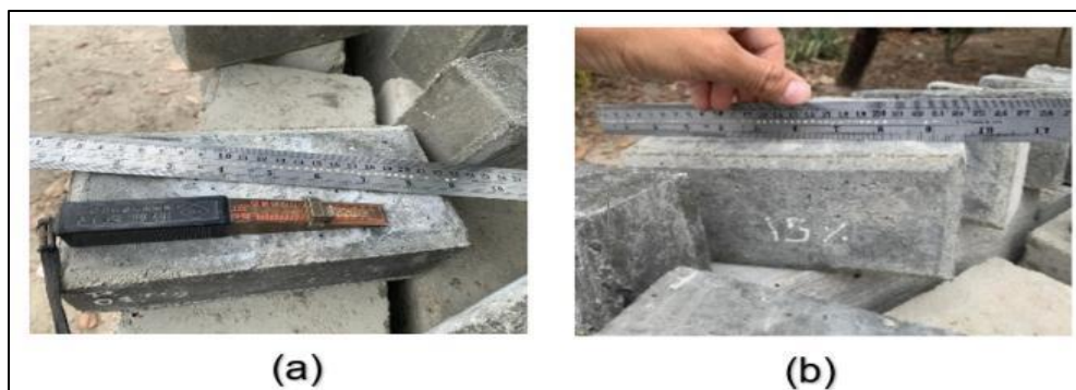
Figura 09: Uso de cuña graduada en milímetros y regla metálica para medir el alabeo en los adoquines estudiados, 2023.
