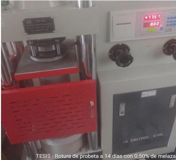
TESIS - Rotura de probeta a 14 días con 0.50% de melaza.
