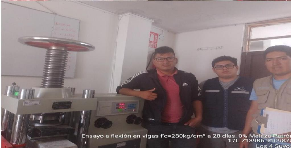
Ensayo a flexión en vigas  $f_c=280\text{kg/cm}^2$  a 28 días, 0% Melaza Patrón
