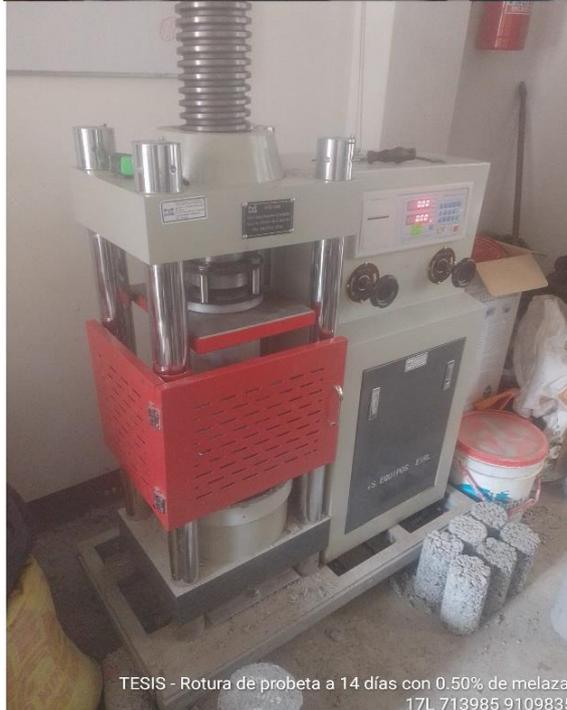
TESIS - Rotura de probeta a 14 días con 0.50% de melaza.
