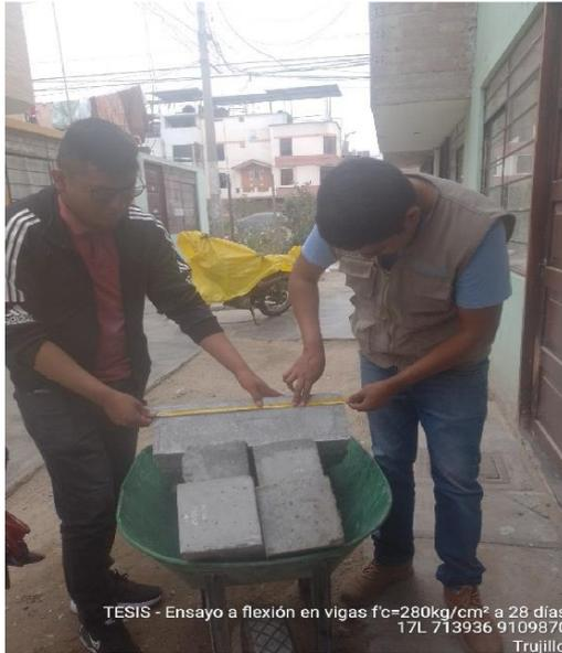
TESIS - Ensayo a flexión en vigas  $f_c=280\text{kg/cm}^2$  a 28 días
