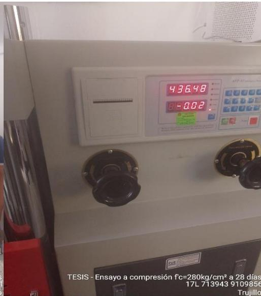
TESIS - Ensayo a compresión  $f_c=280\text{kg/cm}^2$  a 28 días
