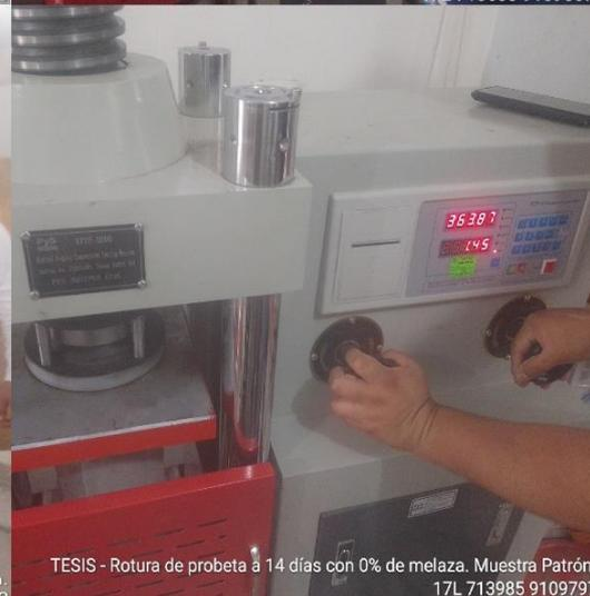
TESIS - Rotura de probeta a 14 días con 0% de melaza. Muestra Patrón.
