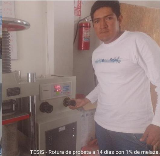
TESIS - Rotura de probeta a 14 días con 1% de melaza.
