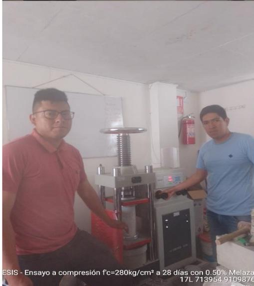
TESIS - Ensayo a compresión  $f_c=280\text{kg/cm}^2$  a 28 días con 0.50% Melaza
