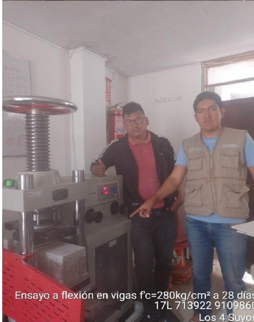
Ensayo a flexión en vigas  $f_c=280\text{kg/cm}^2$  a 28 días
