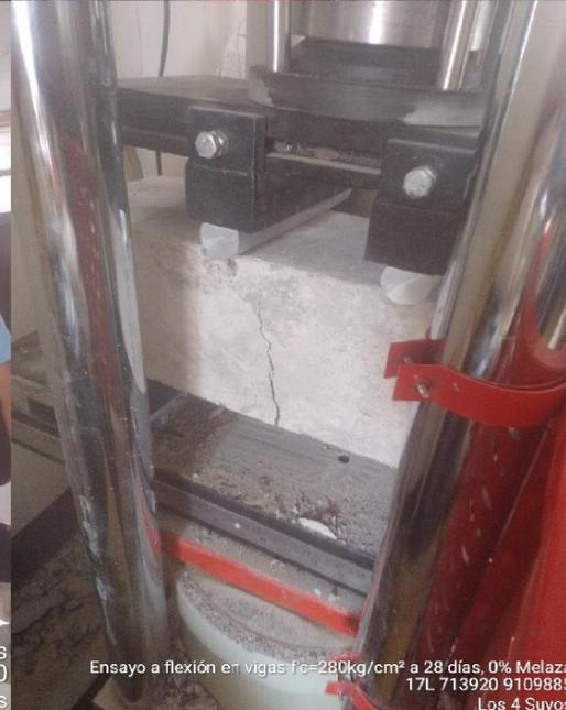
Ensayo a flexión en vigas  $f_c=280\text{kg/cm}^2$  a 28 días, 0% Melaza
