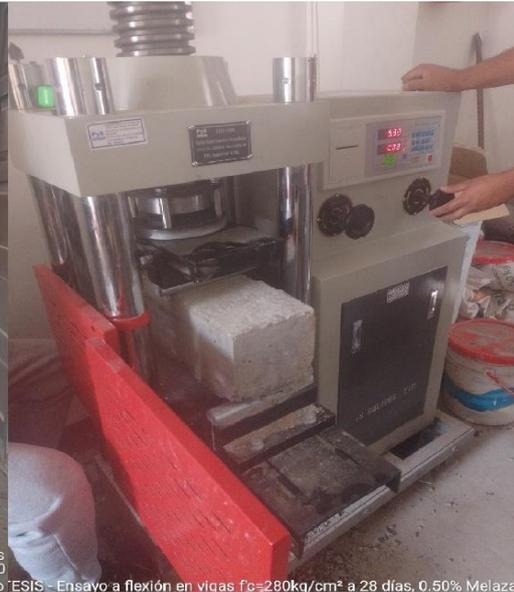
Trujillo TESIS - Ensayo a flexión en vigas  $f_c=280\text{kg/cm}^2$  a 28 días, 0.50% Melaza
