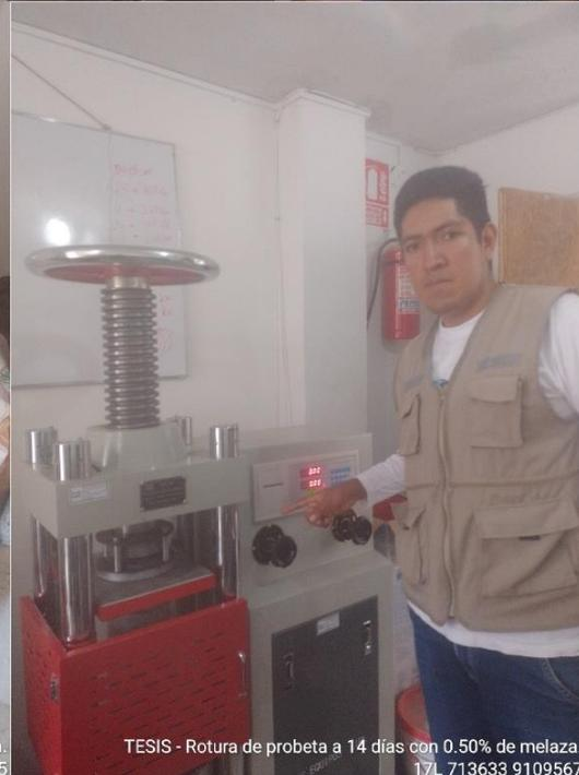
TESIS - Rotura de probeta a 14 días con 0.50% de melaza.
