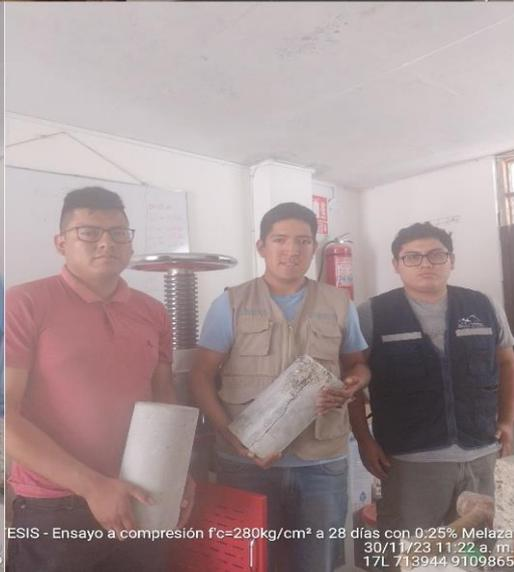
TESIS - Ensayo a compresión  $f_c=280\text{kg/cm}^2$  a 28 días con 0.25% Melaza
