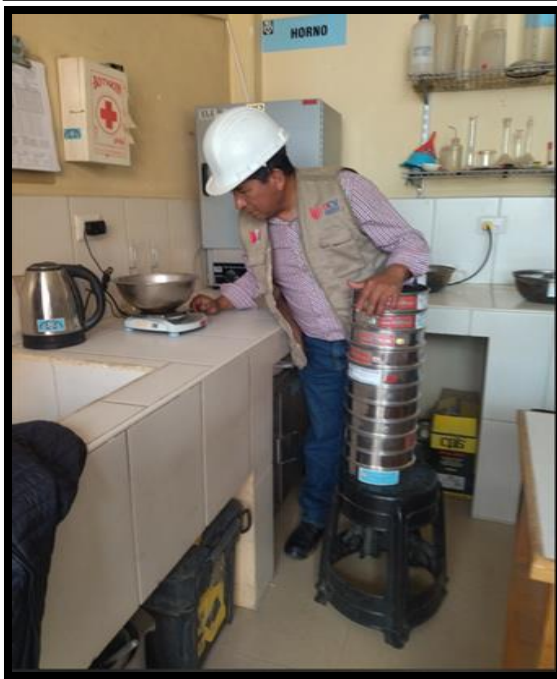
Imagen N 11: Se observa trabajo de pesada muestra seca
