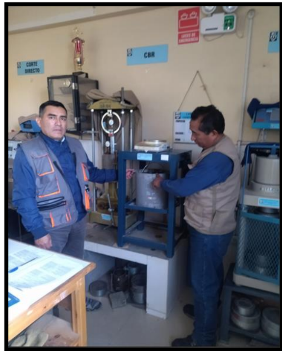
Imagen N 8: Se observa trabajo de determinación de CBR
