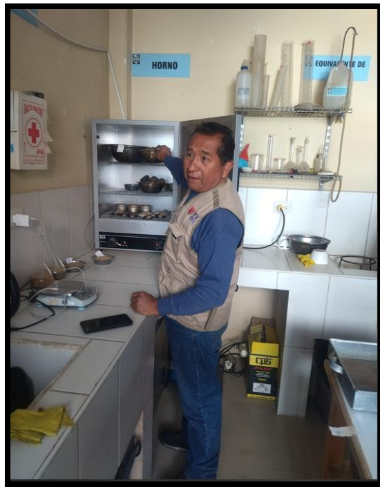
Imagen N 10: Se observa trabajo de secado de muestra
