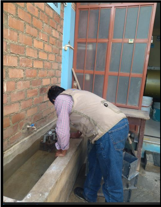
Imagen N 9: Se observa trabajo de saturación de la muestra
